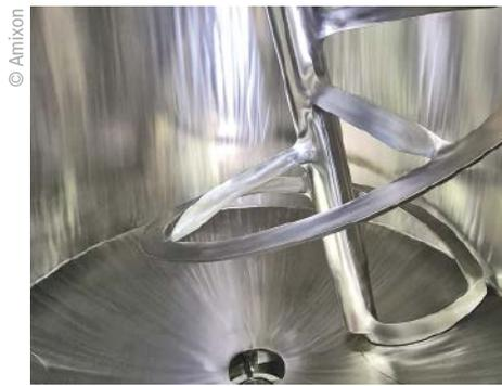
■ Abb. 3: Mischraum und Mischwerk des Gyration Mischers.
