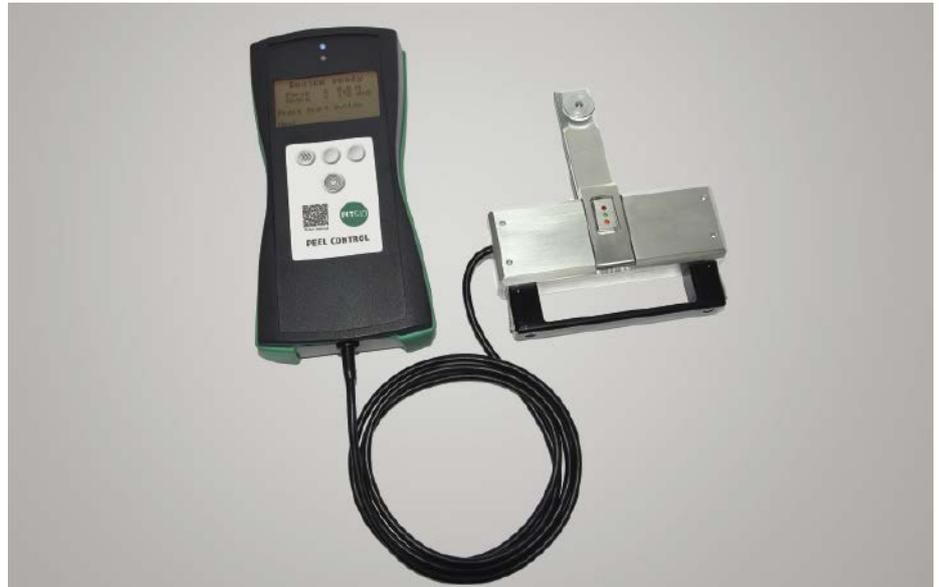
■ Abb. 1: Das Trennkraft-Messgerät Peel Control.
