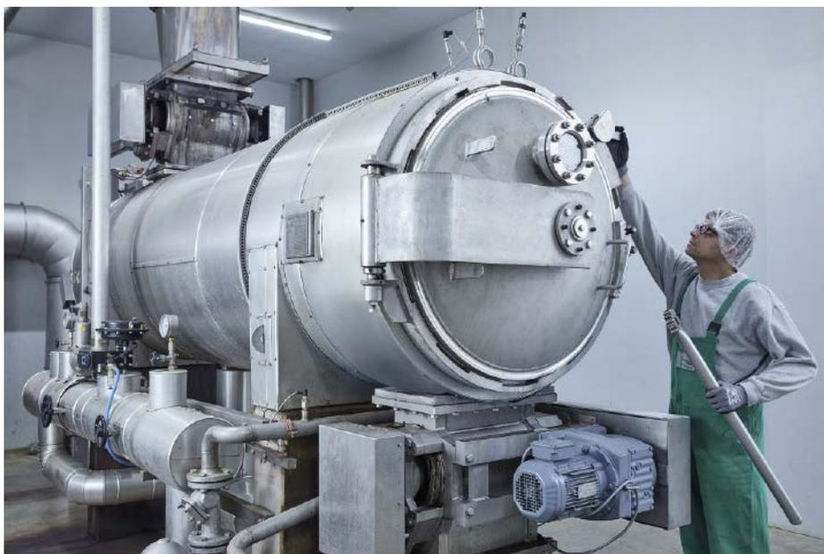
■ **Abb. 2:** Die Keimreduzierung durch natürliche Dampfbehandlung sorgt für die geforderte Lebensmittelsicherheit der Produkte.
