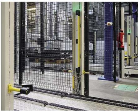
■ **Abb. 5:** Die finalen Verkaufseinheiten werden aufpalettiert und zum Versandbereich transportiert. Hier sichern Leuze Mehrstrahl-Sicherheits-Lichtschranken des Typs MLD 500 die Übergabestation gegen unerwünschten Zutritt von Personen.
