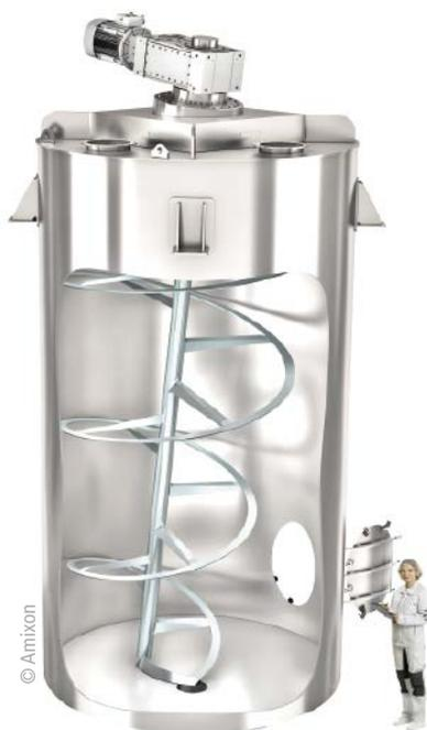
■ Abb. 2: Im Gyraton-Mischer führt die Mischwerkswelle neben der Rotation eine Kreisbahn über dem Mischraumboden aus. Das hier gezeigte Gerät kann 70 m<sup>3</sup> Mischgut homogenisieren, entsprechend dem Inhalt eines 40 Fuß Hochseecontainers.
