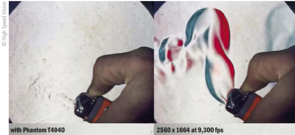
■ Abb. 3: Die 4,2 MP Bildauflösung ermöglicht die Erfassung der Größe und Geschwindigkeit der Aerosol-Tröpfchen und der exakte Ablauf von Zündung und Verhalten der Flamme.
