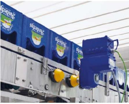
■ **Abb. 2:** Der Antrieb der Förderbänder für den Transport der Bierkästen erfolgt durch die energieeffizienten Antriebseinheiten Movigear performance. Dieses mechatronische System vereint Synchronmotor, Getriebe und Frequenzumrichter als integrierte Einheit in einem kompakten Gehäuse. Es wurde speziell für die horizontale Fördertechnik entwickelt und kommt in zahlreichen Brauereien zum Einsatz.
