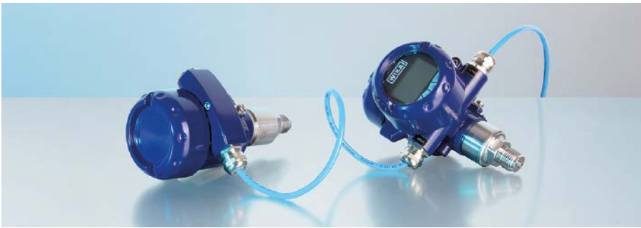
■ Abb. 2: Im Vergleich zu konventionellen Messlösungen zur Füllstandskontrolle minimiert die Differenzdruckmessung mit zwei Prozesstransmittern in einer Primär- und Sekundär-Messanordnung die Temperaturfehler und den Installationsaufwand.
