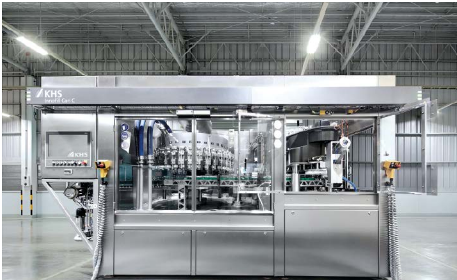
■ Abb. 5: Weiterhin mit kleinem Fußabdruck, jetzt aber mit großer Leistung: Mit dem Innofill Can C können ab sofort bis zu 50.000 Dosen pro Stunde abgefüllt werden.
