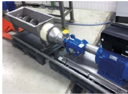
■ Abb. 2: Beim Wangen Variotwin NG-Aggregat ist die Zuführschnecke drehzahlvariabel.
