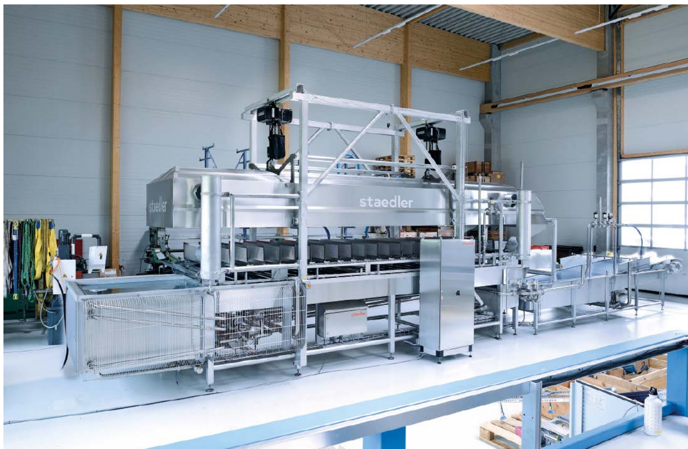
■ Abb. 1: Auf dieser Kochanlage vom Typ Staedler CK1600, gebaut von der Firma Staedler Automation, werden später Spätzle im Wasserbad gekocht.
