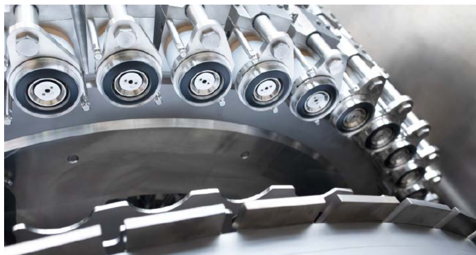
■ Abb. 4: Noch hygienischer: Elektropneumatisch betätigte Tulpen zur Abdichtung der Dosen mit PTFE-Faltenbalg. PTFE steht dabei für Polytetrafluorethylen (Teflon).
