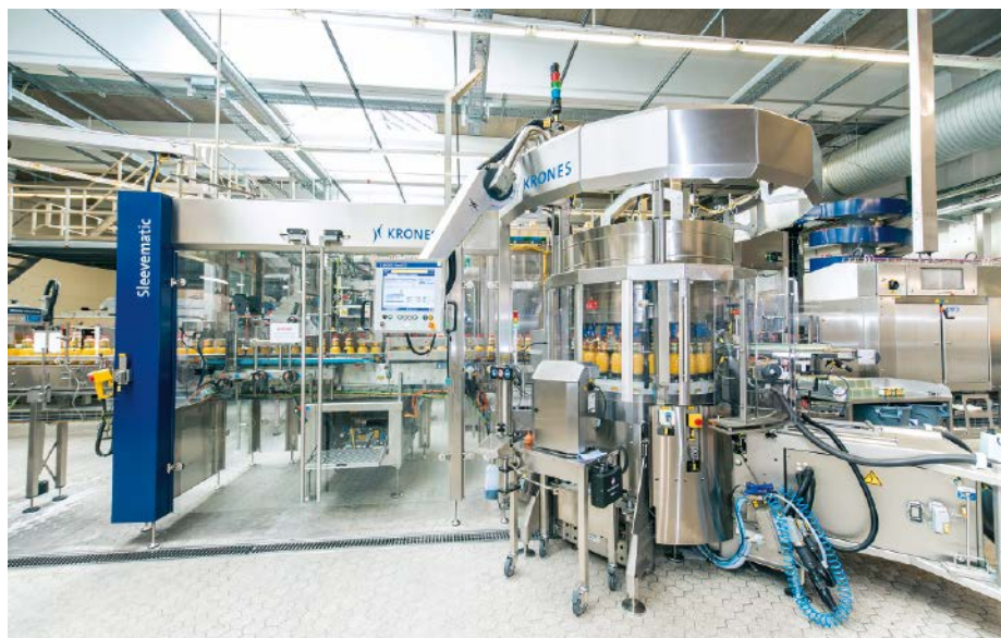
■ Abb. 3: In der Anlage ist eine Modul-Etikettiermaschine Star modul geblockt mit einer Sleeve-Etikettiermaschine Sleeveomatic. So ist eine Ausstattung mit Rundum- bzw. Selbstklebe-Etiketten oder alternativ Sleeve-Etiketten möglich.
