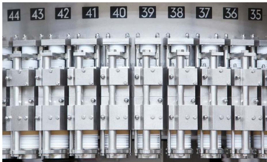
■ Abb. 3: Die wichtigste Neuerung und ein Gewinn für die Hygiene ist die pneumatische Absenkvorrichtung für die Zentriertulpen – sowohl beim Innofill Can DVD als auch beim Innofill Can C.
