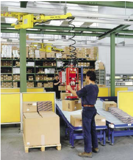
■ Abb. 2: Besonders das auf bis zu 80 kg Last ausgelegte Modell Speedyfil SP wurde für das zügige Umsetzen von Gütern konzipiert und weist eine schlanke Bauweise sowie ein geringes Eigengewicht auf.
