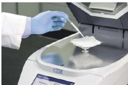
■ Abb. 2: Im Smart 6 wird das Probengut auf ein saugfähiges Probenträgermaterial gegeben und auf die integrierte Waage gelegt.
