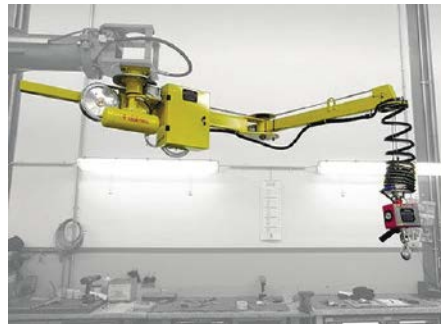
■ Abb. 3: Der Handhabungs-Manipulator nutzt einen doppelten und für die 360°-Drehung ausgelegten Knickarm, der über zwei unabhängige Stahlseile mit verschiedenen Aufnahmeverrichtungen verbunden wird und das „schwerelose“ Bewegen der Lasten sichert.
