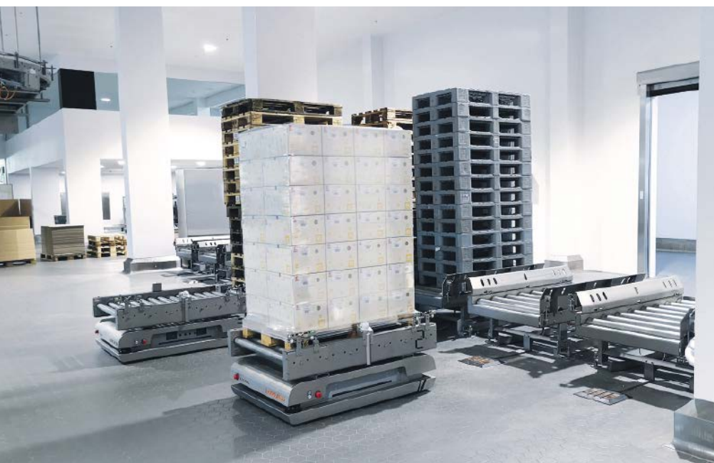
■ Abb. 1: Den Weitertransport der verpackten Käsevariationen ins Lager oder zum Verladen übernehmen sechs Fahrerlose Transportsysteme der TTS Serie.
