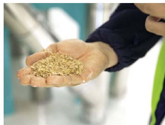
■ Abb. 3: Bei jedem Mahl- und Sieb-Vorgang entstehen Kornteilchen unterschiedlicher Größe und Qualität. Daraus entstehen die verschiedensten Endprodukte: Schrot, Grieß, Dunst und Mehl, sortiert nach Qualität, Typ und erhältlich mit Bio- oder selbst Koscher-Zertifikat.
