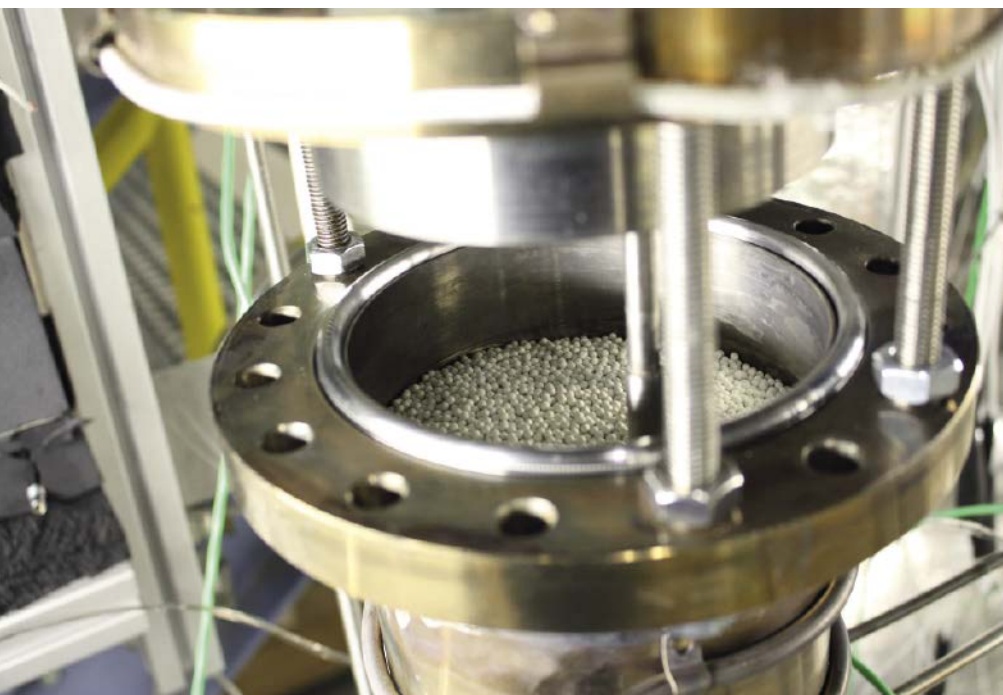
■ Abb. 2: Vorversuch für elektrothermische Speicher: Ein Speicher mit Schüttgut und Flüssigmetall als Wärmeträgerfluid.
