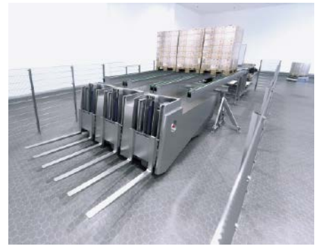
■ Abb. 3: Das autonom agierende TLS 3600 belädt Lkw und Container raumsparend, gleicht an der Laderampe Höhenunterschiede aus und nimmt Positionskorrekturen vor.
