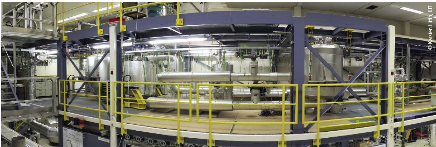
■ Abb. 1: Im Forschungsprojekt LIMELISA am KIT werden Komponenten für thermische Großspeicher in einem Flüssigmetallkreislauf getestet.
