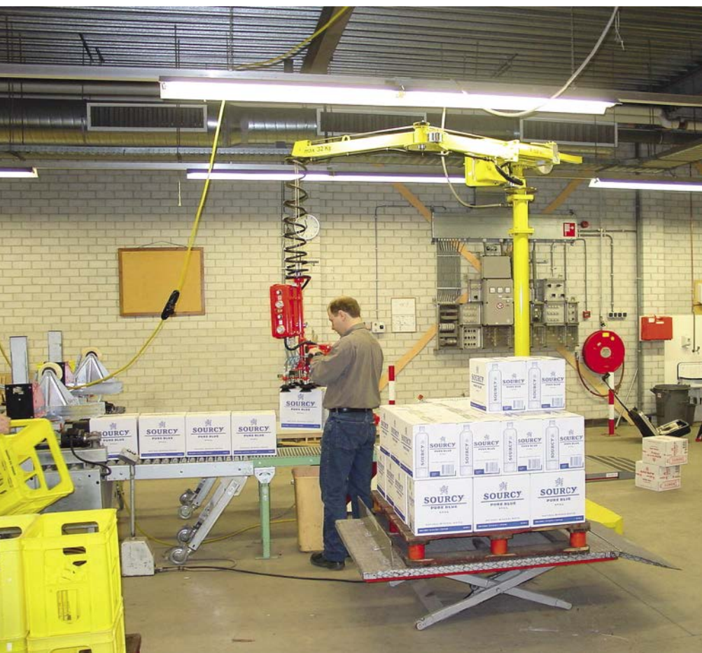
■ Abb. 1: Viele Betriebe der Lebensmittel- und Getränkeindustrie bewegen Lasten mit Kränen, Kettenzügen oder Schlauchhebern. Pneumatisch gesteuerte Manipulatoren von Dalmecc gestalten die Arbeitsschritte schneller, präziser und ergonomischer.
