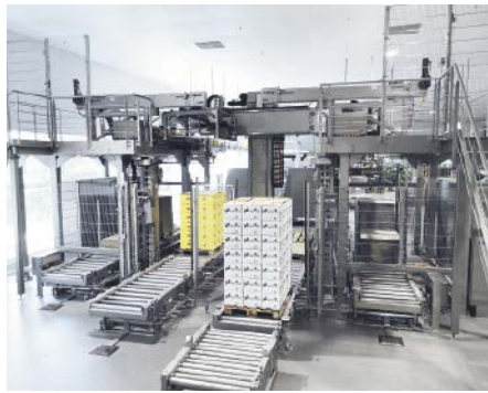
■ Abb. 2: Der Hochleistungs-Lagen-Palettierer aus der HLP Serie bietet hohe Leistung auf engstem Raum. Bei hoher Produktvielfalt auf Kundenseite lassen sich unter Höchstleistung perfekte, saubere Lagen und Stapel bilden.
