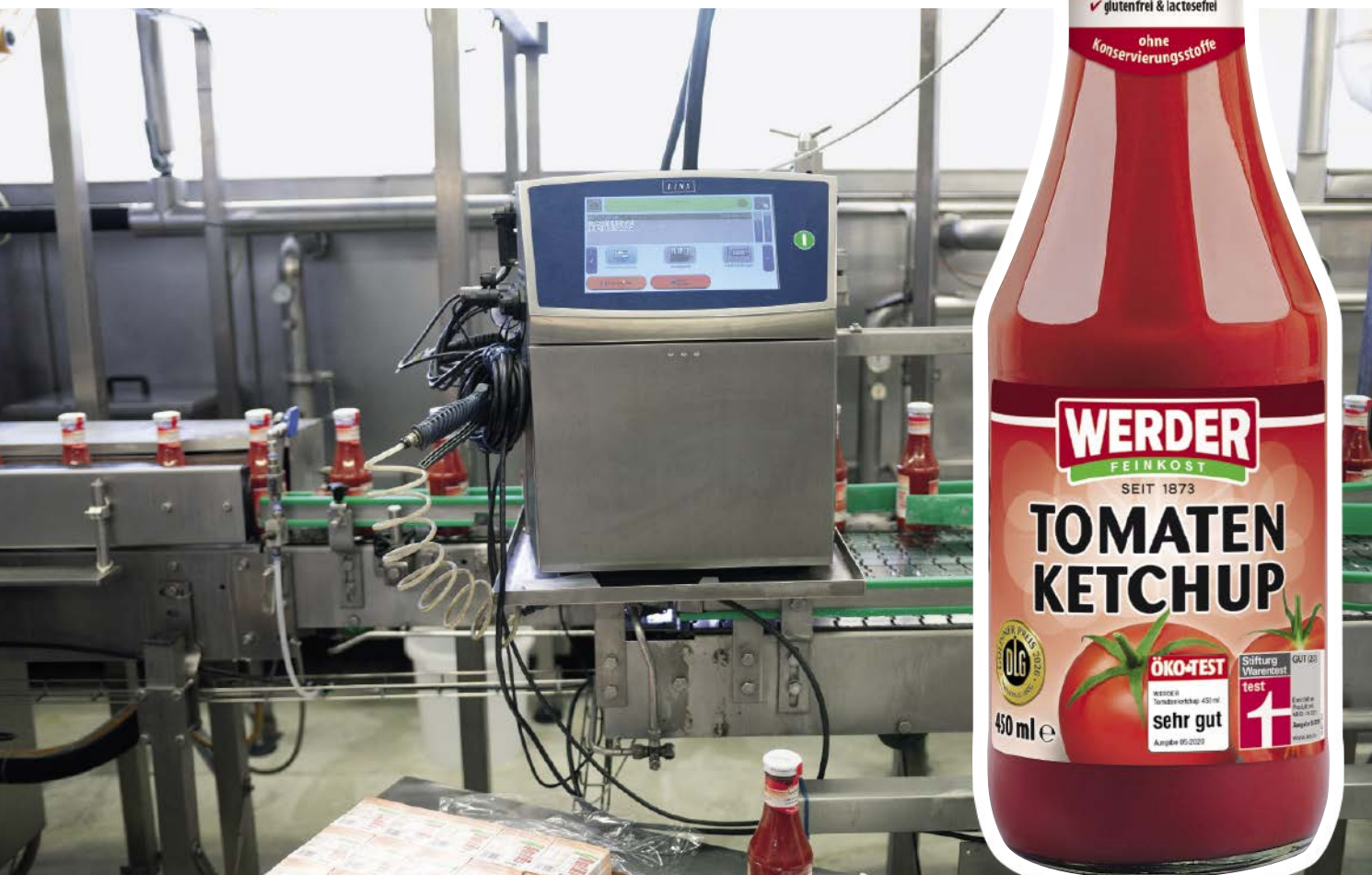
■ Abb. 1: Nach der Abfüllung mit Tomatenketchup werden die Glasflaschen bei Werder Feinkost mit Metalldeckeln verschlossen. Im Anschluss codiert ein Continuous Inkjet-Drucker vom Typ Linx 8920 die Deckel mit Chargeninfos und Mindesthaltbarkeitsdaten.
