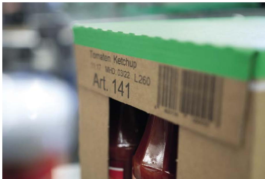
Abb. 3: Die Ketchupflaschen werden in recycelten Umkartons verpackt, auf die Chargennummer, Mindesthaltbarkeitsdaten, Artikelnummer und -bezeichnung sowie ein Barcode aufgebracht werden. Dies übernimmt das Piezo-Inkjetsystem Markoprint Integra PP 108.
