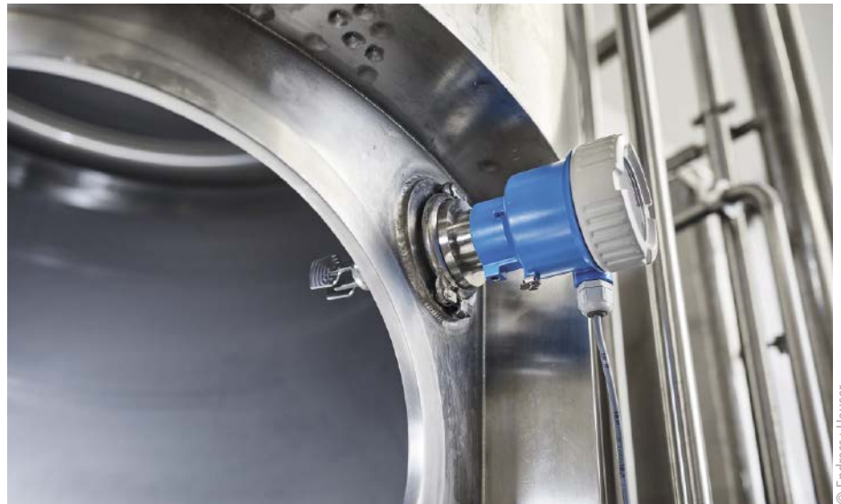
■ Abb. 2: Der QWX43 wurde als Multi-Sensor-System konzipiert, das vier physikalische Größen – Dichte, Viskosität, Schallgeschwindigkeit und Temperatur – gleichzeitig misst.
