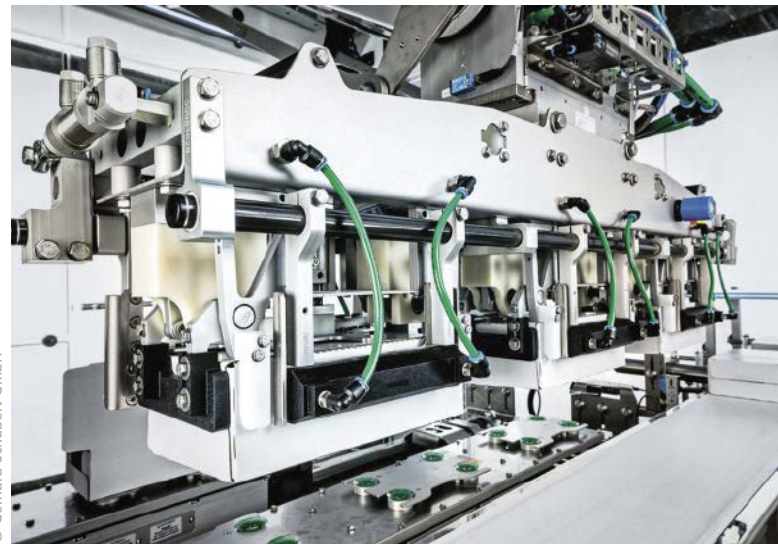
■ Abb. 3: Die hohe Präzision der Verpackungsroboter ermöglicht ein knappes Schachteldesign, das beim Schokoladenhersteller Tören viel Material einspart.
