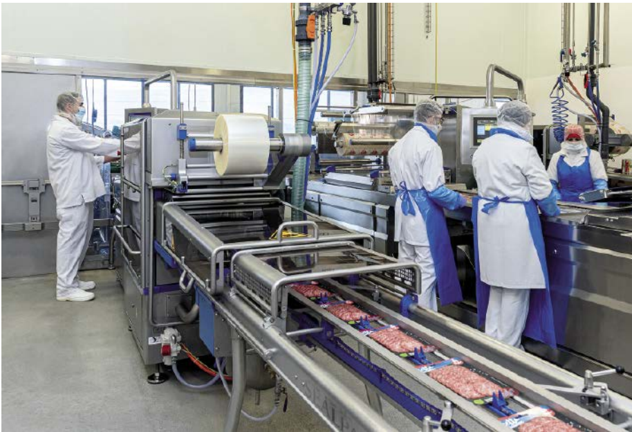
■ Abb. 2: Die Flatmap-Verpackungen werden bei Bigler auf einem Sealpac Traysealer A7 prozesssicher versiegelt.
