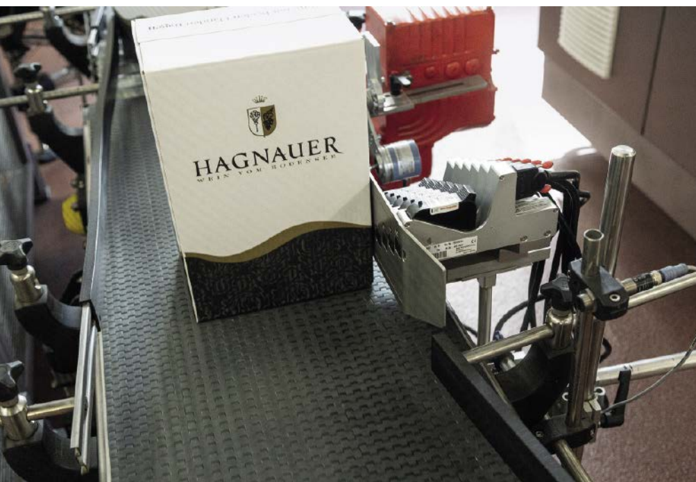
Abb. 1: Der XB8JET der Bluhm-Sparte Markoprint ist ein Drucksystem, das bis zu acht einzelne Tintenkartuschen ansteuern kann. In Hagnau beinhalten die Kartuschen schwarze HP-Tinte und drucken im thermischen Inkjet-Verfahren.
