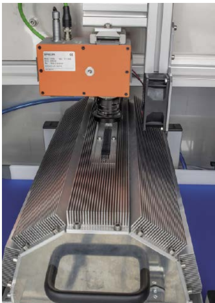
■ Abb. 3: Das Schüttgut wird von einer FX10-Hyperspektralkamera aufgenommen. Das dafür erforderliche breite Wellenlängenspektrum liefert die abgebildete, eigens entwickelte indirekte homogene Halogen-Beleuchtung.
