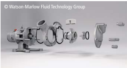
■ Abb. 2: In der Explosivdarstellung der Pumpenkomponenten wird im Zentrum der sinusförmige Rotor erkennbar, dessen Rotation mit dem darüberliegenden Schieber vier gleich große umlaufende Kammern erzeugt.
