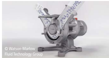
■ Abb. 3: Dank ihres produktschonenden Designs fördert die Sinuspumpe die Hefezellen nicht nur ohne Beschädigung, sondern überzeugt außerdem durch eine besonders hohe Energieeffizienz.
