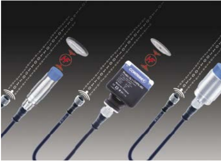
■ Abb. 2: Je nach Schreib-/Lesekopf- und Tag-Durchmesser sind mit zylindrischen Typen bis zu 60 mm Schreib-/Leseabstand möglich, mit C44-Typ bis ~80 mm.
