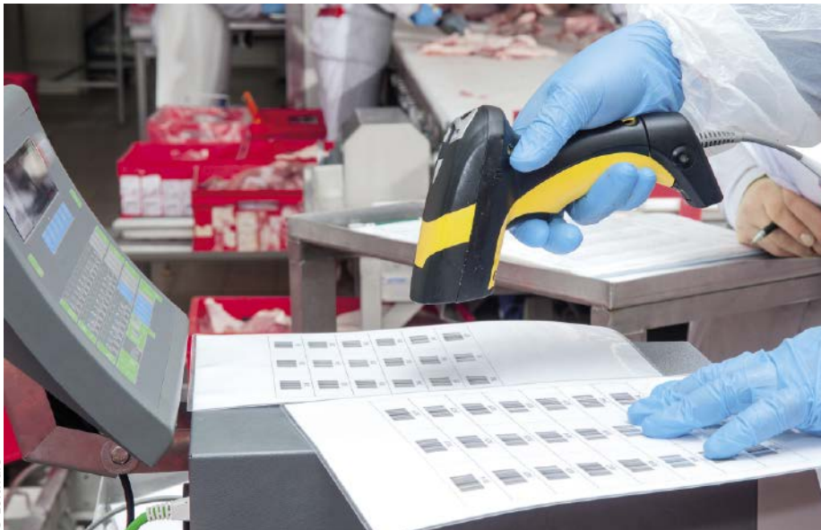
■ Abb. 2: Ein Scan genügt, um ein Produkt zu identifizieren – das Etikettenmanagement wählt dann automatisch die richtige Vorlage aus und holt sich alle notwendigen Daten selbstständig aus ERP-System und MES.
