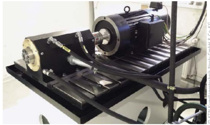
■ Abb. 3: Neben dem gegenüber herkömmlichen Lagerschutzdichtungen wegfallenden Wartungsaufwand liegt ein großer Vorteil der berührungslosen Systeme von Inpro/Seal darin, dass sie nicht heiß laufen.
