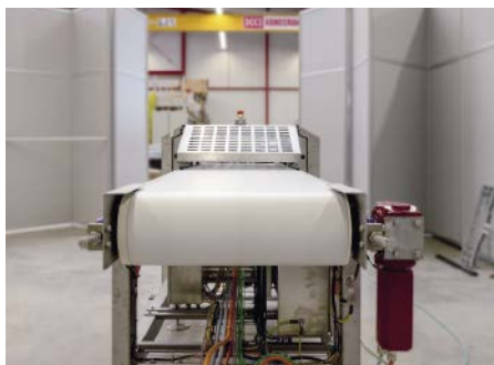
■ Abb. 2: König baut schon die zweite Generation seiner Maultaschenschneider mit Antriebs- und Automatisierungstechnik von SEW-Eurodrive. Über den Schneider laufen bis zu drei Tonnen pro Stunde, je nachdem welches Produkt gefertigt wird.
