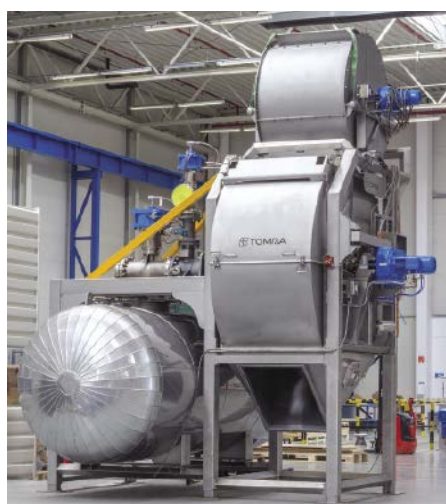
■ Abb. 2: Der Eco-Dampfschäler von Tomra erreicht beispiellose Ergebnisse bei Schälgeschwindigkeit sowie Gleichmäßigkeit der Schalenentfernung bei extrem geringem Schälverlust trotz deutlich gesenktem Dampf- und Energiebedarf.
