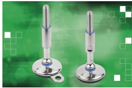
■ Abb. 3: Maschinenfüße im Hygienic Design sind mit einer zweifachen Abdichtung des Gewindeganges und einer Sonderdichtung am Spindelgelenk des Stellfußes ausgerüstet.
