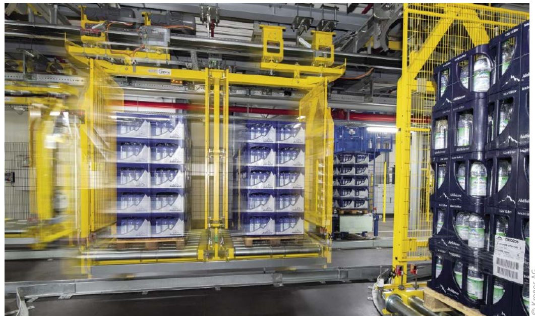
■ Abb. 3: Die Elektrohängebahnen versorgen als Taxi-System das ganze Werk.
