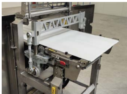
■ Abb. 3: Auch bei 15 m Bandgeschwindigkeit pro Minute muss die Schneidbrücke aufsetzen, vor- und zurückfahren und erneut aufsynchronisieren. Dadurch ist die Relativgeschwindigkeit zwischen der Schneidbrücke und dem Transportband beim Schneiden Null.
