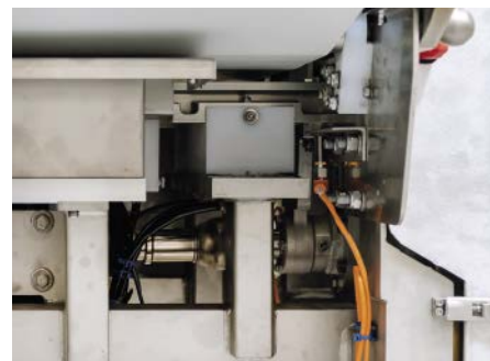
■ Abb. 4: Die Maschine muss sich mit einem Hochdruckreiniger säubern lassen. Daher setzte SEW-Eurodrive einen Linearmotor mit Oberflächenbeschichtung ein. Er ist auf einer Montageplatte mit Kühlkanälen und Thermostat befestigt.
