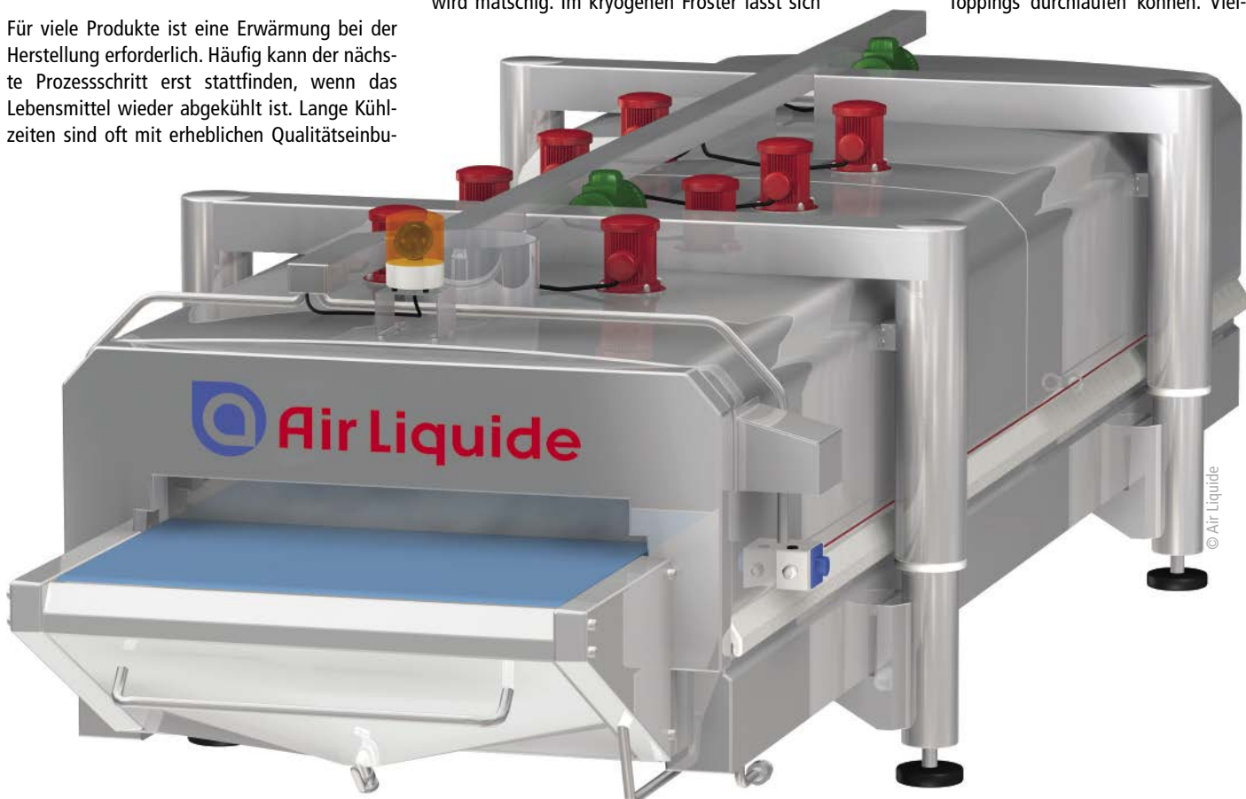
Abb. 1: Mit dem Cryo Tunnel CFP lassen sich zerbrechliche, weiche oder klebrige Produkte durch den Kontakt mit flüssigem Stickstoff härten.
