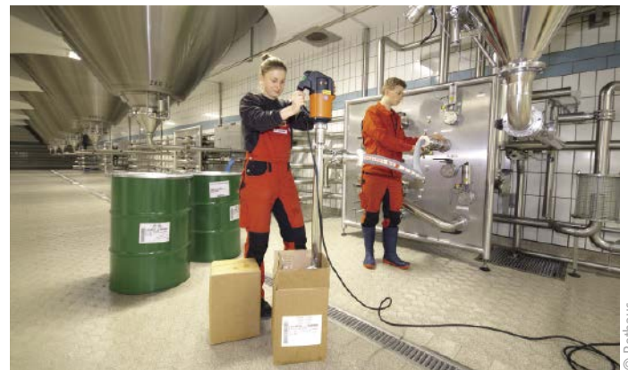
■ Abb. 3: Um das Konzentrat aus dem Fass durch die ca. 10 m hohe Steigleitungen zu fördern, ist ein hoher Druck nötig.
