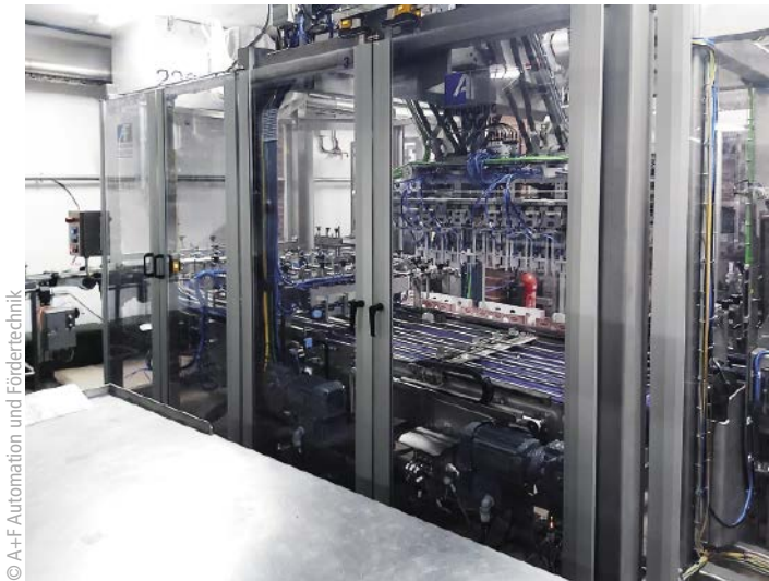
■ Abb. 2: Der Becherpacker basiert auf der bewährten Twin-Line-Grundkonstruktion, die jeweils kundenspezifisch individuell angepasst wird.
