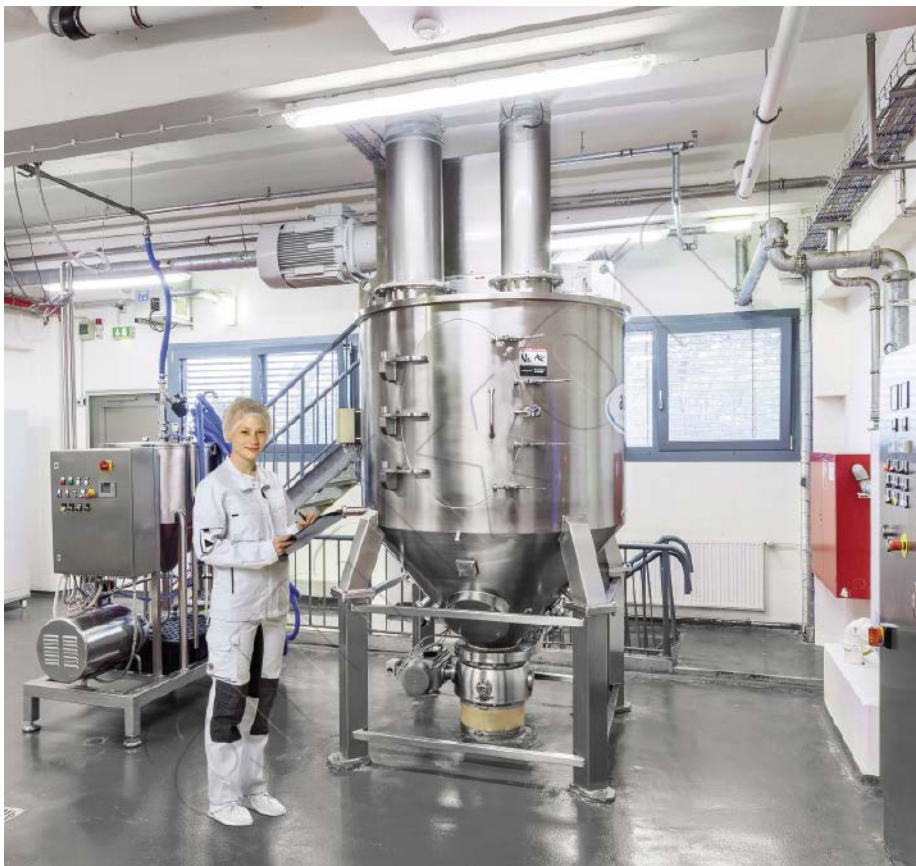
■ Abb. 1: Amixon Konusmischer Typ AM in besonders hygienischer Ausführung.
