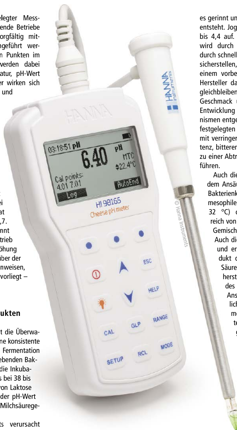
■ Abb.: HI98165, HACCP-konformes pH-Messgerät für Käse.
