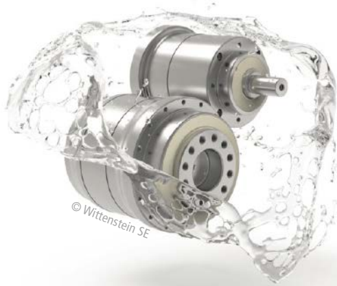
■ Abb. 3: Die glattgewalzte und tottraumfreie Gehäuseoberfläche des HDP+ und des HDV minimiert Anhaftungsmöglichkeiten für Produktreste und erleichtert das rückstandsfreie Abwaschen und Ablaufen von Reinigungs- und Desinfektionsmedien.
