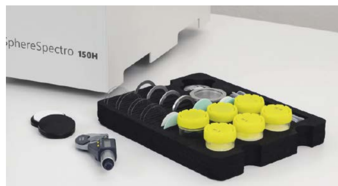
■ Abb. 3: Dieses Bild zeigt Küvetten für flüssige Proben verschiedener Dicke.
