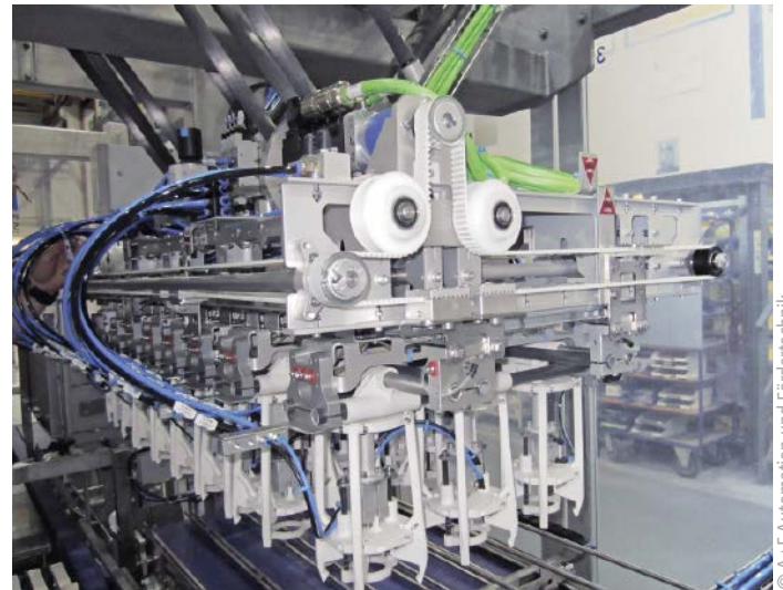
■ Abb. 3: Die Greiferfinger wurden im 3-D-Druck aus Kunststoff hergestellt. Dieses Verfahren bietet im Vergleich zum Ausfräsen der Finger vielerlei Vorteile.
