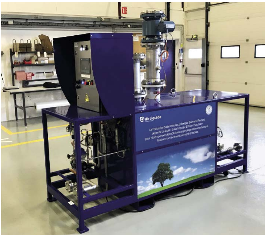
■ Abb. 1: Die Spezialisten des Gasproduzenten Air Liquide entwickelten den Eco Chiller als einen automatisierten Wärmetauscher.
