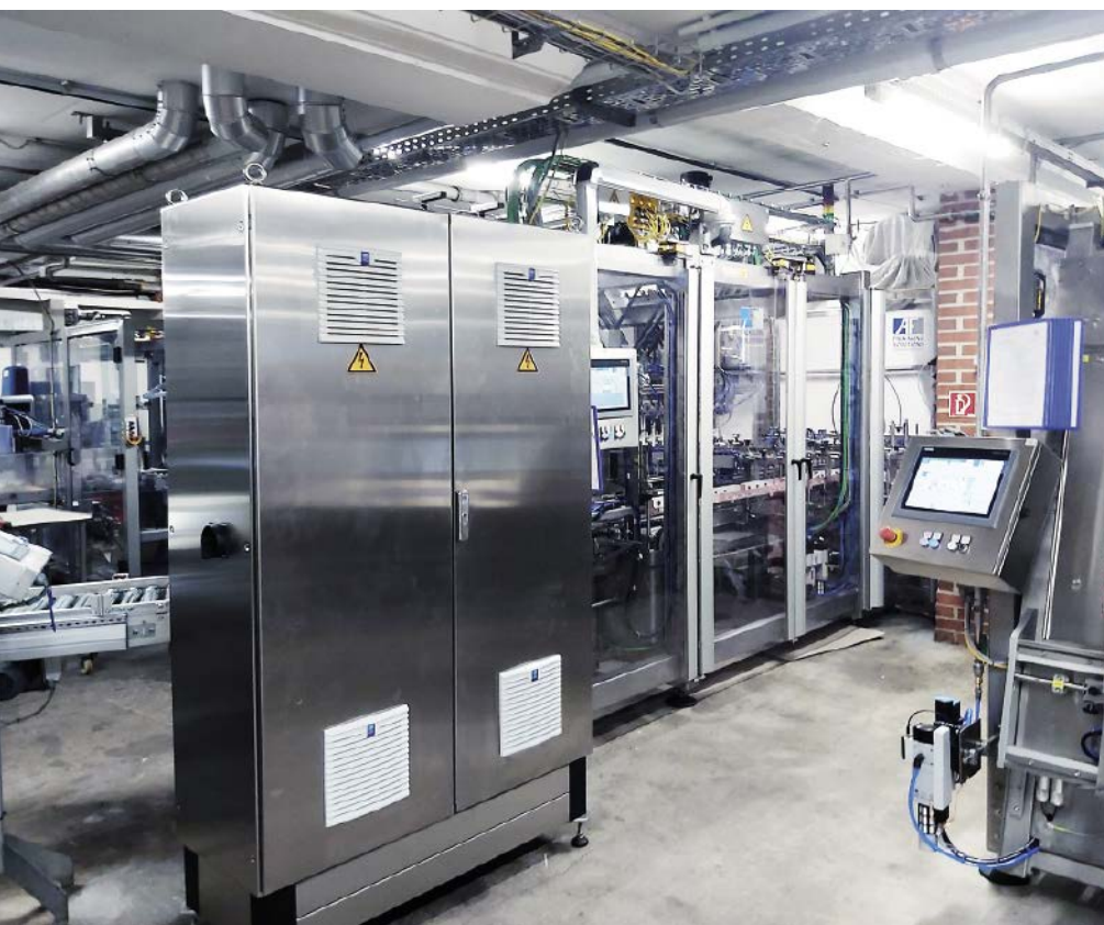
■ Abb. 1: Die neue Packzelle bei Wernsing Feinkost verfügt über eine Nennleistung von 150 Becher pro Minute.
