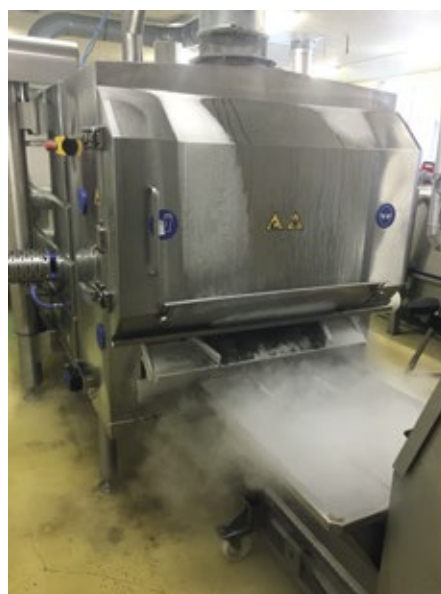
■ Abb. 3: Im Trideck-Froster wird die Kälte dem Produkt möglichst gleichmäßig, direkt und wenn nötig schonend, zugeführt. Dabei wird die Zellstruktur der Lebensmittel nur gering beeinträchtigt.
