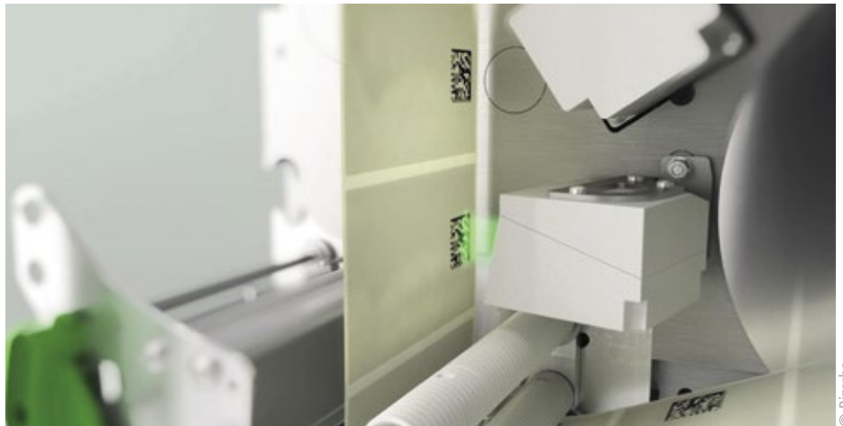
■ Abb. 3: Über das Plug-In Label (codierte Etikettenrolle) kann beim Einlegen der Etikettenrolle eine Etikettenverifikation bzw. eine Maschinenkonfiguration automatisch durchgeführt werden.
