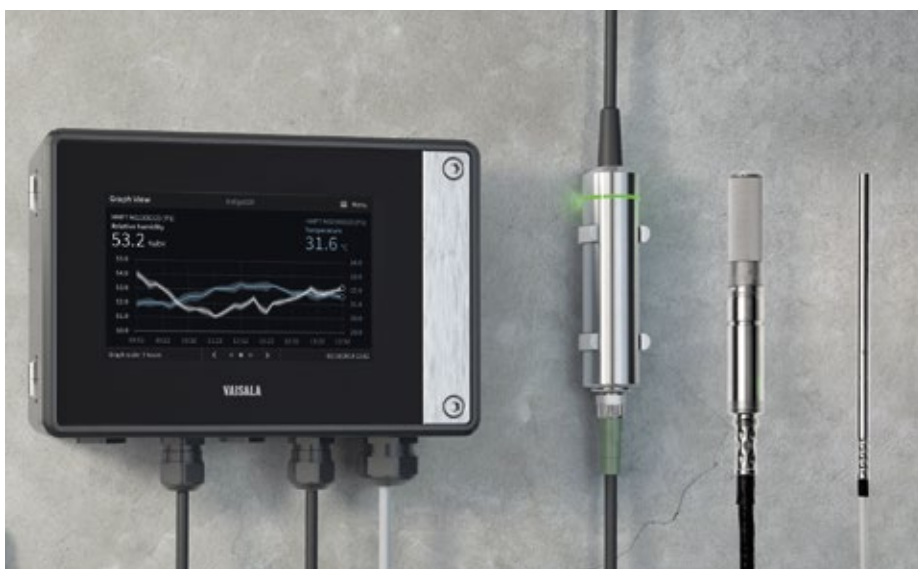
■ Abb. 1: Der Messwertgeber Indigo 520 verfügt über ein robustes Metallgehäuse nach IP66 und NEMA 4 sowie ein Touchscreen-Display aus stoßfestem Glas und ist mit intelligenten Messsonden für Feuchte, Temperatur und viele Parameter kompatibel.
