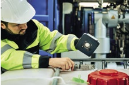
■ Abb. 2: Der Industrial Internet of Things-Sensor vereinigt High-End-Messtechnologie mit digitalen Services in einem kosteneffizienten Gerät zur Füllstandsmessung und ist innerhalb von drei Minuten am IBC installiert.
