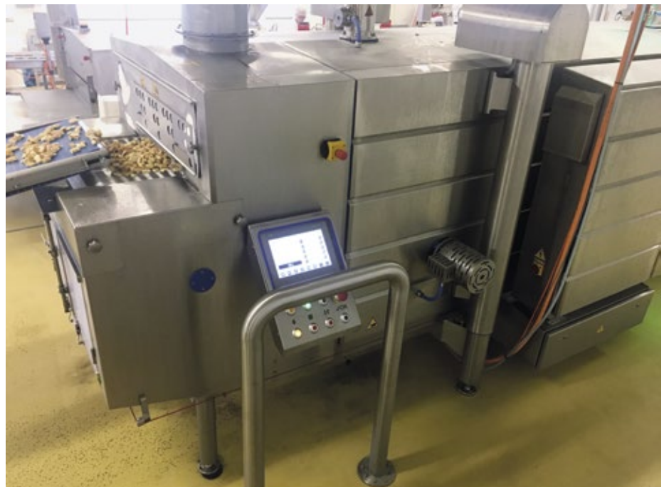
■ Abb. 2: Der Frostprozess auf mehreren Etagen eignet sich für Produkte, die das Herunterfallen von den einzelnen Etagen unbeschadet überstehen. Das ist z. B. bei „IQF“-Produkten gegeben.
