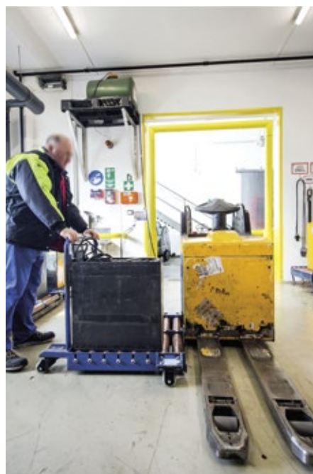
■ Abb. 3: Der Wechsel der Batterien dauert oft nur wenige Minuten. Dann ist der Stapler wieder einsatzbereit.
