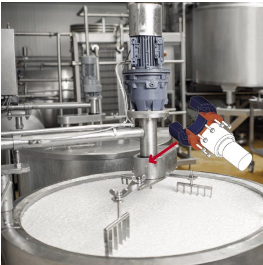
■ Abb. 1: Edelstahl-Schrumpfscheibe HSD eingesetzt im Rührwerk einer Molkerei.
