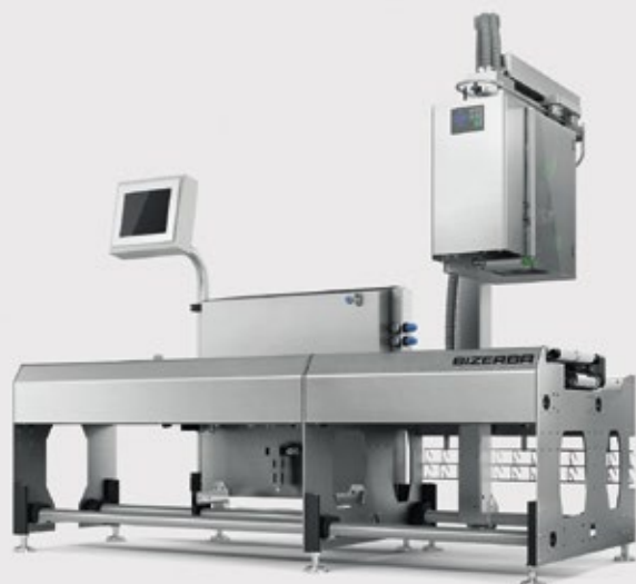
■ Abb. 1: Die intelligente Auszeichnungslinie GLM-levio, die für die automatische Verwiegung und Etikettierung von vorverpackter Ware konzipiert ist, gibt es in verschiedenen Ausführungen.
