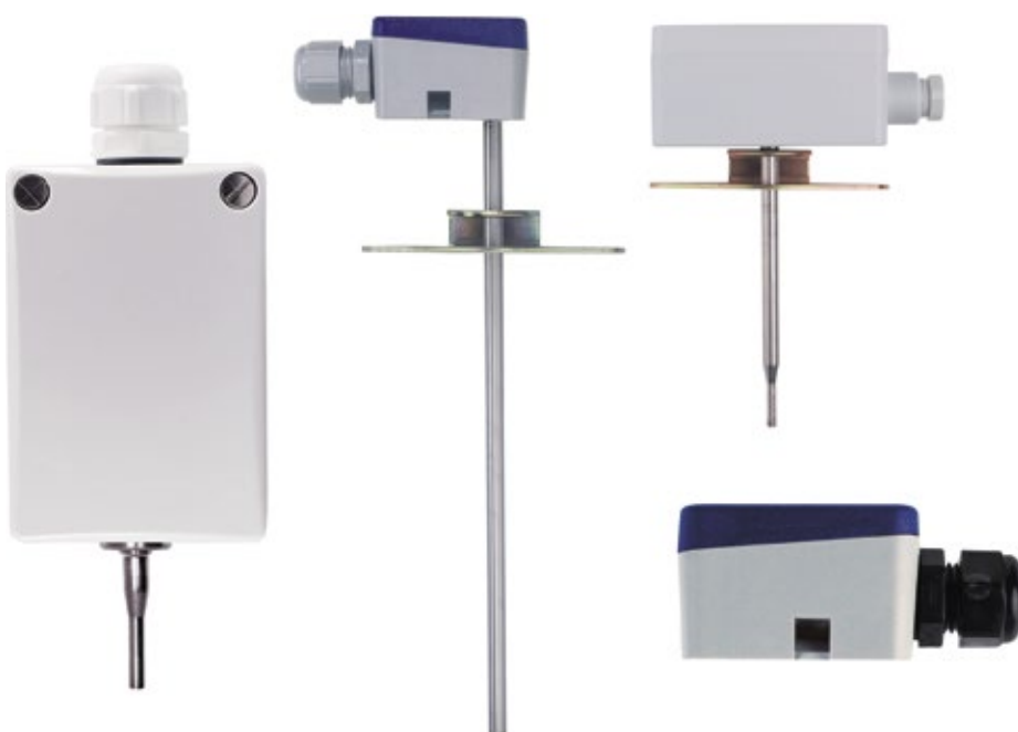
Abb.: Raumtemperatursensoren für Kühlhäuser von Jumo stehen in verschiedenen Ausführungen aus Kunststoff für Temperaturen von -50 bis +90 °C mit Schutzarten von IP20 bis IP65 zur Verfügung.
