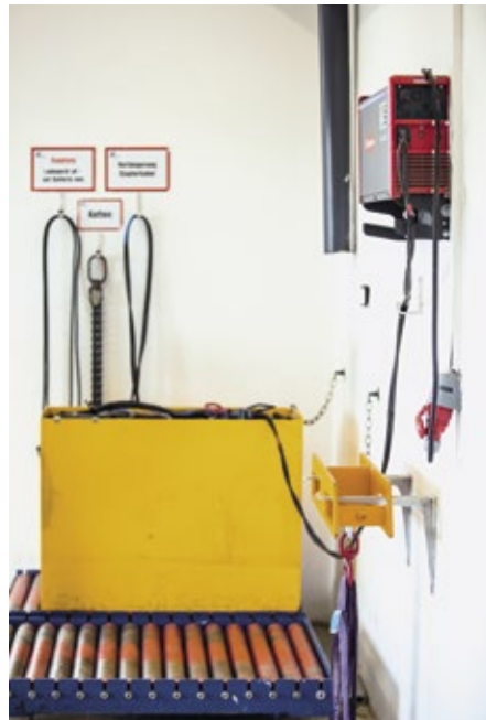
■ Abb. 2: Der schonende Ri-Ladeprozess ermittelt den Zustand jeder Batterie und passt die Ladekennlinie entsprechend an. Das vermeidet eine schädliche Überladung und erhöht die Lebensdauer der Batterie.
