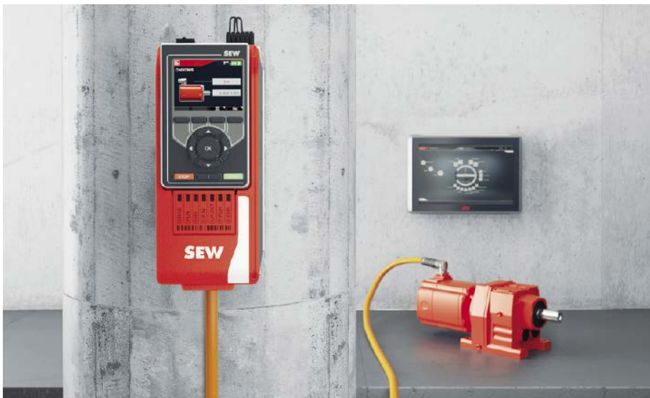
■ Abb. 2: Movitrac advanced ist ein kompakter Standardumrichter aus dem Automatisierungsbaukasten Movi-C mit einem Leistungsbereich von 0,25 kW bis 315 kW und einer Überlastfähigkeit von 150%.
