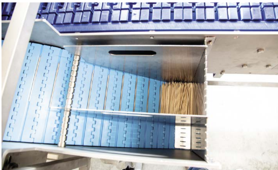
■ Abb. 4: Über ein Schalenförderband werden die Gemüse- oder Fleischstücke zugeführt und die Holzspieße auf einem parallel verlaufenden Band gefördert. Der Förderbandantrieb taktet die Produktschalen präzise in die Spießposition.
