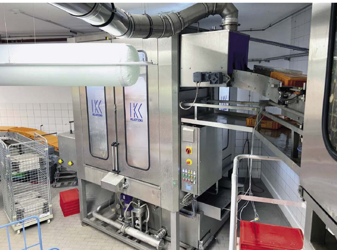
Abb. 1: Ansicht vom Kistenwascher (Auslauf).
