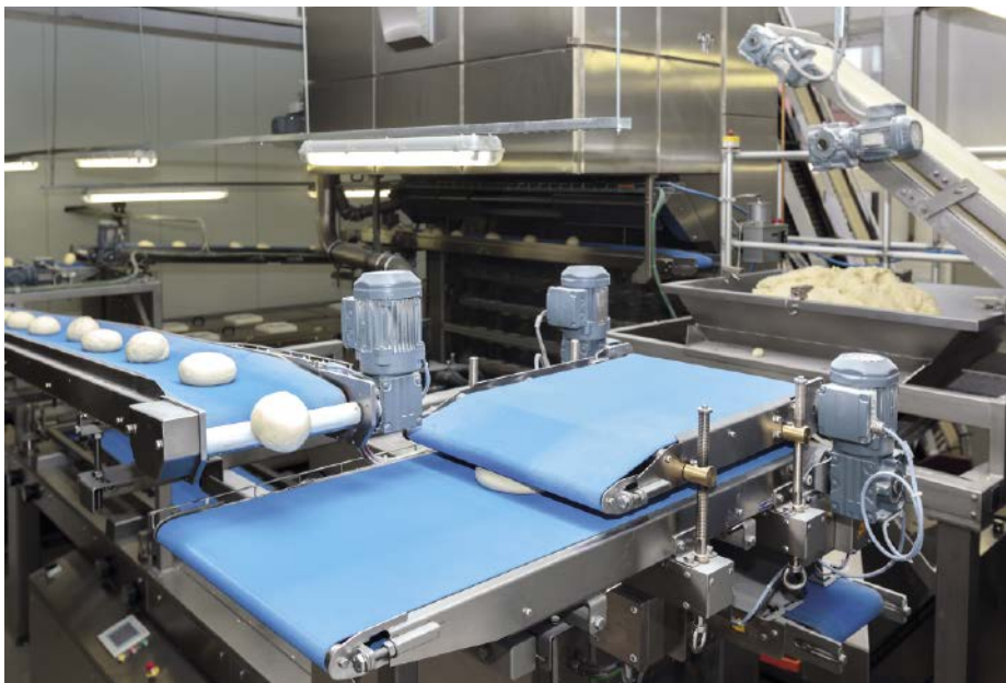
■ Abb. 2: Hoch automatisierte Förder- und Rollbänder in modernen Großbäckereien befördern Rohmaterialien, Teiglinge, Halb- und Fertigbackwaren zwischen den einzelnen Produktionsstufen.
