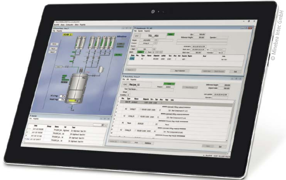
■ Abb. 1: PC-basierte Software zum Überwachen, Bedienen und Steuern rezepturgestützter Produktionsprozesse.
