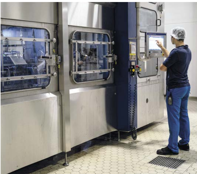
■ Abb. 5: Ein einheitliches Bedienkonzept und ein gemeinsamer Touchscreen für Füller und Verschleißer vereinfachen die Umstellungen.
