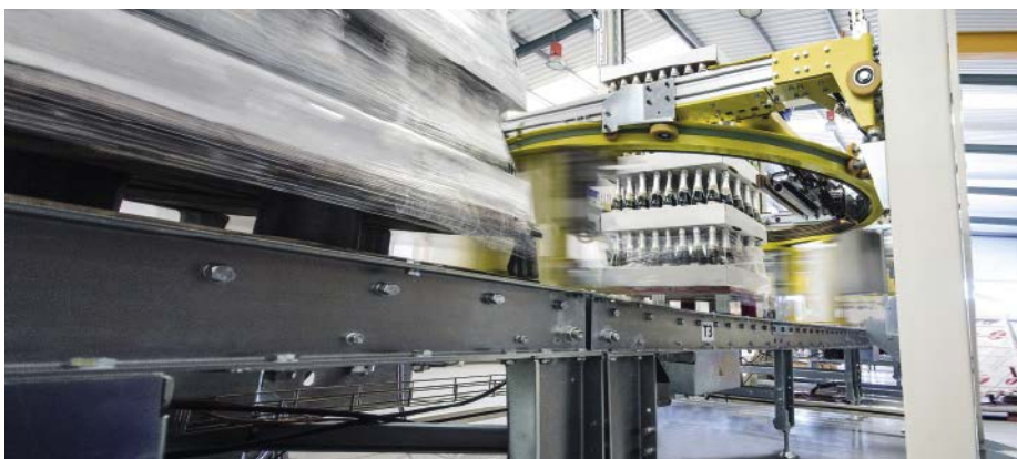
■ Abb. 5: Mit dem Stretchwickler Saturn S6 von Mosca können auch zerbrechliche Flaschen für den Transport zum Supermarkt optimal gesichert werden.
