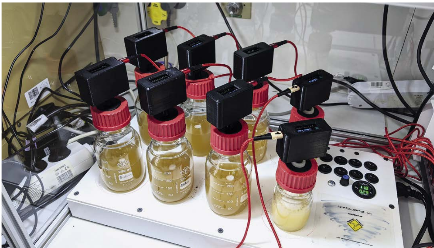
Abb. 1: Sensorarray preiswerter Abgassensoren aus dem 3D-Drucker. Diese ermöglichen auch für Prozesse mit geringen Gewinnspannen, wie z.B. denen in der biotechnologischen Herstellung von Lebensmitteln, parallelisierte Datengewinnung zur Überwachung von Prozessen.
