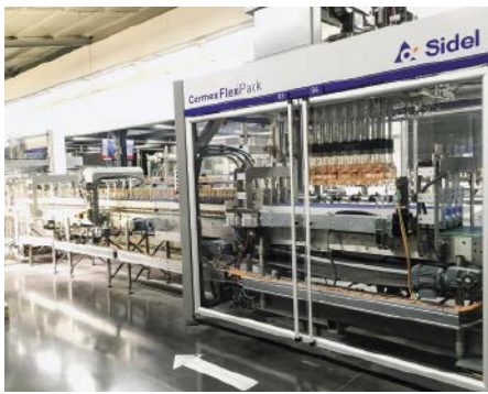
■ Abb. 2: Die Kombination des Pick-&-Place-Kartonpackers Cermex Flexipack mit dem Diviarm Verteiler und dem Palvite Palettierer bietet maximale Flexibilität.
