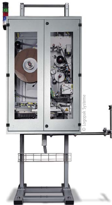
■ Abb. 3: Das Schnur-Etikettiersystem Logomatic 920 PSCK sichert Rothaus-Bierpaletten und appliziert im gleichen Arbeitsgang Etiketten so, dass sie nicht auf dem Kisten selbst haften, sondern an der Sicherungsschnur.
