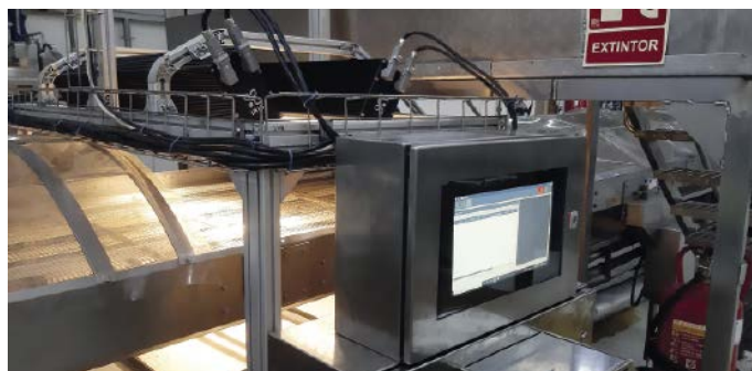
■ Abb. 3: Dank dieses Systems war die Bäckerei in der Lage, den Fettgehalt zu stabilisieren und den Ölverbrauch im Herstellungsprozesses um 1,5 % zu senken.
