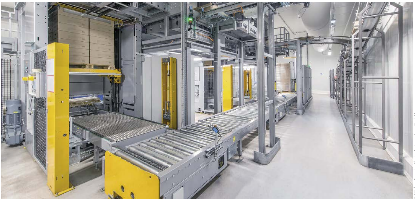
Abb. 1: Vollautomatische Palettieranlage nach der Produktion von tiefgekühlten Backwaren und vor dem automatischen Tiefkühl-Hochregallager.
