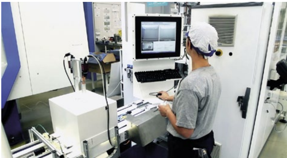
■ Abb. 2: Eine Kamera prüft das Erzeugnis von oben, zwei weitere befinden sich unter dem Förderband. Folglich wird jedes Produkt von drei Kameras untersucht. In dieser Fertigungslinie sind insgesamt sechs Kameras im Einsatz.
