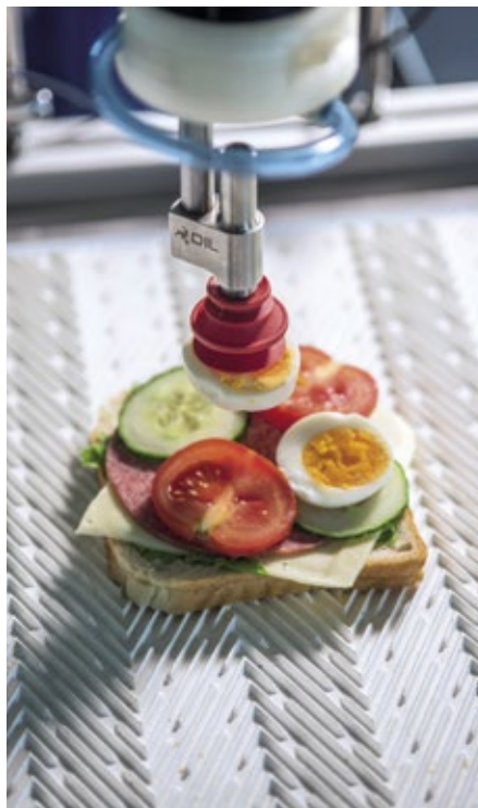
■ Abb. 2: Hygienic Design High Flow (HDHF) Vakuumgreifer mit Ei. Das höchste Gebot in der Lebensmittelindustrie ist die Hygiene. Anders als andere Vakuumgreifer wurde der HDHF Vakuumgreifer nach strikten hygienischen Designstandards entwickelt.
