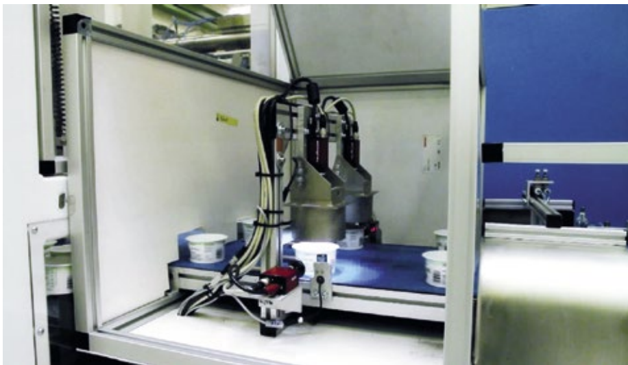
■ Abb. 4: Eine Produktionslinie für runde konische Becher setzt zwei Kameras pro Förderband ein. Eine Kamera untersucht die Behälter von oben auf Dosierungsfehler oder Überspritzungen, die seitlich montierte Kamera prüft die Etikettierung.
