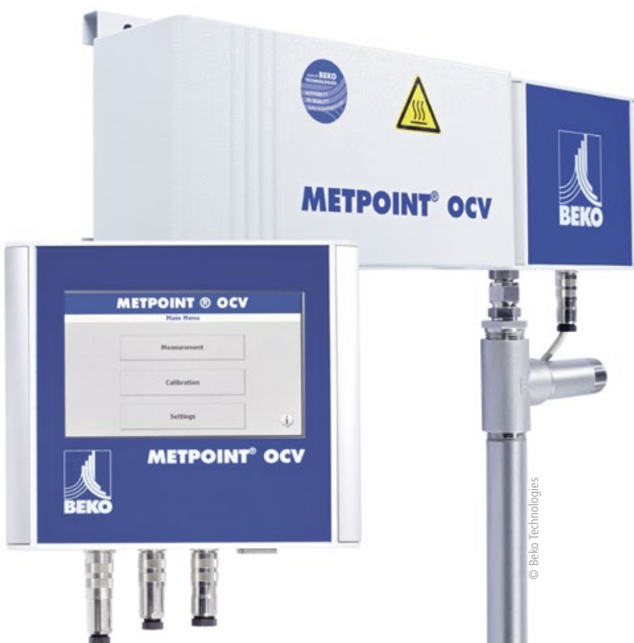
■ Abb. 1: Der Metpoint OCV ist TÜV-zertifiziert und kontrolliert Druckluft-Parameter wie Restöldampfgehalt, Volumenstrom, Druck, relative Feuchte und Taupunkt.
