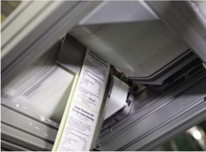
■ Abb. 2: Ein unterhalb der Förderlinie montierter Etikettierer schiebt das Etikett durch einen Spalt im Förderband nach oben, sodass es an der Unterseite des vorbeiziehenden Produktes haften bleibt.
