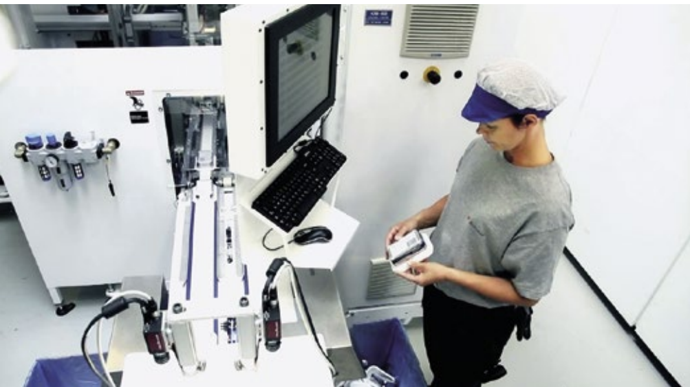
■ Abb. 1: Diese Produktionslinie (Spritzgießmaschine und Roboter) speist die Produkte auf zwei Förderbändern in jeden Zyklus ein. Jedes Förderband ist mit drei Kameras ausgestattet, die verschiedene Stellen des Produkts inspizieren.
