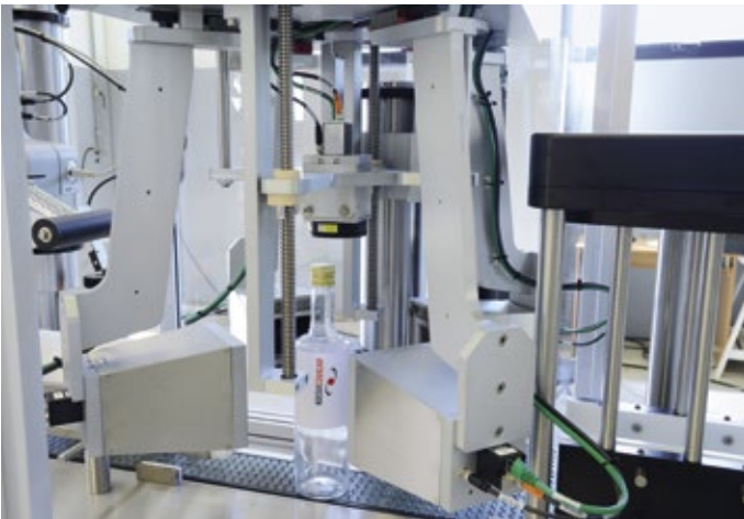
■ Abb. 2: Die BTT ermöglicht eine Flaschentrennung und eine serialisierte Bedruckung. Zudem erfasst die BTT wichtige Überwachungsdaten für staatliche Behörden. Sie kann in bestehende Anlagen integriert oder als Stand-Alone-Lösung eingesetzt werden.
