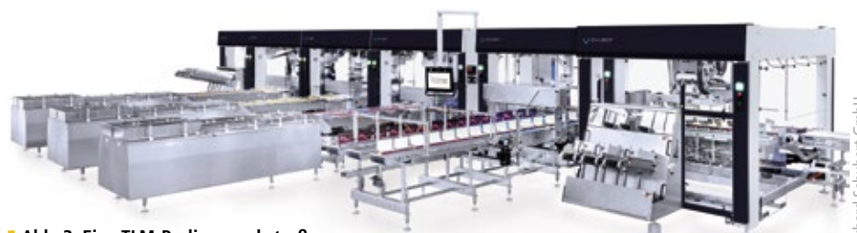
■ Abb. 3: Eine TLM-Pralinenpackstraße aus sechs Teilmaschinen automatisiert bei Mieszko den Verpackungsprozess.
