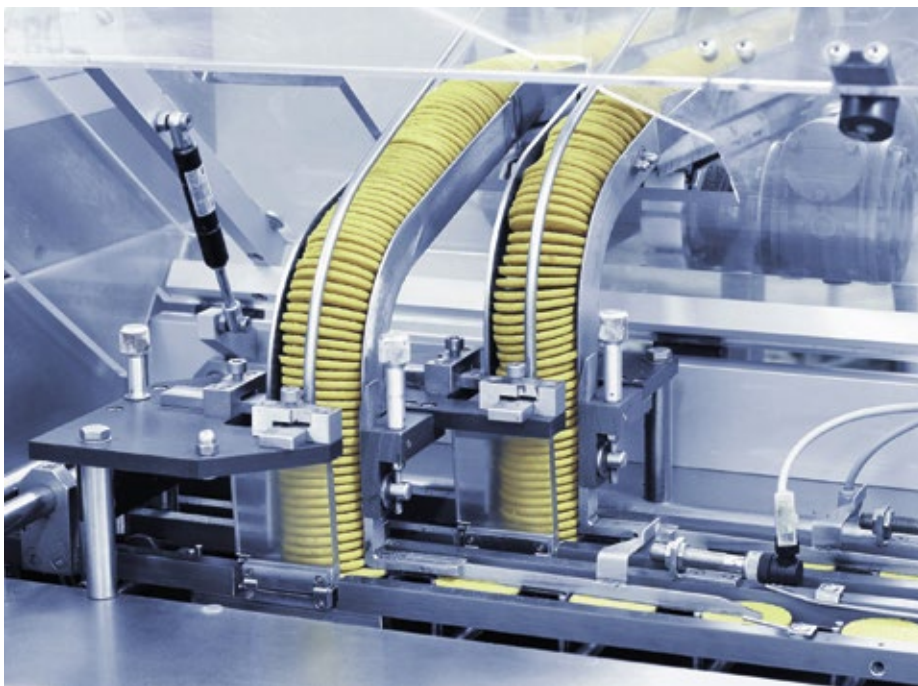
■ Abb. 1: Maschinen mit hoher Taktzahl erschweren die zuverlässige Fremdkörperdetektion. Bei Kunststoffen verbessern detektierbare Compounds die Entdeckungswahrscheinlichkeit.
