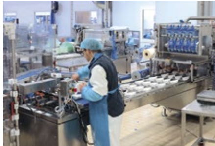
■ Abb. 3: Eine von 25 Traysealer-Verpackungsmaschinen, auf denen Gorgonzolaportionen unter Schutzgas verpackt werden.
