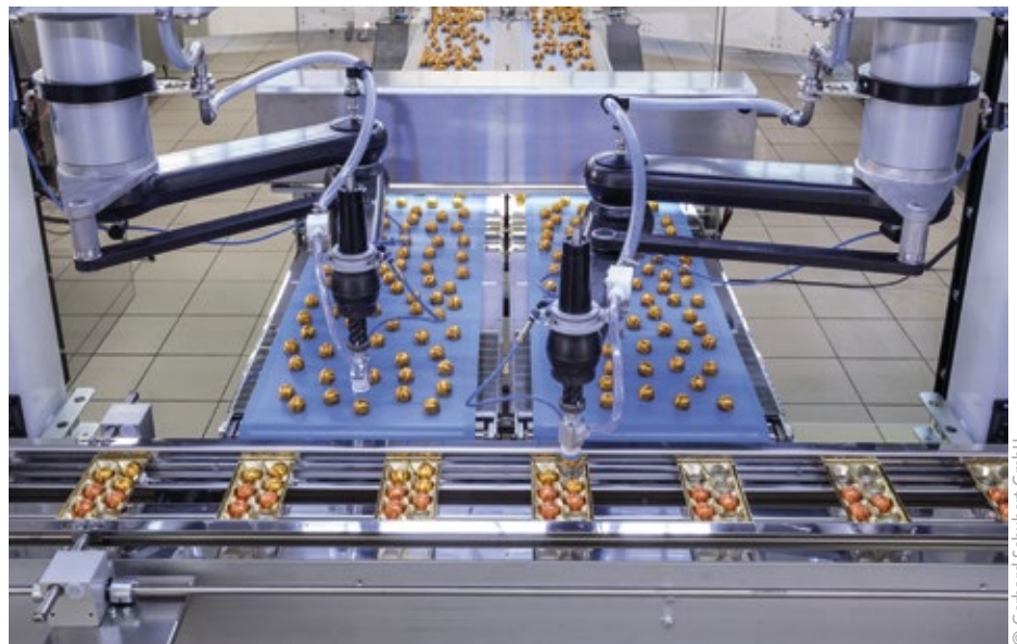
■ Abb. 2: Im Zuführband ist eine neu entwickelte Rütteleinheit integriert, welche die Pralinen schonend aufrichtet.
