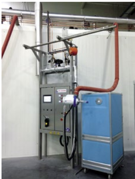
■ Abb. 2: Über die Carbofresh-Füllanlage gelangt das Kühlmittel in wenigen Sekunden in den Kühleinschub.
