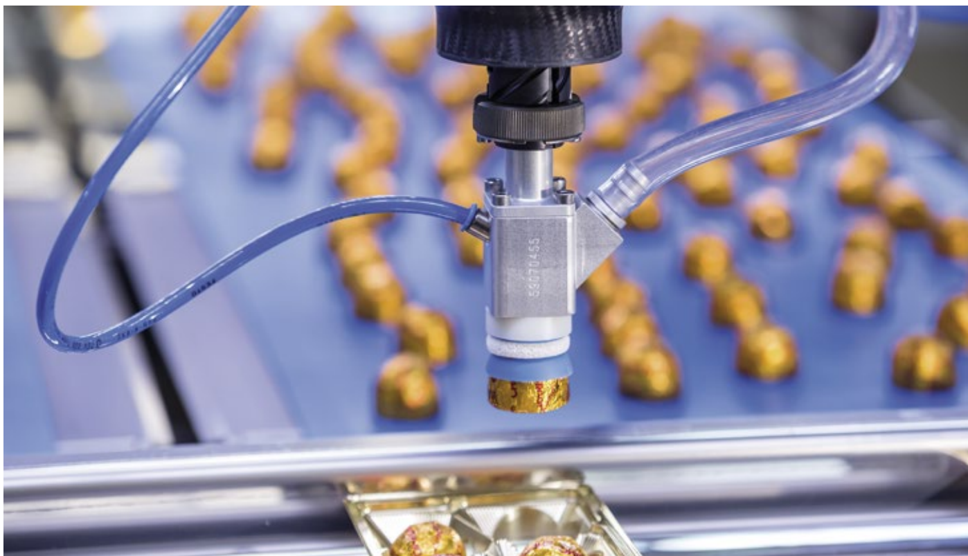
Abb. 1: Nur einwandfreie Produkte werden von den F4-Robotern in die bereitgestellten Kunststofftrays gelegt.
