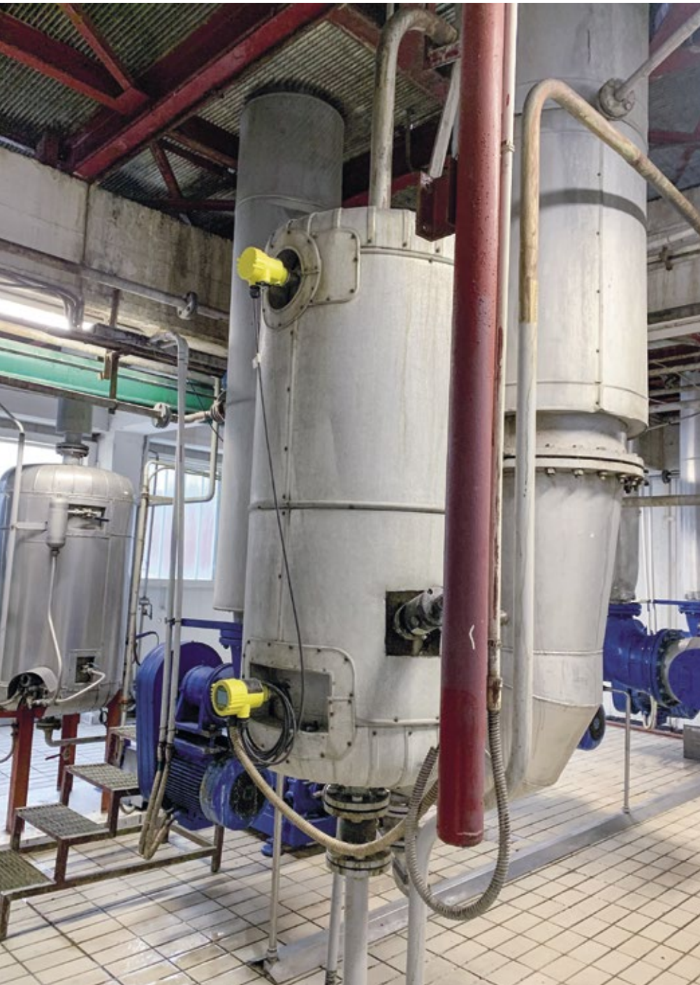
■ Abb. 1: Einflüsse durch Umgebungstemperaturen oder Vibrationen spielen bei der elektronischen Differenzdruckmessung keine Rolle.
