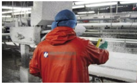
■ Abb. 2: Wasser mit einem Druck von 20 bis 25 bar entfernt im ersten Schritt die groben Rückstände von Anlagen und Böden. Danach erfolgt der hier gezeigte Schaum-Einsatz.
