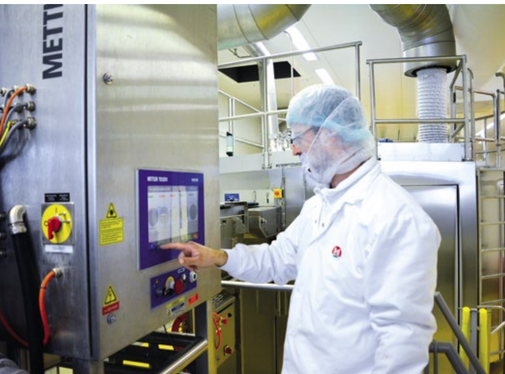
■ Abb. 1: In der Bildbibliothek wird eine Aufnahme jedes einzelnen ausgeschleusten Patties abgespeichert, um detaillierte Fehleranalysen zu ermöglichen.
