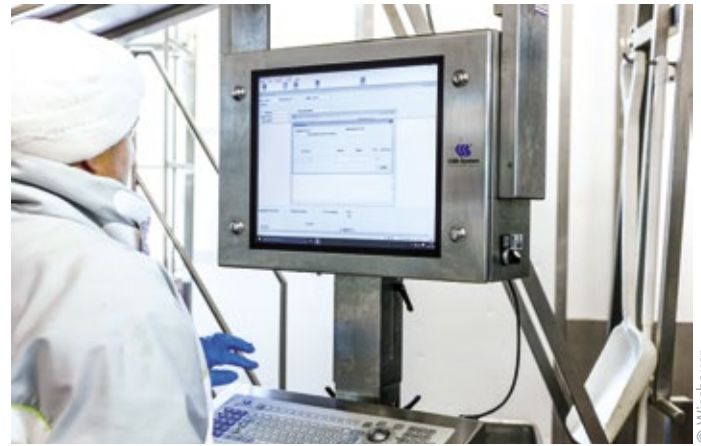
■ Abb. 3: Entsprechend der jeweiligen Rezeptur werden die benötigten Mengen an Fleisch und Speck kalkuliert und an einem CSB-Rack beim Hochregallager angefordert.
