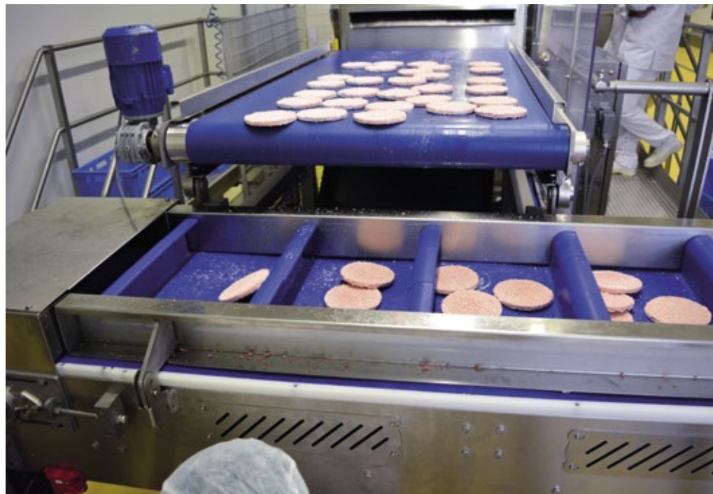
■ Abb. 3: Je nach Patty-Variante durchlaufen zwischen drei und sechs Patties das System mehrspurig. Wird ein visueller Defekt erkannt, erfolgt eine Einzelausschleusung des betroffenen Patties mittels Druckluftdüse.
