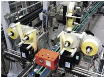
■ Abb. 2: Auf dem Förderband gelangen die Flaschen zur Packmaschine, wo sie in Kartons oder Trays verpackt werden. Ein Etikettendruckspender des Typs Legi-Air 4050 E bringt danach die länderspezifischen Kennzeichnungen an.
