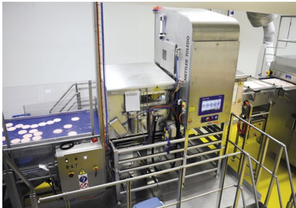
■ Abb. 2: Das Röntgeninspektionssystem ist IP69-geschützt und genügt so auch den intensiven, täglich durchgeführten Reinigungsprozessen.
