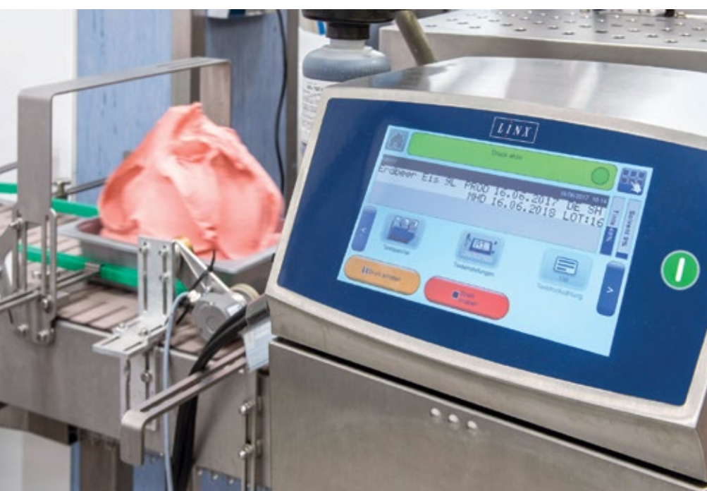
■ Abb.2: Der robuste Continuous-Inkjet-Drucker vom Typ Linx 8900 überzeugt durch einfache Handhabung sowie langen Druckkopfreinigungs- und Wartungsintervallen.
