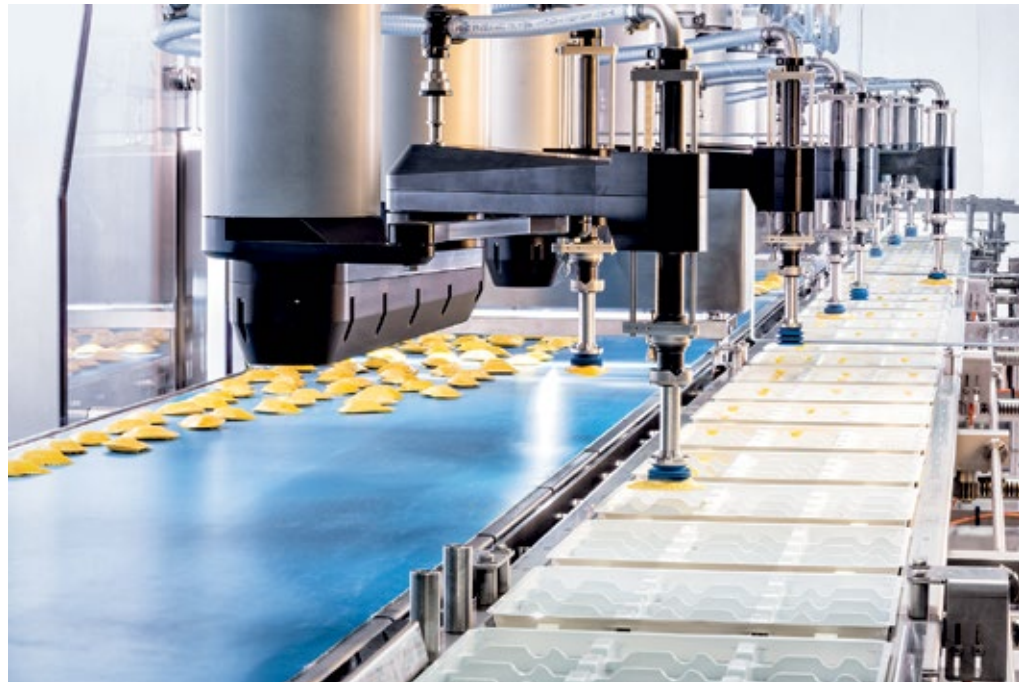
■ Abb. 3: Insgesamt neun F4-Pickerarme sortieren die Ravioli präzise in die Trays.
