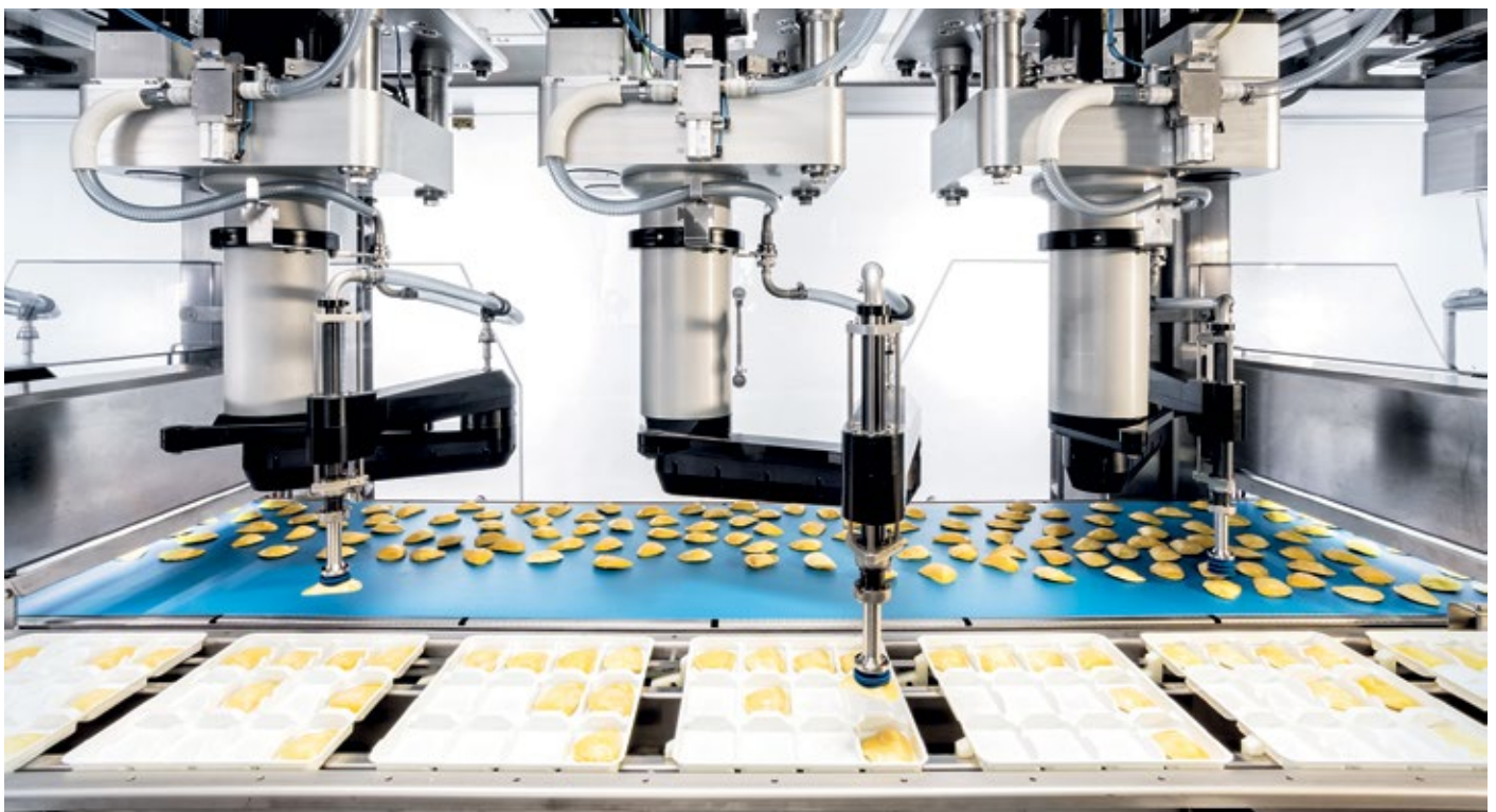
■ Abb. 1: Vom Einlaufband (Hintergrund) übernehmen die F4-Pickerarme die Ravioli, hier der Sorte Mezzaluna, und legen sie in die Trays.
