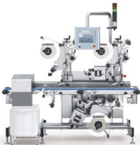
■ Abb. 2: Seit Juli 2016 sind zwei Transportband-etikettierer des Typs L 310 von Multivac mit ihren Taktleistungen von 40 bis 50 Trays pro Minute bei Rabbit im Einsatz.
