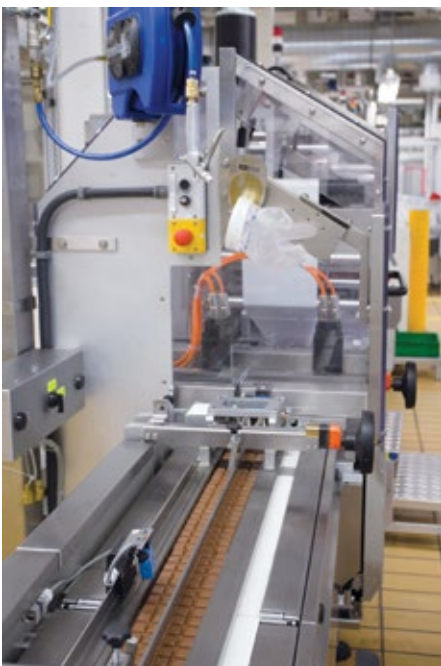
■ Abb. 3: Die Verpackungsmaschinen können in zehn bis 15 Minuten ganz ohne Werkzeug auf andere Formate umgerüstet werden.
