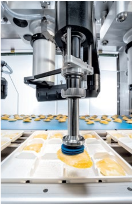
■ Abb. 2: Ein Pickerarm in Aktion: Die Ravioli werden passgenau in die Trays gelegt.
