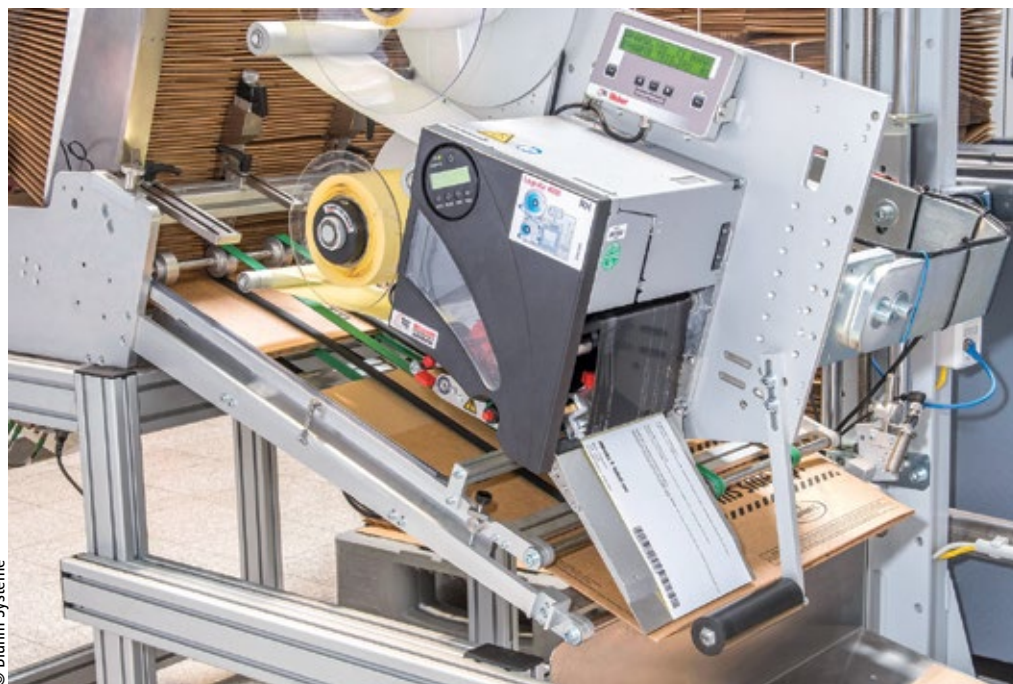
■ Abb. 3: Der Etikettendruckspender Legi-Air 4050WO für tiefkalte Produktionsumgebungen ist direkt in einen Reibanleger integriert.
