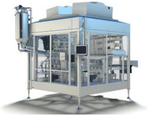
■ Abb. 2: Die erweiterte Version der rundlaufenden Füllmaschine Osgood RFS bietet eine attraktive Alternative für limitierte Stellflächen. In den Ausführungen clean und ultra-clean erhältlich, können bis zu 9.600 Becher pro Stunde in zahlreichen Formaten verarbeitet werden.
