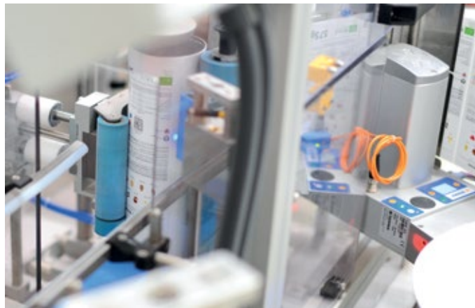
■ Abb. 3: Die Antriebs- und Anwalzrolle versetzt die Packung in Rotation. Mithilfe eines Sensors wird dann das Etikett ausgerichtet gespendet, so dass der voreingedruckte Mymuesli Schriftzug nicht verdeckt wird.
