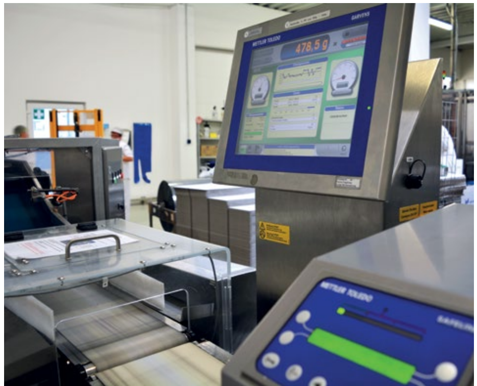
■ Abb. 3: Alle Metalldetektoren werden in 90-Minuten-Intervallen sowie zu Beginn und Ende jeder Produktionsschicht und bei jedem Folien- oder Chargenwechsel getestet, die Ergebnisse automatisch in der Datenmanagement-Software erfasst und dokumentiert.
