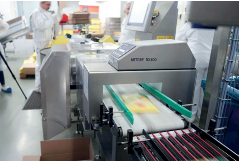
■ Abb. 1: Branchentypisch: Heinrichsthaler installierte die aus Kontrollwaage und Metallsuchgerät bestehenden Kombisysteme als kritische Kontrollpunkte am Ende der Verpackungslinien.
