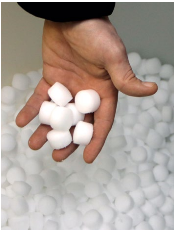
■ Abb. 3: Aus Salztabletten und Trinkwasser wird Anolyte produziert.
