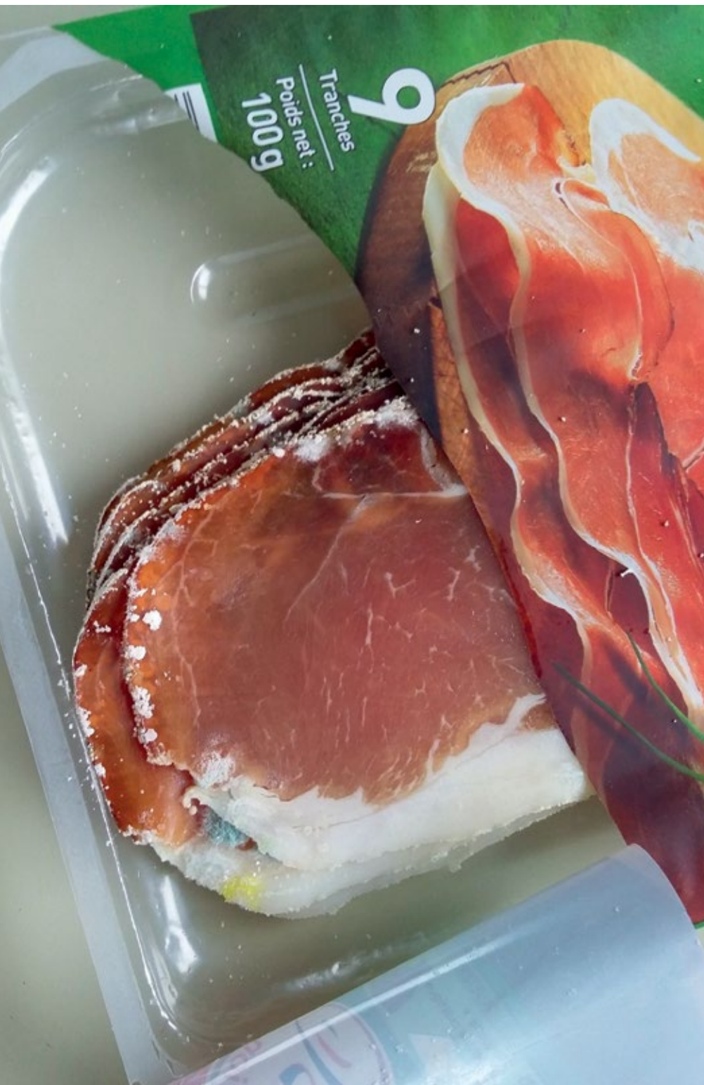
■ Abb. 1: Produktreste in der Siegelnaht können zu einer Undichtigkeit der Verpackung und damit zu einem früheren Verderben der Ware führen.
