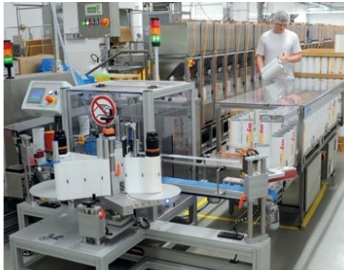
■ Abb. 2: Die Herma Etikettieranlage sorgt bei Mymuesli dafür, dass kundenindividuelle Mischungen auch eine individuelle optisch ansprechende Kennzeichnung erhalten. Im Hintergrund: die angeschlossene Abfüllanlage.
