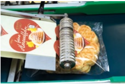
■ Abb. 2: Eine Viel-Scheiben-Rolle fixiert das Etikett sanft und sicher auf der weichen und unebenen Verpackungsfolie.
