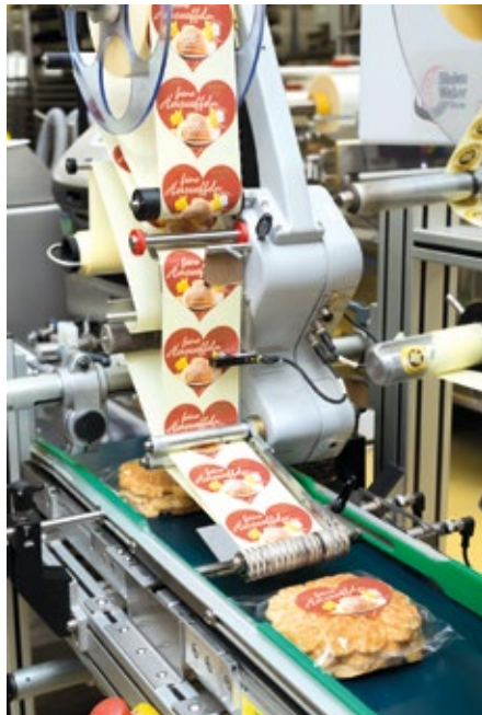
■ Abb. 3: Die Geset 117-Etikettieranlage etikettiert die Waffelverpackungen von oben und von unten.
