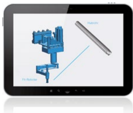
■ Abb. 1: Die neue Datenbox wird noch genauere Rückmeldungen bereitstellen und so Wartung und Instandhaltung weiter erleichtern. In diesem Beispiel zeigt die Fehlerbenachrichtigungsfunktion an, dass ein Hubrohr ausgetauscht werden muss.
