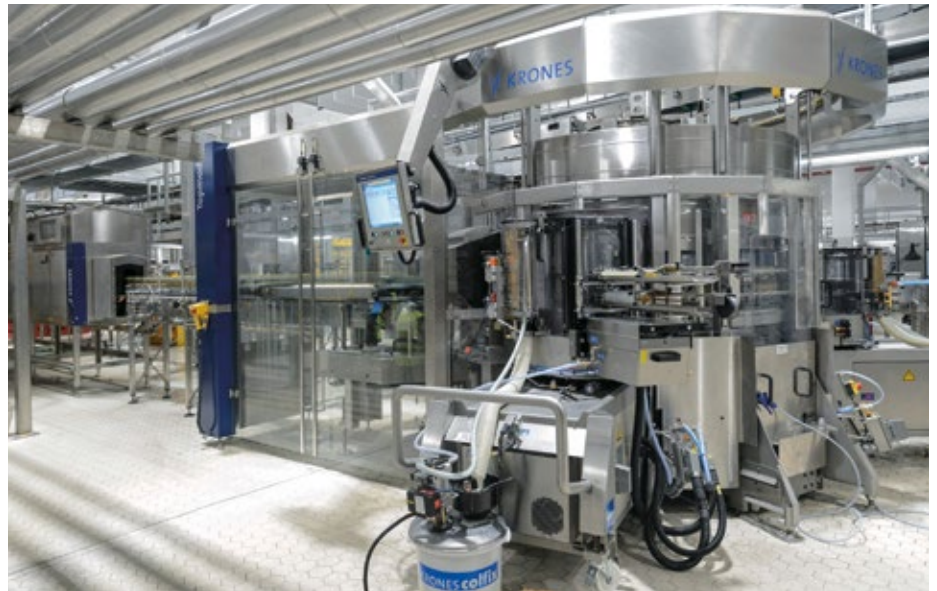
Abb. 2: Beim Etikettieren hat Farsons dank Modultechnik die Wahl zwischen Kaltleim-Etiketten für Mehrweg-Glasflaschen oder Selbstklebe-Etiketten für die Einweg-Glasflaschen.
