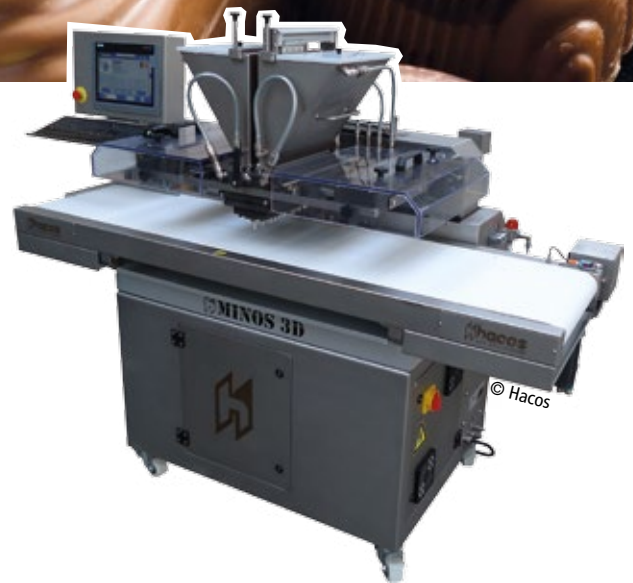
■ Abb. 2: Die Minos 9 beherrscht den One-Shot-Aufbau von Schokoladenprodukten in Formen und auf Platten. Der Kopf mit den Produkttrichtern für Schokolade und Füllung übernimmt die dazu nötigen Vertikalbewegungen, das Band die Horizontalbewegungen. Mit 3D-Option sind dabei auch Bewegungen quer zur Transportrichtung des Bandes möglich – was die Maschine äußerst vielseitig macht – bis hin zum Dekorieren mit Schriftzügen.
