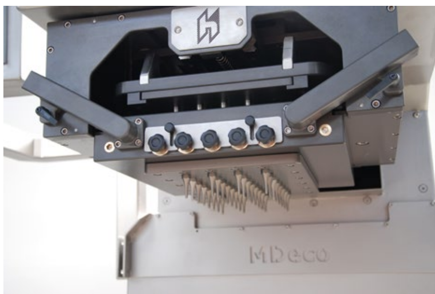
■ Abb. 3: Der in 3 Richtungen bewegliche Kopf der Mdeco.
