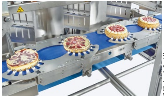
■ Abb. 1: Mit ultraschallerregten Messern werden Torten und andere Lebensmittel ohne Druck in schnellem Tempo portioniert.
