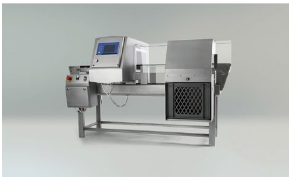
■ Abb 3: Das Metalldetektionssystem Varicon+ erzeugt ein elektrisches Feld in seinem Spulenbereich. Jedes Produkt, das den Detektor durchläuft, hinterlässt ein spezifisches Muster. Abweichungen deuten auf eine Verunreinigung hin und stoßen einen Ausschleusprozess an.
