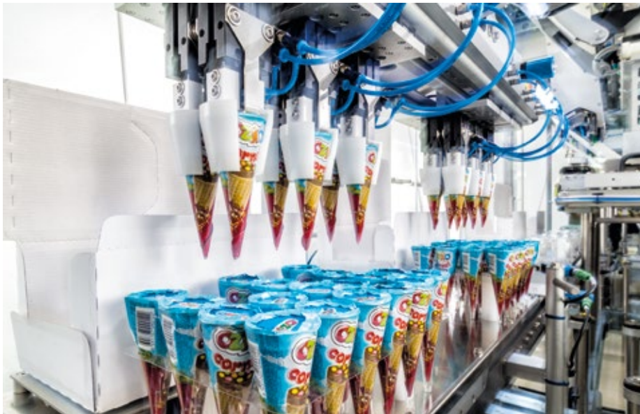
■ Abb. 2: Waffeln werden mit Sorgfalt angesaugt und transportiert.
