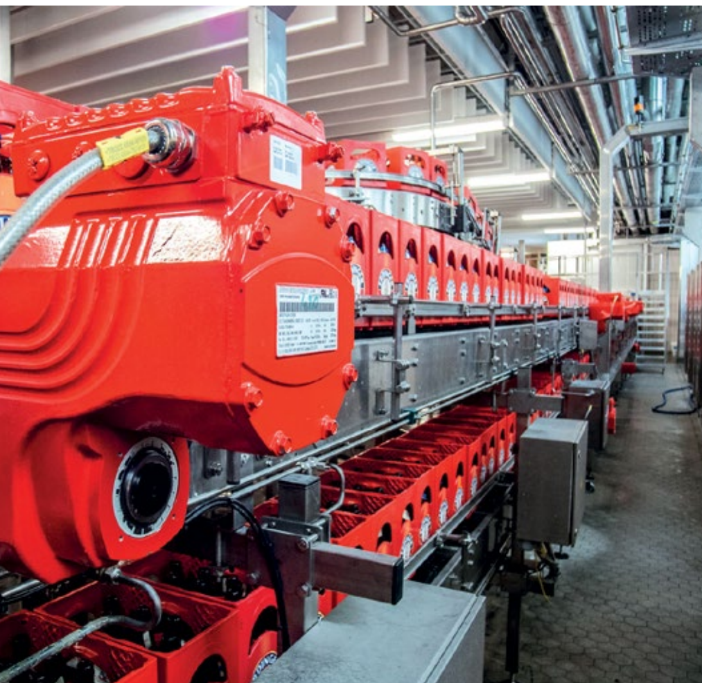
■ Abb.1: Die mechatronischen Antriebseinheiten Movigear transportieren die Leergutkästen zur Kas-
