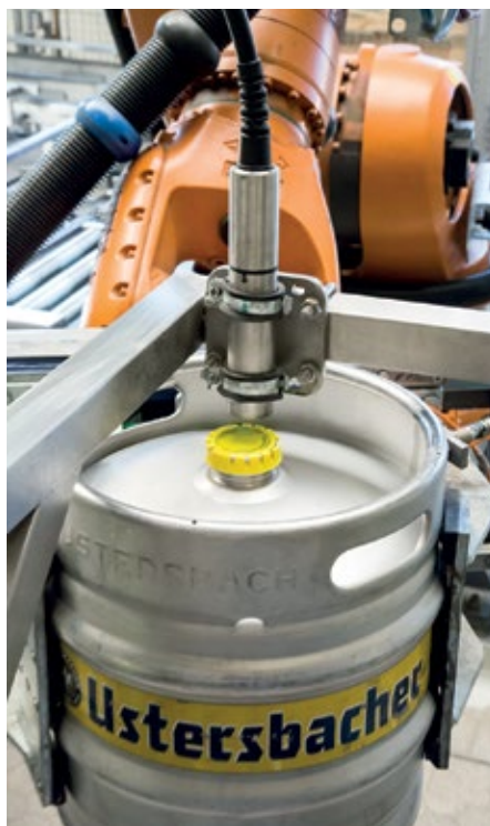
■ Abb. 3: Ein Roboterarm führt die zu kennzeichnenden Gebinde zum Linx-Schreibkopf. So muss beim Wechsel auf andere Gebinde nicht extra der Kopf umgestellt werden.
