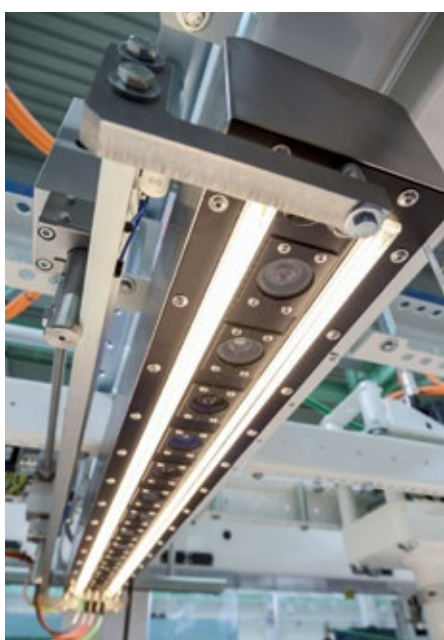
■ Abb. 2: Schuberts 3D-Scanner ist der bisherige Höhepunkt in der Entwicklung der Bildverarbeitung für die Verpackungsindustrie.
