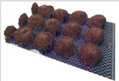
Abb. 4: Muffins in 3D-Ansicht aus den Stereo-Daten des 3D-Scanners.
