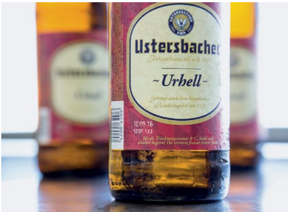
■ Abb. 1: Der Laser markiert jede Flasche zweizeilig mit einem Mindesthaltbarkeitsdatum, dem minutengenauen Produktionszeitpunkt und einer weiteren Chargeninformation.
