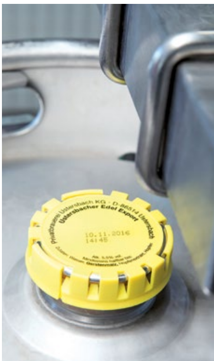
■ Abb. 2: Die KEG Kunststoffverschlussdeckel beschriftet ein Linx-Drucker.
