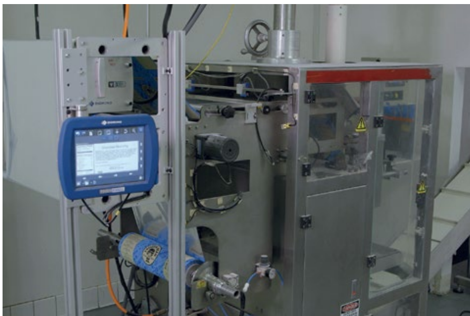
■ Abb. 2: Das Bild zeigt die Anlagenintegration der V320i Thermotransferdrucker und das Display visualisiert das Druckbild für „Chocolate Mint Chips made in USA“.
