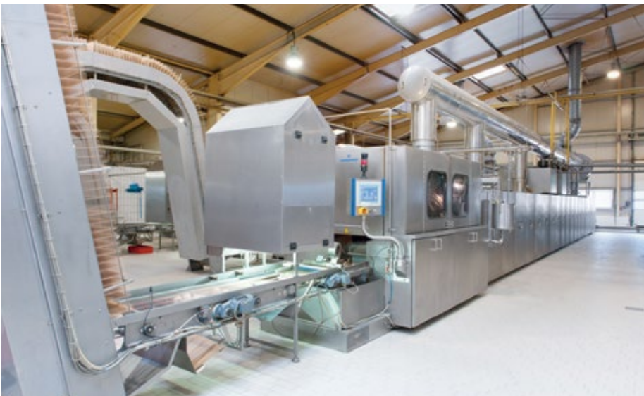
■ Abb. 4: Hier wird der Teig zu Flachwaffeln für die Süßwarenproduktion gebacken: Der Vorratsbehälter (rechts neben den Sichtfenstern) dient als kurzfristiger Puffer für den Backofen. Der Füllstand wird mittels Sensoren erfasst und automatisch reguliert.
