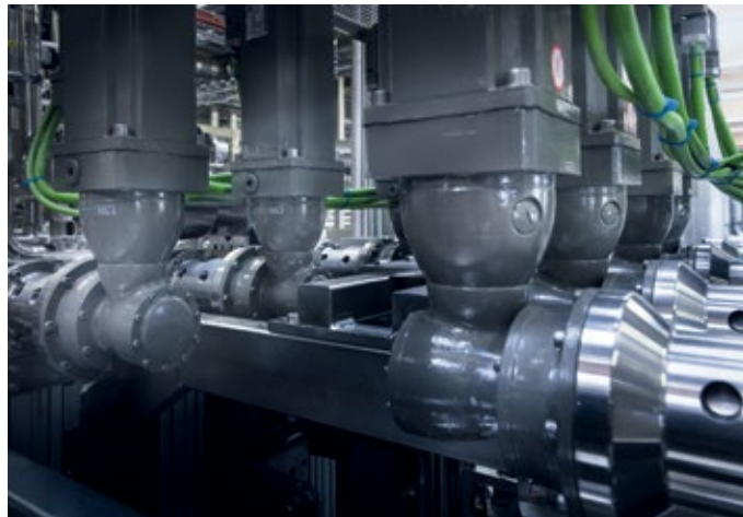
■ Abb. 2: Winkelgetriebe auf dem Ventilknotten einer Combibloc 612 food-Verpackungsmaschine: Übersetzen von Linearbewegung für das Verfahren von Stößeln beziehungsweise Ventilen.
