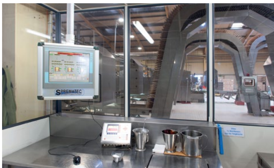
■ Abb. 2: Von der Bedienstation am Mischer kann über das Leitsystem die Produktion gestartet und kontrolliert werden. Kurzfristige, manuelle Änderungen an den Rezepten sind jederzeit möglich. Im Hintergrund sind die Produktionslinien für die Flachwaffeln zu sehen.
