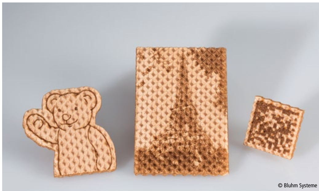
■ Abb. 2: Mit Schutzart IP55 oder IP65 können Laser problemlos in der Backwarenindustrie eingesetzt werden, um z.B. Logos oder Markennamen direkt auf Waffeln, Brot oder Brötchen aufzubringen.
