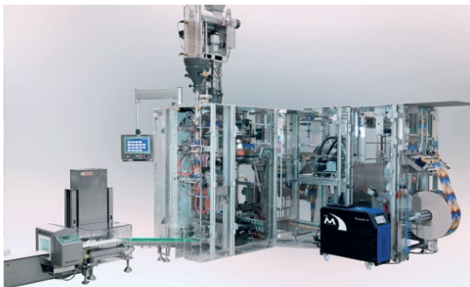
■ Abb. 2: Die PME-Schlauchbeutelmaschine mit ZAP-Modul und das Axello ZAP-Papier vereinen die vorteilhafte Schlauchbeutel-Technik mit dem nachhaltigen Verpackungsmaterial Papier zur staubdichten Verpackung trockener Nahrungsmittel.
