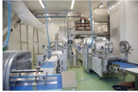
■ Abb. 3: Die Mehrkopfwaaage Ishida CCW-RS bestückt eine Schlauchbeutel- und eine Tiefziehmaschine.
