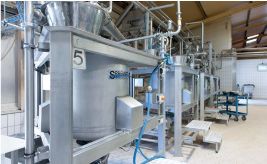
■ Abb. 3: Das Bild zeigt die fünf Mischer, die für den regelmäßigen Teignachschub in die Flachwaffelproduktion sorgen. Die Befüllung mit Rohstoffen erfolgt über das Rohrsystem und ist mittels Pumpen und Schneckengetriebe automatisiert. Integrierte Sensoren messen das Gewicht des Teigs. So werden die Rohstoffe genauestens zugeführt
