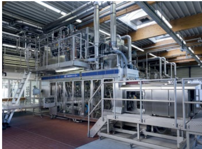
■ Abb. 4: 12.000 Verpackungen pro Stunde leistet die SIG Combibloc 612 food – nicht zuletzt dank hochdynamischer Antriebseinheiten von Wittenstein.
