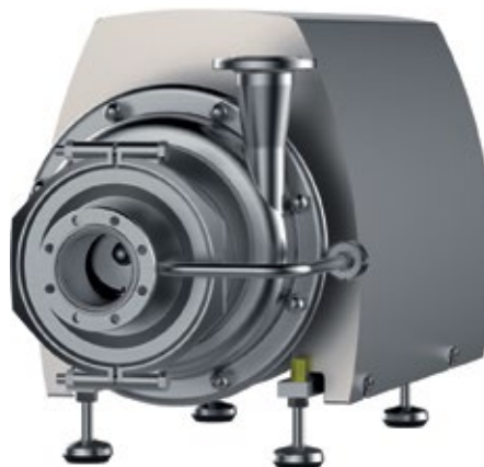
■ Abb. 3: Ähnlich glatt wie die Außenflächen ist auch das Pumpeninnere der GEA TPS konstruiert. Das tottraumfreie Design bietet ein hohes Maß an Hygiene und ermöglicht eine leichte Reinigung.
