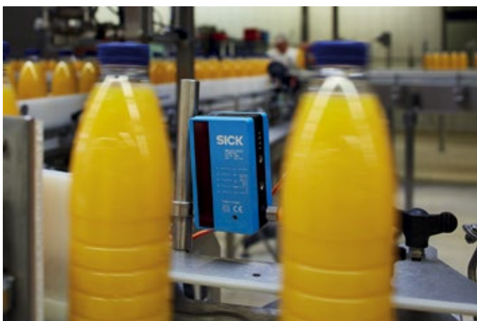
■ Abb. 2: Lichtgittersensoren der WLGSerie erkennen den Füllgrad des Behältertransportsystems, unabhängig von der Flaschenform.
