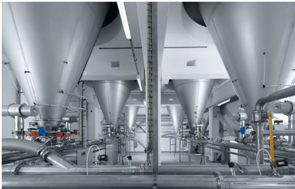
■ Abb. 2: Energieoptimierte und schonende Dichtstromförderung AZO Saugplüs.
