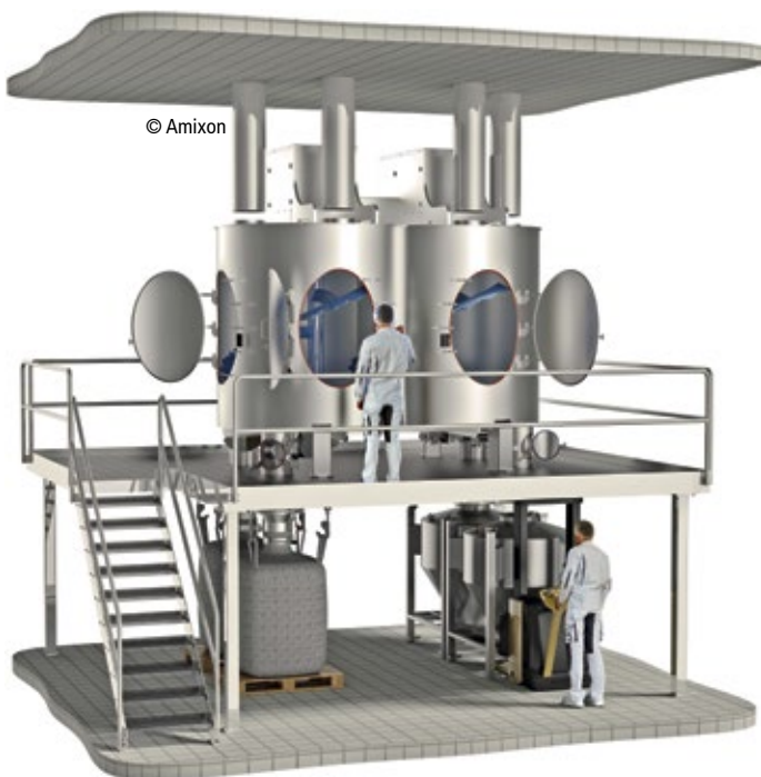
■ Abb. 1: Doppelwellenmischer mit 10 m 3 nutzbarem Volumen mit vier totaumentraffenen Austragsorganen, die zeitgleich fungieren. Der Mixer weist acht Clevercut Inspektionstüren auf.
