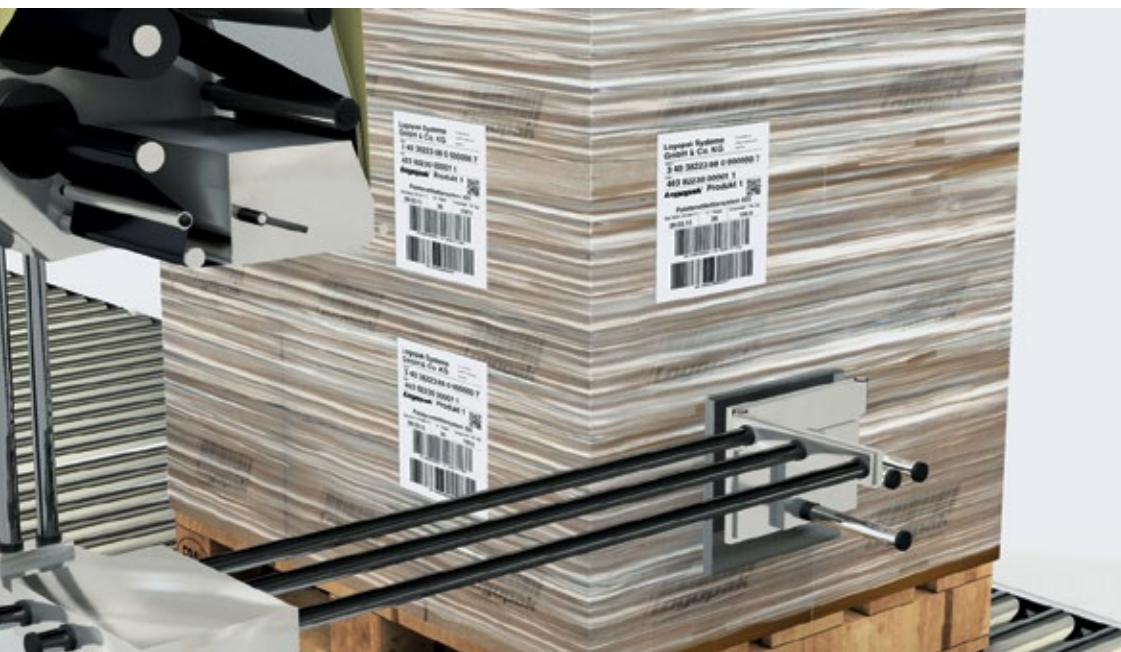
Abb. 1: Flexible Etikettierung auf unterschiedlichen Palettenoberflächen und die Anbringung individueller Labels an verschiedenen Positionen sind wesentliche Leistungsmerkmale der Etikettierautomaten.
