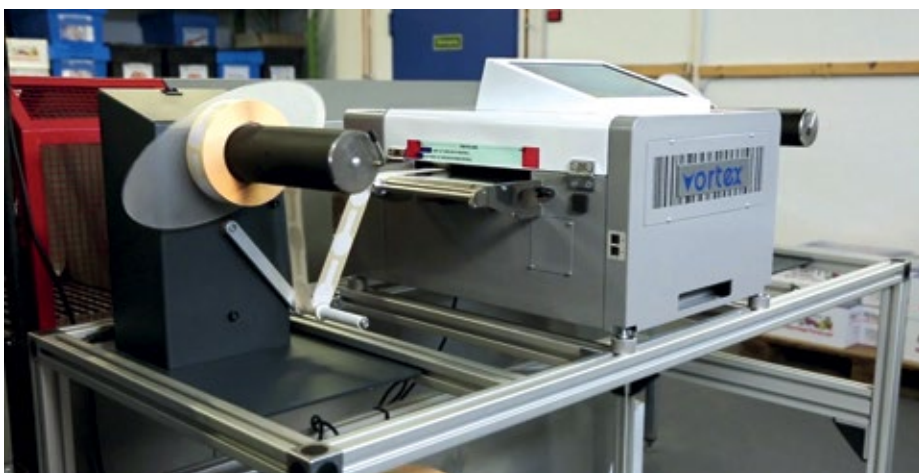
■ Abb. 3: Die industrielle Labelpresse des Herstellers RTI in Verbindung mit einem speziellen „Wasserfall“-Tintendruckkopf von Memjet erlaubt Etiketten-Bögen oder -rollen in einer Auflösung von 1.600 dpi und mit einer Geschwindigkeit von 300 mm pro Sekunde zu bedrucken.
