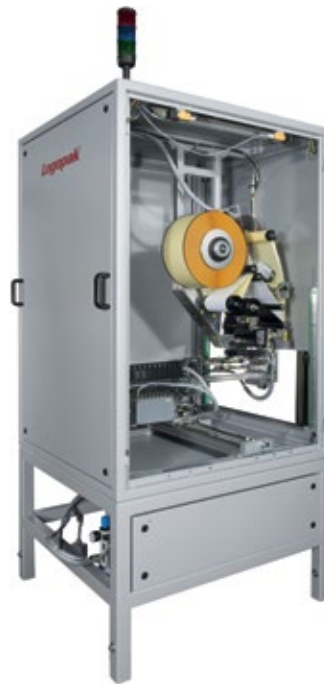
■ Abb. 2: Die Hochleistungs-Paletten-Etikettierautomaten für das Zwei-Seiten- bzw. das Drei-Seiten-Labeling sind für Etiketten im DIN A5 Format nach GS1 Norm sowie kleinere Individualformate ausgelegt.
