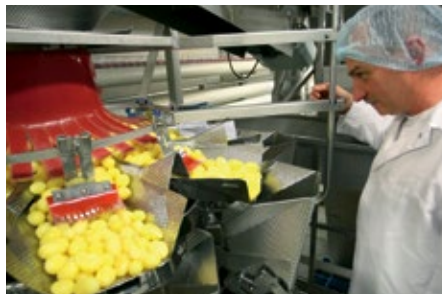
■ Abb. 2: Michael Gerischer, Produktionsleiter Friweika beobachtet die Mehrkopfwaaage CCW-RV im Einsatz.
