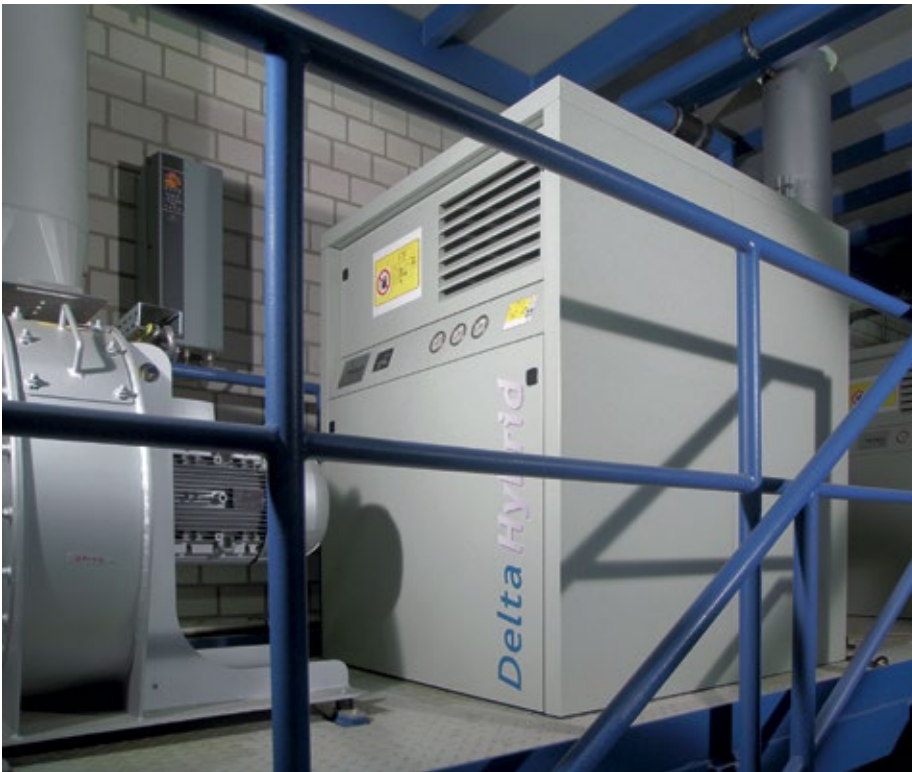
■ Abb. 4: Das Förderluft-Aggregat der neuen Aerzen Baureihe Delta Hybrid bei den Probat-Werken.
