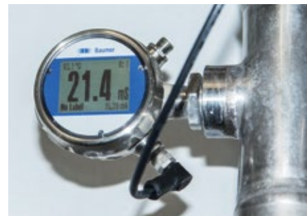
■ Abb. 2: Das Combilyz in der CIP-Leitung sorgt für eine reibungslose Regelung des mehrstufigen CIP-Prozesses.
