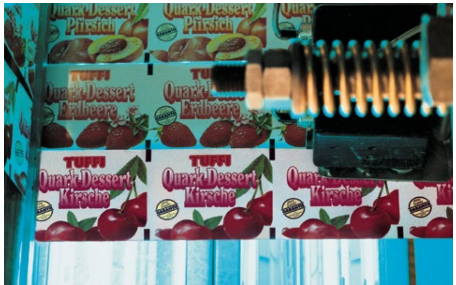
■ Abb. 2: Damit der Joghurt länger haltbar ist: Sekundenschnell werden ohne den Einsatz von Chemikalien Packstoffoberflächen, wie hier Folien, mit intensivem UV-Licht zuverlässig entkeimt.
