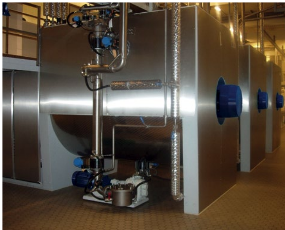
■ Abb. 3: Die Antriebstechnik der neuen Conchen TNCE berücksichtigt die Schwankungsbreite bei den Eigenschaften der Zutaten. Das Gesamtsystem aus Einspeisung, Umrichter, wassergekühltem Motor und Großgetriebe ermöglicht einen höheren Energieeintrag, ohne dass die Stromkosten ausufern.
