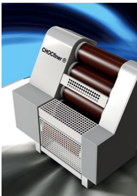
■ Abb. 2: Passt vormontiert in einen Container und spart eine Maschine ein: Zwischenkreisgekoppelte Servomotoren erzeugen beim Fünf-Walzen-Stuhl Chocfiner rezepturgesteuert Scheerkräfte in der ersten Passage. Der Kristallzuckeranteil der Masse kann so ohne separates Vorwalzwerk verarbeitet werden. Die Maschine wird komplett vorinbetriebgesetzt angeliefert und ist binnen weniger Tage produktiv.
