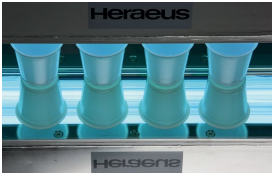
■ Abb. 1: Mit einem kombinierten Verfahren von UV-Licht nach Einwirkung von niedrig prozentigem Wasserstoffperoxid können auch strahlungsresistente Schimmelpilzkeime auf Packstoffoberflächen inaktiviert werden. © Heraeus Noblelight GmbH
