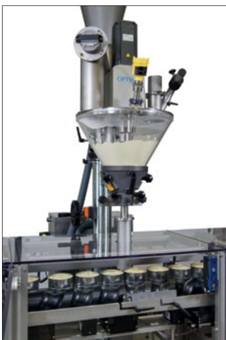
■ Abb. 4: Der dritte Schneckendosierer der Anlage: Das Topping-up ist für die die Feindosierung zuständig.
