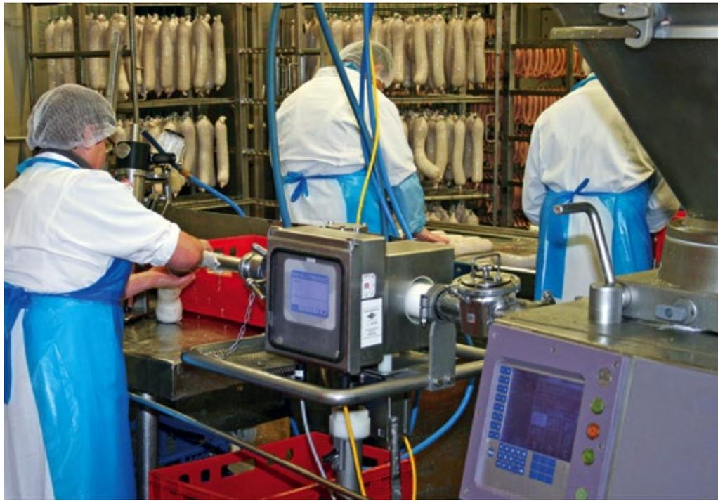
■ Abb. 2: In der Füllerei befindet sich einer der sensibelsten CCP's: Hier die fertigen Rohmassen z.B. in Kollagendärme abgefüllt.
