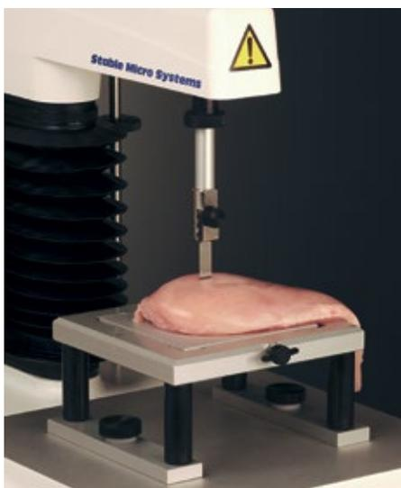
Abb. 2: Razor Shear Blade zur Messung der Zartheit von Geflügel.
