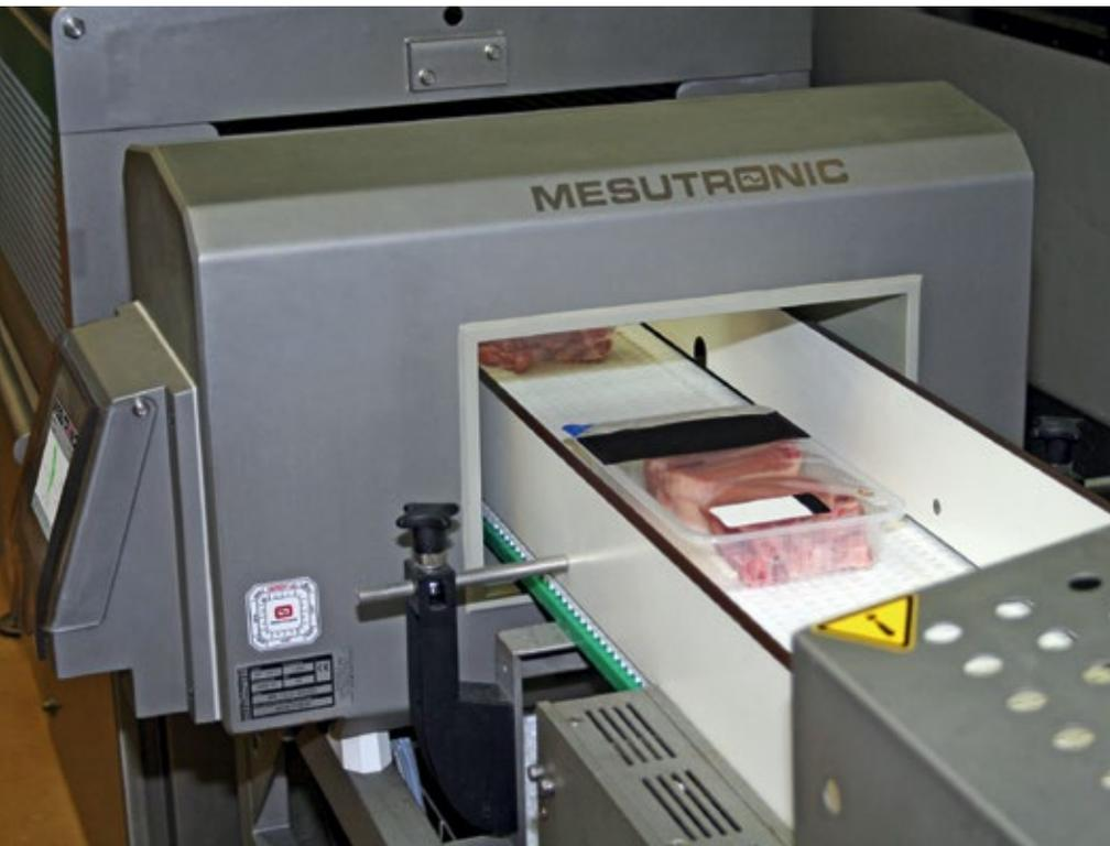
■ **Abb. 3:** Nach dem Abfüllen und Finishen der Produkte folgt die Endverpackung. Sie bildet den letzten CCP der Produktion, der bei der Wolf Wurstspezialitäten GmbH in Schwandorf mit einem Metalldetektor abgesichert ist.
