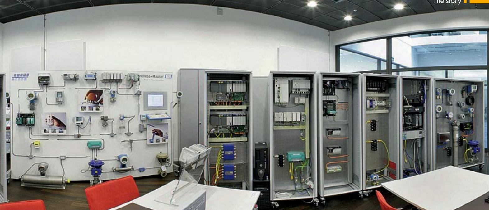
■ **Abb. 2: Endress+Hauser Feldbuslabor: Hier können Anlagenbauer und Betreiber für Projekte Hardware-, Steuerungs- und Bus-Konzepte unter Praxisbedingungen testen.** © Endress+Hauser
