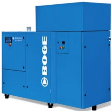
■ Abb. 3: Basis der Bluekat-Kompressoren sind hocheffiziente öleingespritzte Schraubenverdichter der S-Baureihe mit herkömmlicher Öleinspritzung. Direkt hinter der Verdichterstufe ist ein Konverter integriert, der das in der Druckluft enthaltene Öl zu Kohlendioxid und Wasser oxidiert.
