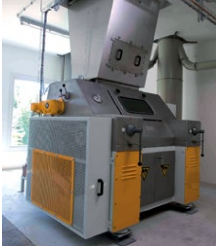
■ Abb. 2: In der Flockerei werden Getreidekörner mit Dampf behandelt, um sie weich und flockierbar zu machen. Durch den Erhitzungsprozess wird zusätzlich eine deutlich längere Haltbarkeit erreicht.
