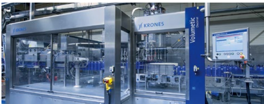
■ Abb. 2: Die Regeltechnik ist jetzt nicht mehr im Fülleroberteil untergebracht, sondern direkt im Ventil.
