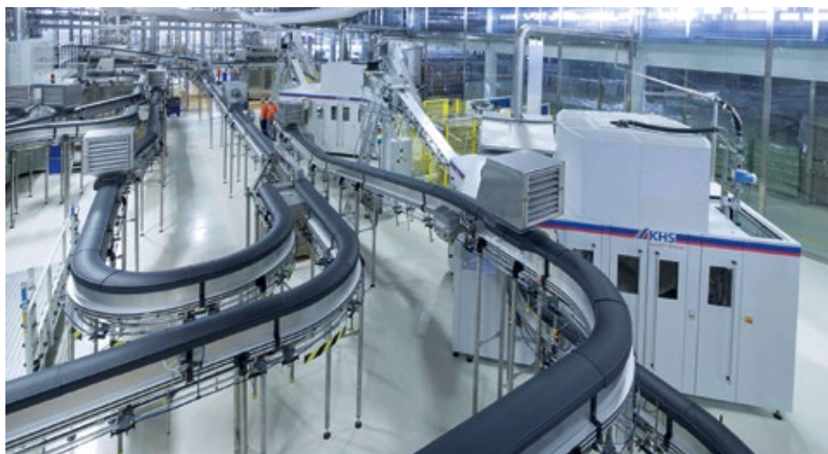
■ Abb. 3: Mittels Lufttransporteuren gelangen die in der Inno-PET Blomax Serie IV produzierten PET-Flaschen zur Inno-PET Plasmax. Hier werden sie mit einer Innenbeschichtung versehen, die aus reinstem Glas besteht und die auch empfindlichsten Getränken den optimalen Schutz gegen Qualitätsverlust bietet.
