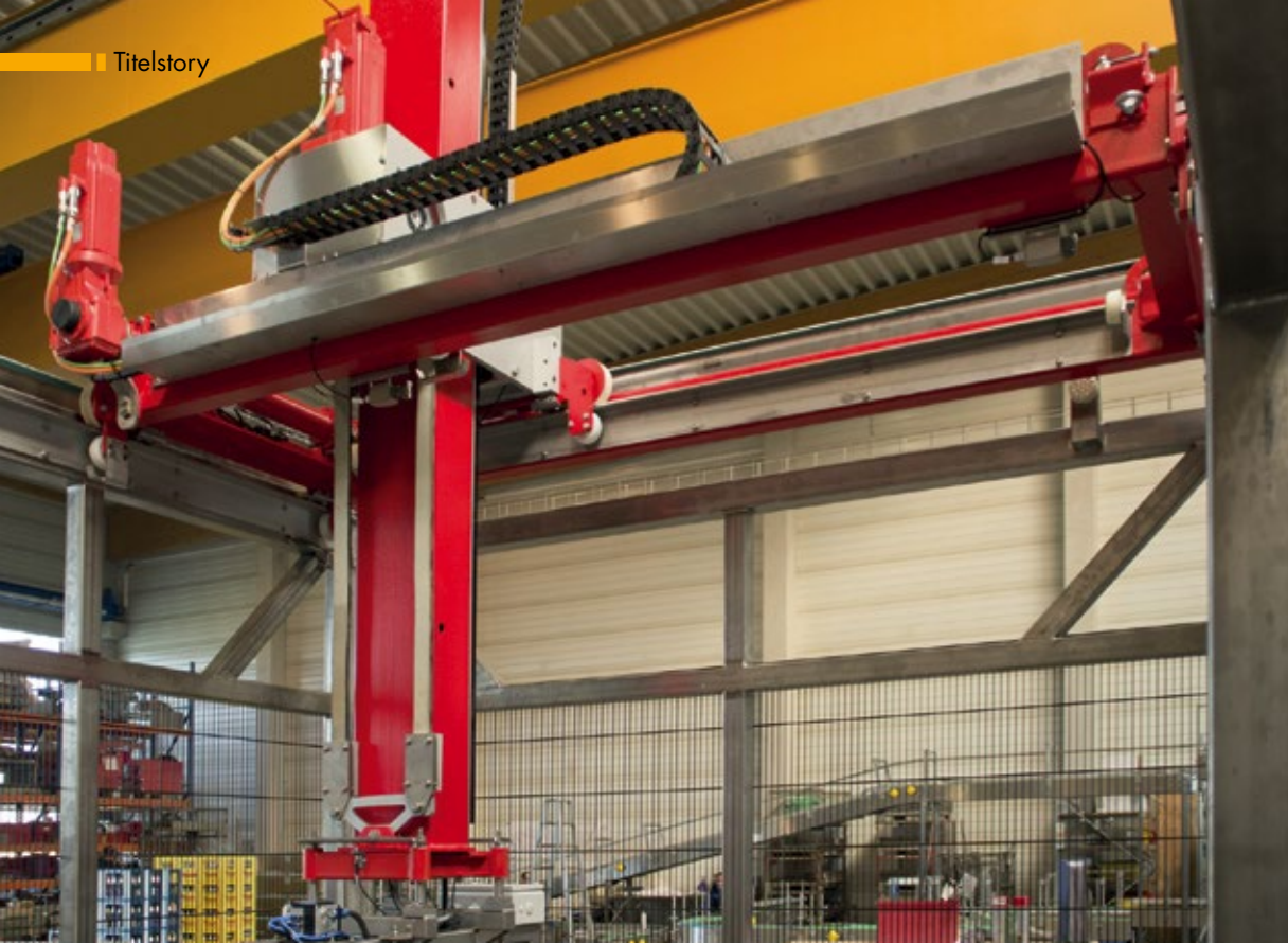
■ Abb. 3: Portalroboter von BMS lassen sich dank ihres modularen Aufbaus flexibel an die örtlichen Gegebenheiten anpassen.
