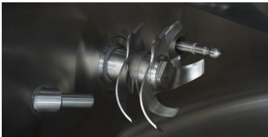
■ Abb. 3: Schneidrotoren bewirken die Entklumpung und Zerkleinerung von Agglomeraten.
