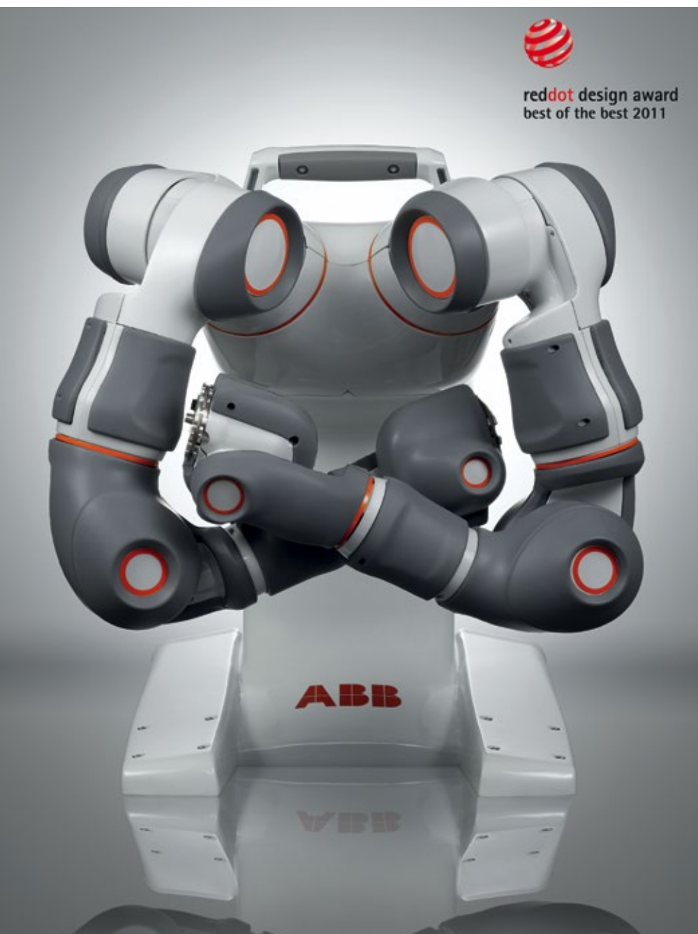
■ Abb. 1: ABBs Roboter-Konzeptstudie FRIDA ist die Abkürzung für „Flexible Robot Industrial Dual Arm“.
