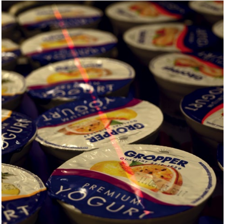
■ Abb. 1: Voll-Steigenkontrolle mit einem LRS 36 Lichtschnittsensor von Leuze Electronic an einer Becher-Abfüllanlage in der Molkerei Gropper mit deutlich sichtbarer Laserlinie.
