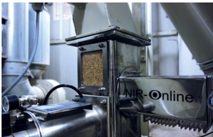
■ Abb. 2: Die NIR-Online-Geräte sorgen für eine zeitnahe Kontrolle der Misch- und Pelletierprozesse.
