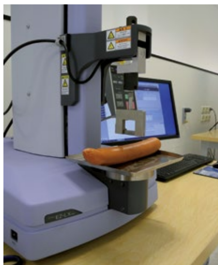
■ Abb. 3: Test der Schnitffestigkeit mit dem EZ-Test-LX.
