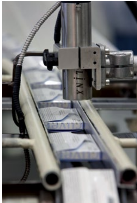
■ Abb. 3: Chargen- und Haltbarkeitsinformationen bringt der Linx-Tintenstrahldrucker auf.
