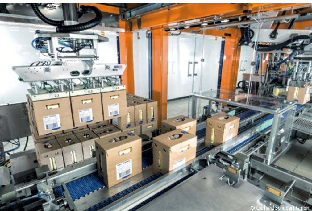
■ Abb. 3: Ein TLM-F2-Roboter setzt Kartons auf die bereitstehende Palette ab.
