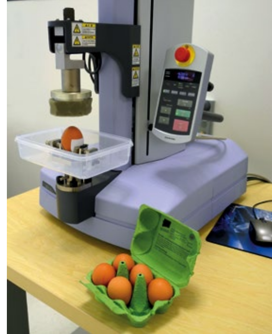
■ Abb. 1: Textur-Analysator EZ-Test-LX mit modifiziertem Kompressionsaufsatz.
