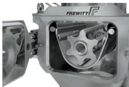
■ Abb.: Blick in den Innenraum einer Siebmühle des Typs Oscillowitt.
