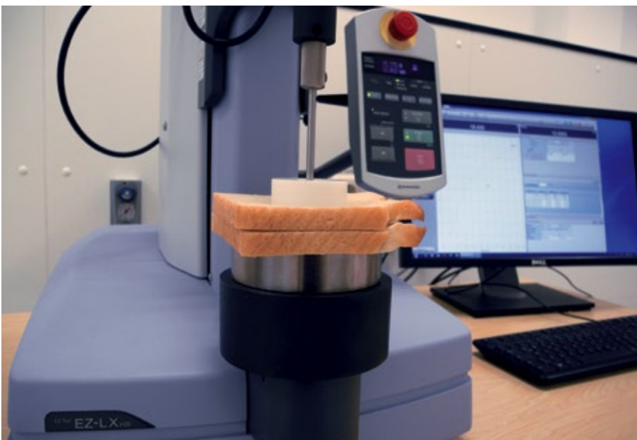
■ Abb. 2: Textur-Analysator EZ-Test-LX mit ø 50 mm Kompressionsaufsatz.
