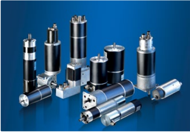
■ Abb.: Positionierantriebe für die automatische Formatverstellung vereinen bürstenlosen DC-Motor, Planetengetriebe, absoluten Positionssensor, Feldbus-Schnittstelle und Leistungselektronik.
