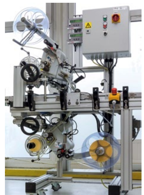
■ Abb. 2: Die Geset-Anlage bringt bei den Pralinen und Tafeln gleichzeitig auf der Ober- und Unterseite jeweils ein Etikett auf.
