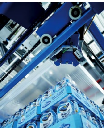
■ Abb. 2: Die Hochleistungsverpackungsmaschine Beumer Stretch Hood sichert die Ware auf der Palette, minimiert den Folienverbrauch und schützt das Produkt vor äußeren Einflüssen.
