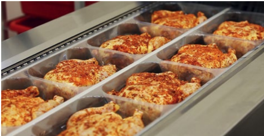
■ Abb. 2: Die mechanischen und thermischen Eigenschaften der speziellen tiefziehfähigen Mylar Cook-Folien eignen sich für scharfkantige Produkte und deren Behandlung im Temperaturbereich zwischen - 60 und + 218 °C.
