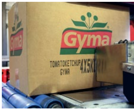
■ Abb. 3: Für die Karton-Großbeschriftung kommt ein Markoprint-Drucker mit Trident-Technologie zum Einsatz. © Bluhm Systeme
