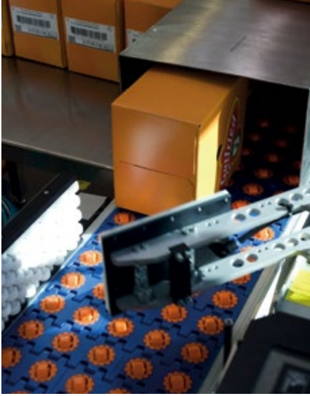
■ Abb. 2: Die Etiketten werden im schonenden Tamp-Blow-Verfahren per Luftstoß aufgeschossen. © Bluhm Systeme
