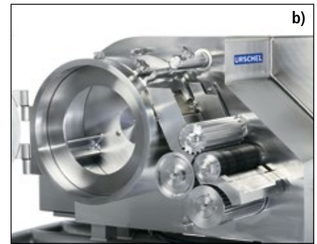
■ Abb. 2 a+b: Arbeitsweise Affinity Würfelschneidemaschine.
