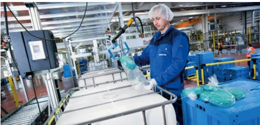
■ Abb. 2: Besondere Foodcert Präventionsmaßnahmen: Bereits vorproduzierte Komponenten wie z. B. Schraubkappen sind bis zur Endmontage hygienisch verpackt, die Mitarbeiter tragen Schutzkleidung entsprechend detaillierter Hygienevorschriften.
