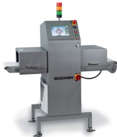
Abb. 2: Erkennt auch Fremdkörper aus Holz, Glas, PVC und Stein: der Röntgenscanner XRE.
