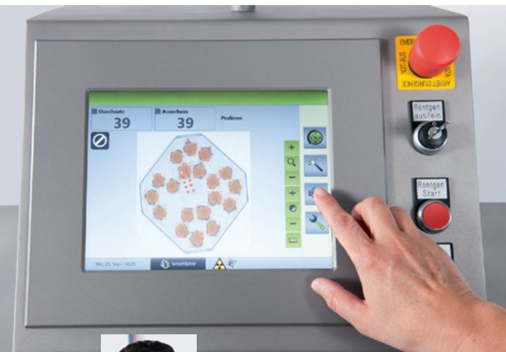
Abb. 1: Die Visualisierungssoftware des XRE lässt sich per Touchscreen konfigurieren.
