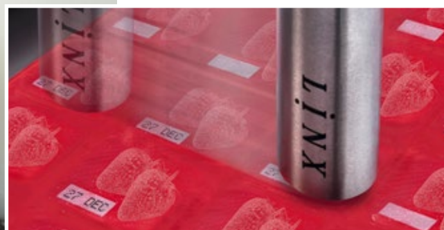
■ Abb. 1: Für die Direkt-Kennzeichnung von Produkten an mehrbahnigen Produktionslinien gibt es den Tintenstrahldrucker Linx Dairy.
