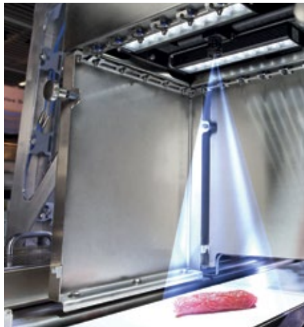
■ Abb. 2: Zur Überprüfung der Produkt-, Verpackungs- oder Siegelqualitäten hat sich das optische Inspektionssystem MVS (Multivac Vision System) bewährt.
