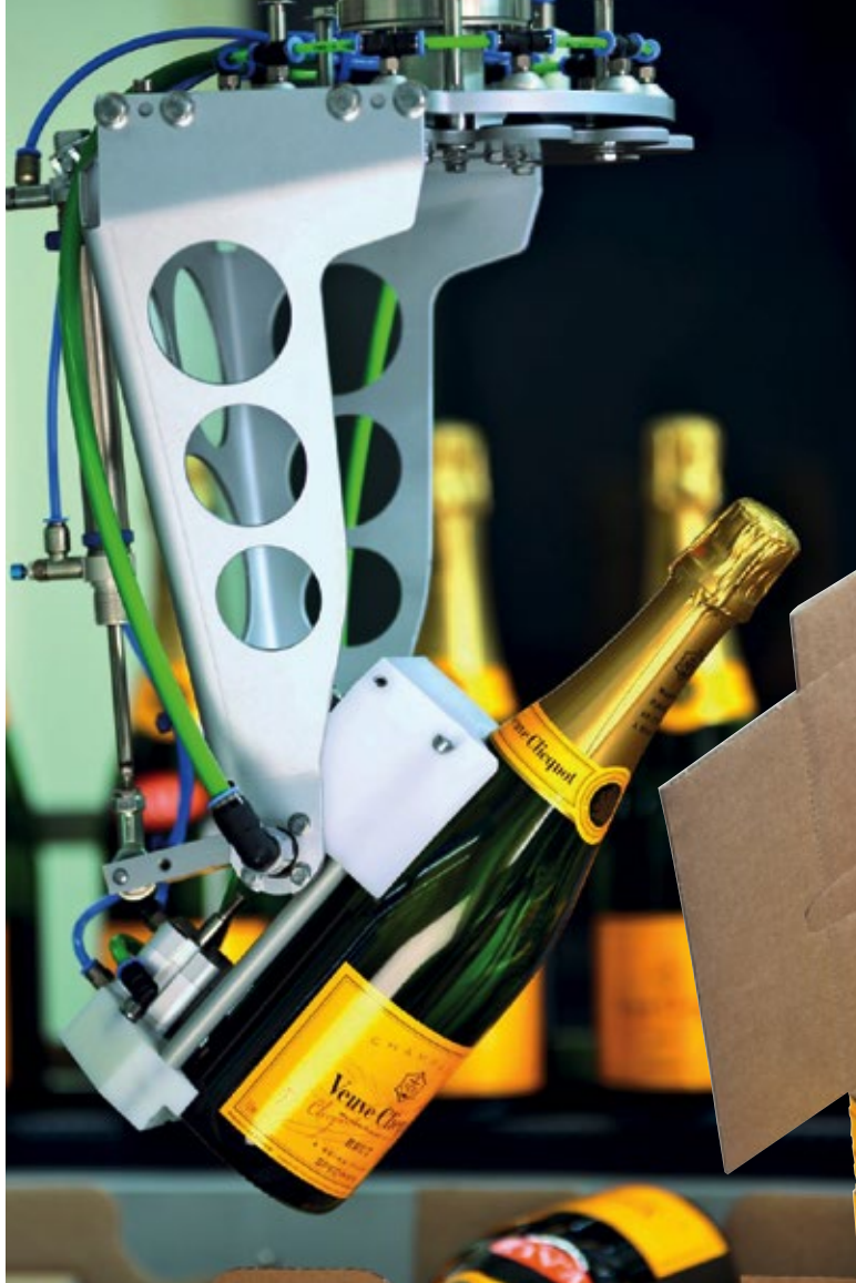
■ Abb. 2: Die mit Flaschen befüllten Kartoneinsätze werden in den Schachteln abgelegt. Die Werkzeuge der TLM-F4 sind so konstruiert, dass die Saugfläche das Etikett ausspart.
