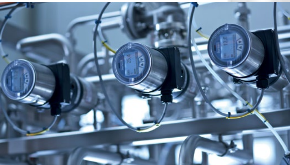
■ Abb. 1: Die Ventile aus der Element-Serie wurden für den Einsatz in Prozessen mit hohen Ansprüchen an die Anlagenhygiene konstruiert.
