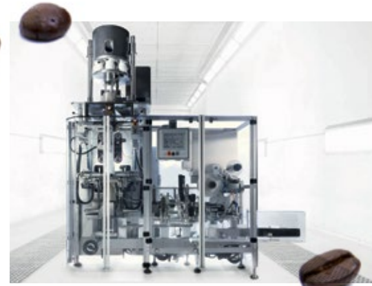
■ Abb.: „Genuss trifft Effizienz“ – auf der FachPack wird die Zenobia am Stand 135 in Halle 4A Pulverkaffee mit bis zu 80 Takten pro Minute abpacken – sowohl in Giebelbeutel als auch Blockbeutel mit Faltung und Etikettierung.
