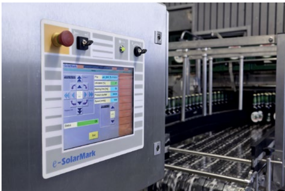
■ Abb. 2: Daten und Parameter lassen sich beim E-Solarmark HD schnell und einfach über den Controller eingeben und einstellen.
