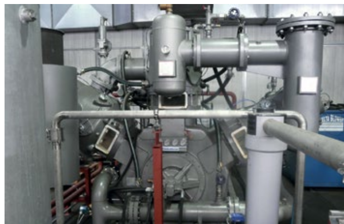
■ Abb. 4: Maschinenbau vom Feinsten: Gut sichtbar ist die W-Anordnung der drei doppeltwirkenden Zylindern. © Compair
