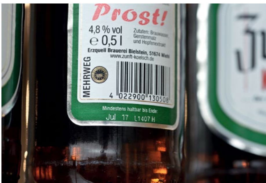
■ Abb. 1: Der Laser trägt die grüne Farbe auf den Zunft-Kölsch Etiketten ab.
