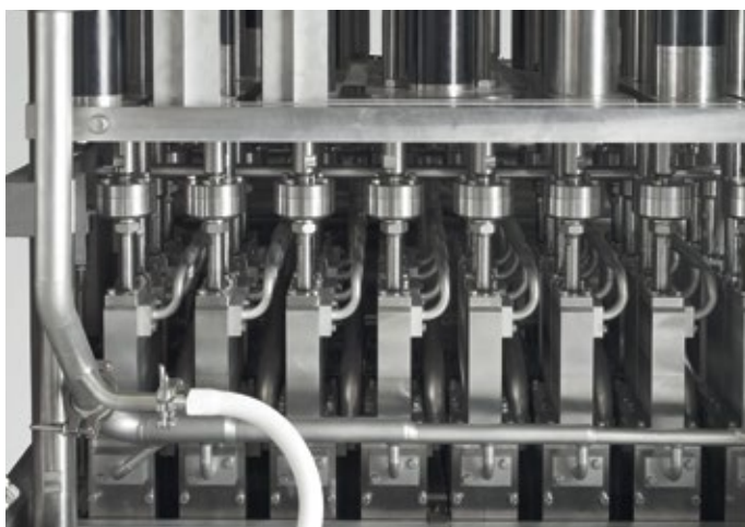
■ Abb. 3: Die produktschonende Abfüllung des Kaffee-Milchmix-Getränks erfolgt an einer Dosierstation mit einem Kolben-Ventil-Doseur.
