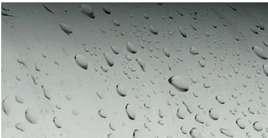
■ Abb.3: Elektropolierte Oberflächen minimieren Anhaftungsmöglichkeiten für Produktreste und erleichtern gleichzeitig das rückstandsfreie Abwaschen und Ablaufen von Reinigungs- und Desinfektionsmittel.
