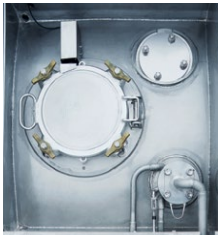
■ Abb.3: Tankcontainer haben sich als Transportmittel für flüssige Produkte fest etabliert. Blick auf den Container-Reinigungsdeckel mit Luftleitung und Reserveflansch.
