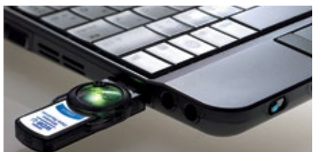
■ Abb. 3: Auch mobil können die Daten des Airgrid empfangen werden – einfach den mobilen Empfänger WDR-U in den Laptop stecken und fertig.
