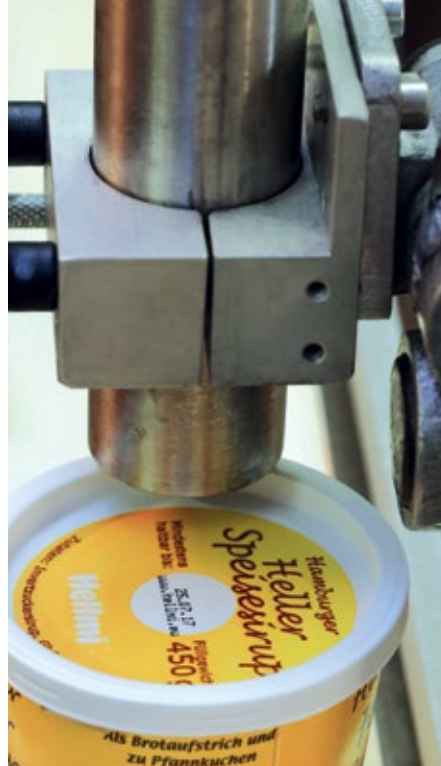
■ Abb. 2: Der versiegelte Druckkopf ist besonders robust.
