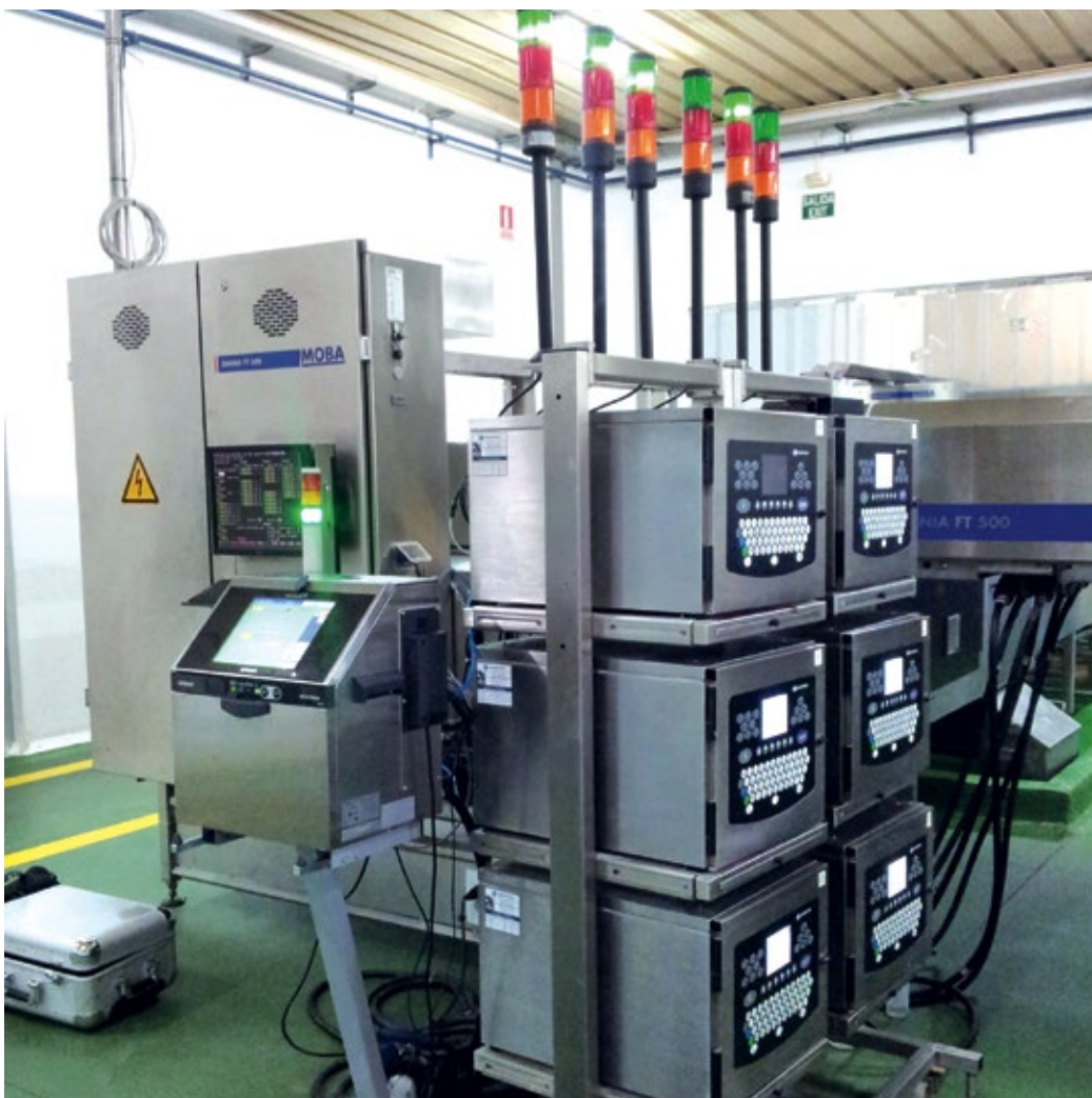
■ Abb. 2: Die Ink Jet Drucksysteme RX-SD sind direkt in den Moba-Anlagen integriert.
