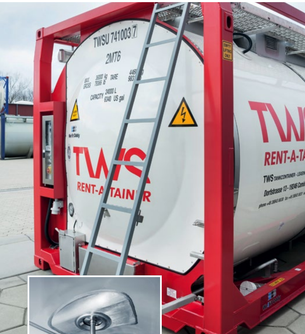
■ Abb. 1: Die Tankcontainer entsprechen hohen Sicherheitsstandards und verfügen über eine ausklappbare Aufstiegsleiter.
