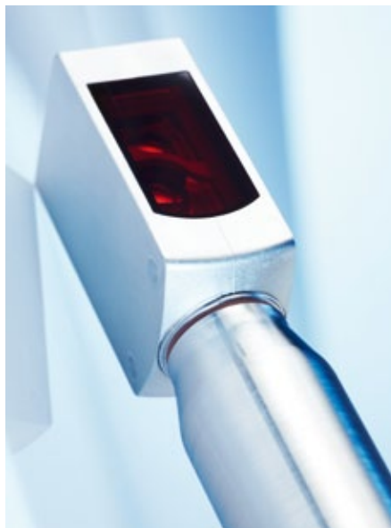
■ Abb. 2: Bei der W4S-3 Inox Hygiene ist die Unterseite der Sensorgehäuse gewölbt, um mittels eines M12-Adaptergewindes oder eines D12-Adapterschaftes eine dichte, EHEDG-konforme Verbindung zwischen dem Sensorgehäuse und der Maschine herzustellen.
