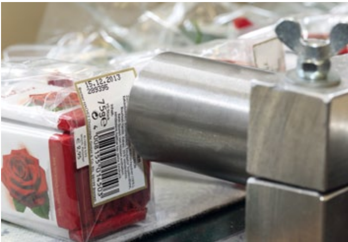
■ Abb. 2: Der Zwei-Zeilen-Codierer Linx 4900 bedruckt die Schokoladen mit MHD und Chargennummer.
