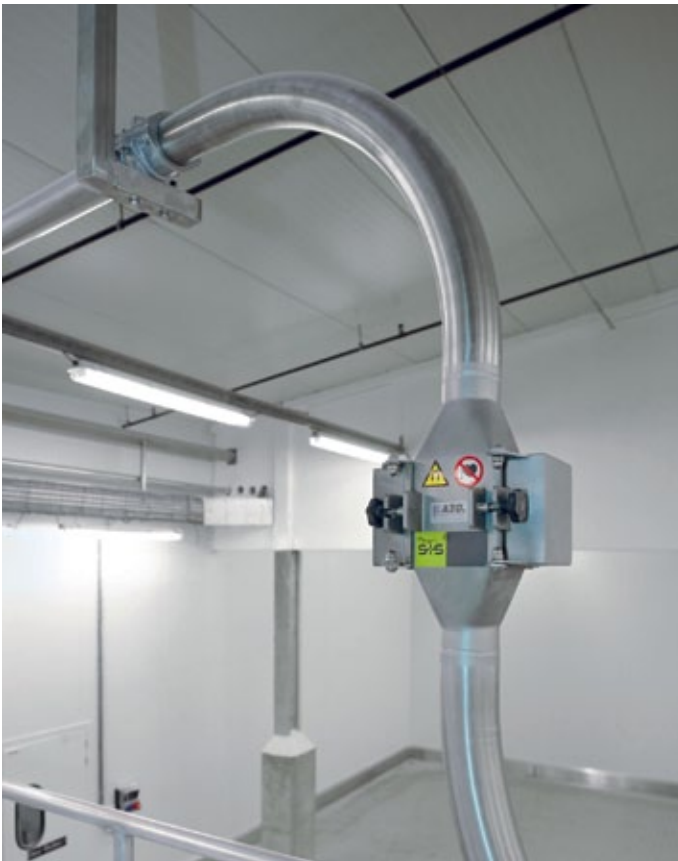
■ Abb. 3: Der Plattenrohrmagnet von S+S separiert magnetische Metalle und ist in eine Rohrleitung mit Druckförderung eingebaut. © AZO
