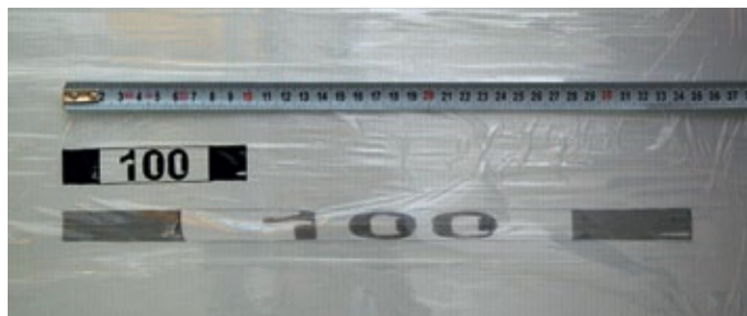
■ Abb. 1: Das Vorrecksystem sorgt für einen reduzierten Folienverbrauch und eine sehr gute Ladeeinheitensicherung. Ein Meter Folie wird z.B. um 250 % auf 3,5 m gedehnt. Voraussetzung: effizienter Anlagen Setup und passende Folie.
