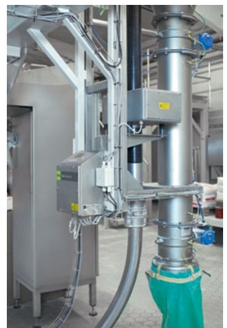
■ Abb. 2: Der S+S Metall-Separator GF 4000 ist in eine pneumatische Förderleitung integriert. © AZO
