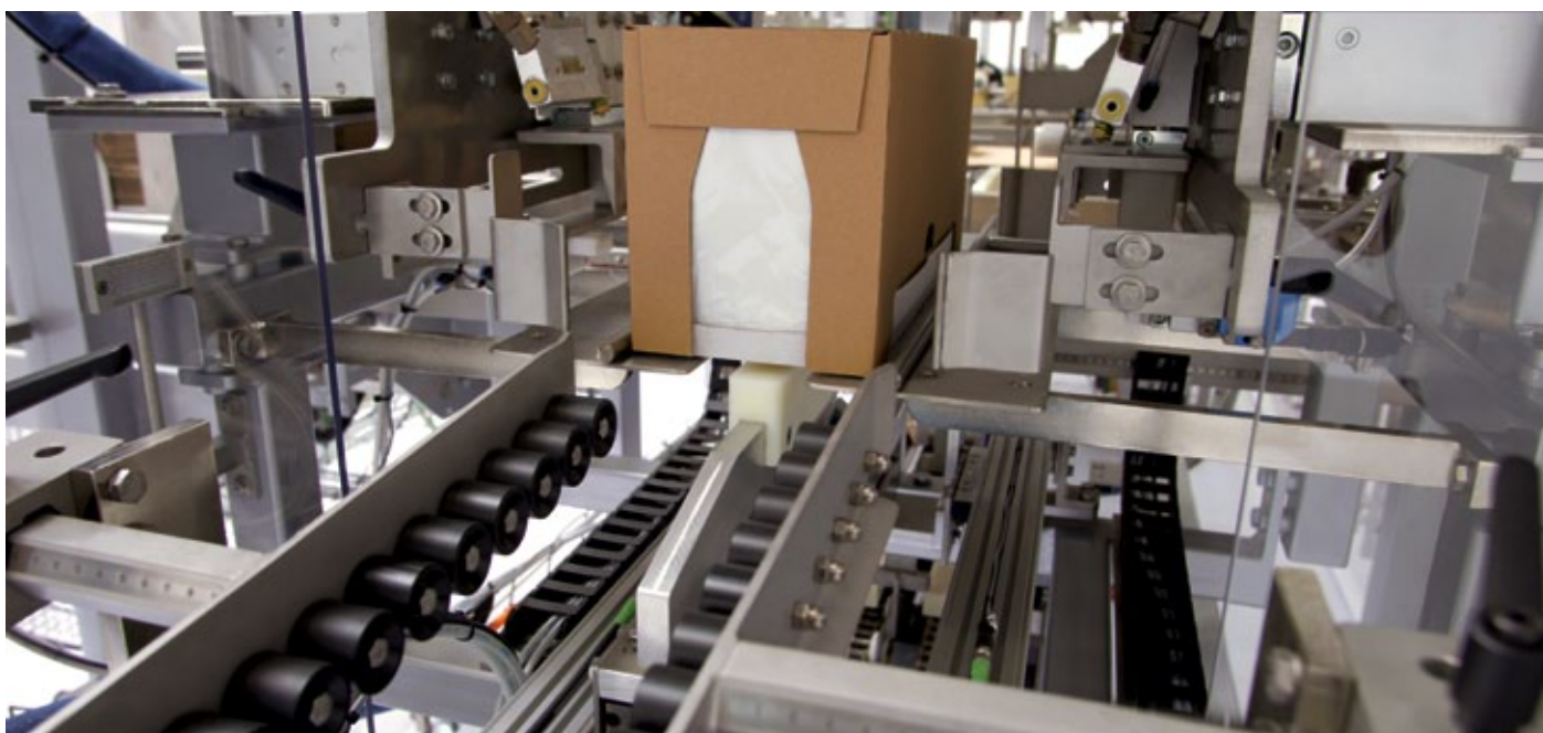
■ Abb. 3: Umlegen, Verleimen und Pressen erfolgt in einem Arbeitsschritt.
