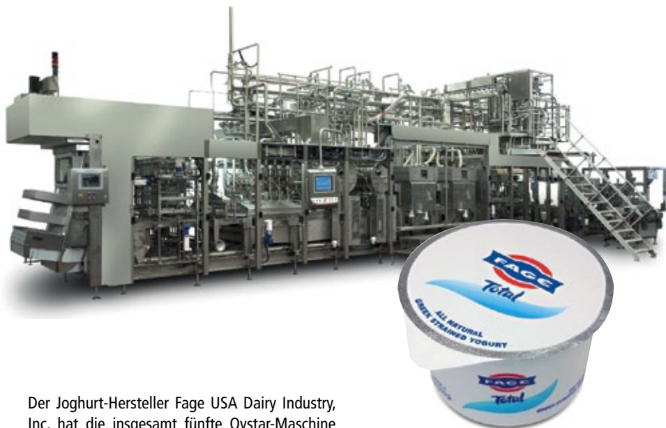
■ Abb.: Gesamtansicht Oyster Hamba Flexline FL 8-8 mit einem typischen Becherformat.
