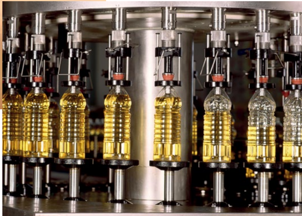
■ Abb. 2: Liegt der Fettanteil der eingesetzten Medien über 30 % wie hier bei der Olivenölabfüllung, so empfiehlt sich der Einsatz des FKM Dichtungswerkstoffes Vi 780.
