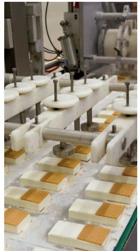
■ Abb. 3: Im Werk Heinsberg von Rosen Eiskrem werden auf zwei Linien zusammen etwa 60.000 Stück Stieleis pro Stunde hergestellt. Gut 400 unterschiedliche Eiskreationen an Stielen, in Waffeln oder Hörnchen und in litergroßen Gebinden produziert Rosen Eiskrem vornehmlich für die Eigenmarken großer Handelsketten.
