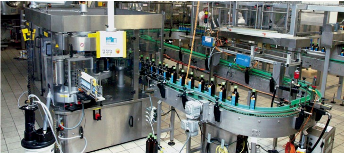
■ Abb. 2: Die „Labetta 4/3/10 640 SA“ von Gernep ist eine raumsparende Kaltleimetikettiermaschine in Rundläuferbauweise. Sie hat zwei Nassleimaggregate, vier Leimpaletten, dreiteilige Greiferelemente und zehn versenkte Flaschenteller. © Gernep und Teutoburger Ölmühle
