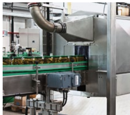
■ Abb. 4: Nach dem Pasteurisieren fahren die Konservengläser in einen Trockentunnel. Hier werden anhaftende Wasserreste abgeblasen, damit sich keine Korrosion auf den Metalldeckeln bilden kann. Für den Vorschub sorgt das mechatronische Antriebssystem Movigear.
