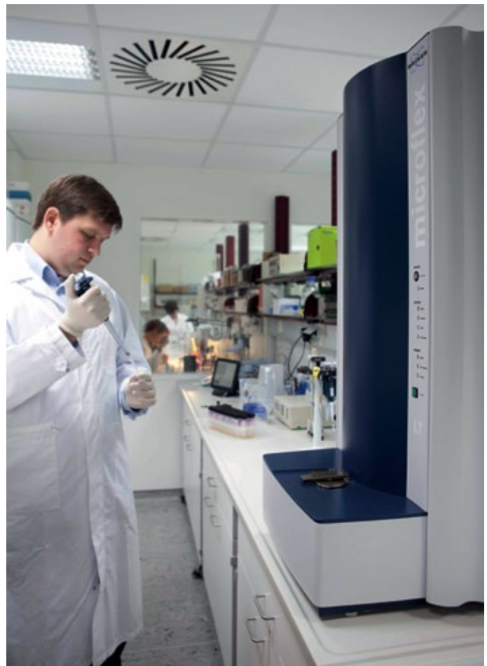
■ Abb. 2: Die MALDI-TOF-MS-Analyse ist genauso zuverlässig wie die DNA-Sequenzierung, jedoch günstiger. Erster Schritt des Verfahrens ist die Gewinnung eines Keimisolats aus Fruchtsaftproben. Im MALDI-TOF-MS-Gerät erfolgt die massenspektrometrische Analyse des Isolats. Deren Ergebnis wird mit den in der MALDI-Biotyper-Datenbank hinterlegten Referenzspektren abgeglichen und die Keime dadurch identifiziert. © Bruker Daltonik
