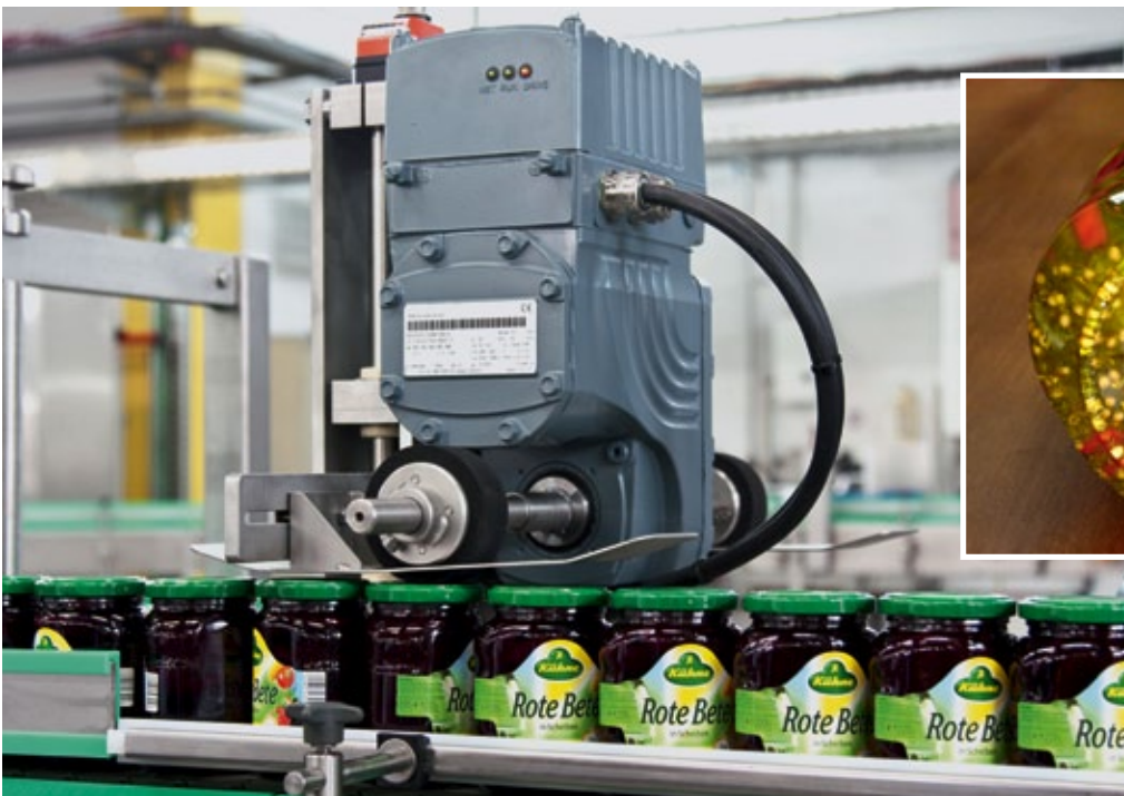
■ Abb. 3: Ein Movigear-Antrieb dreht die Gläser, die die Grundform eines verschliffenen Parallelogramms haben, mit Hilfe eines Gummirads sanft in die richtige Lage. So wird das optimale Lagenbild erzielt und die Verpackungsfläche bestmöglich ausgenutzt.
