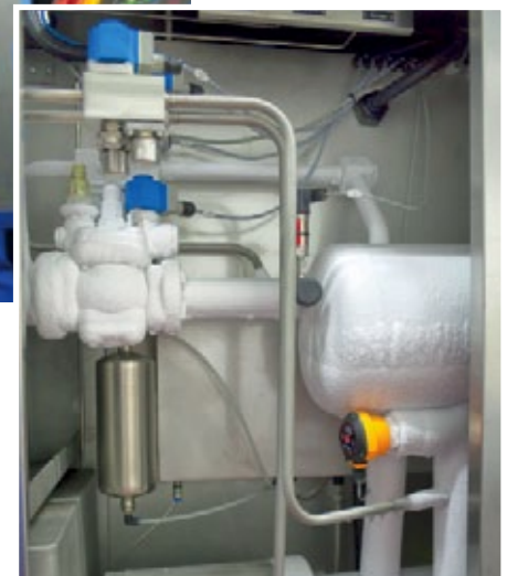
■ Abb. 2: Aufschlag-Punkt: Im Freezer wird die milchflüssige Grundsubstanz heruntergekühlt und mit Druckluft beaufschlagt. Dabei entsteht die cremige Speiseeis-Konsistenz.
