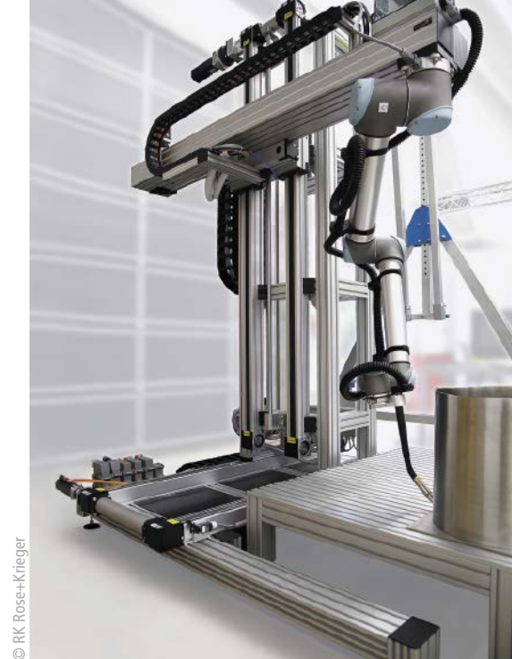
■ Abb. 3: Für ein robotergestütztes Handling- und Bearbeitungsportal kombinierte RK Rose + Krieger vier Linearachsen vom Typ RK Duoline Z 80 Protect, eine rollengeführte Linearachse RK Monoline Z 120 und diverse Aluminiumprofile aus dem Blocan-Baukasten.
