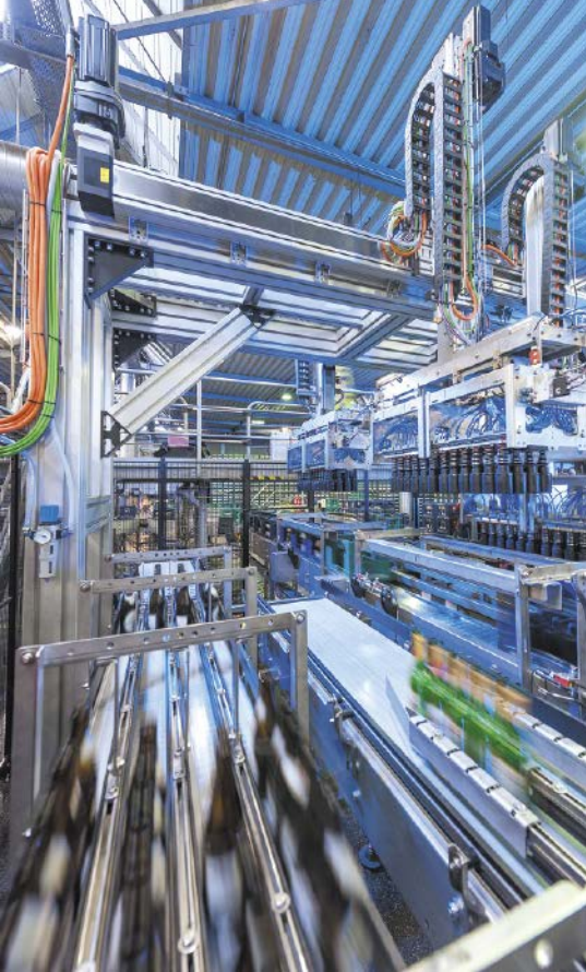
■ Abb. 2: Aus Aluminium-Schwerlastprofilen und Linearachsen vom Typ RK Duoline 160 Z konstruierte RK Rose + Krieger zwei leistungsstarke Handlingportale für eine Leergutsortieranlage.
