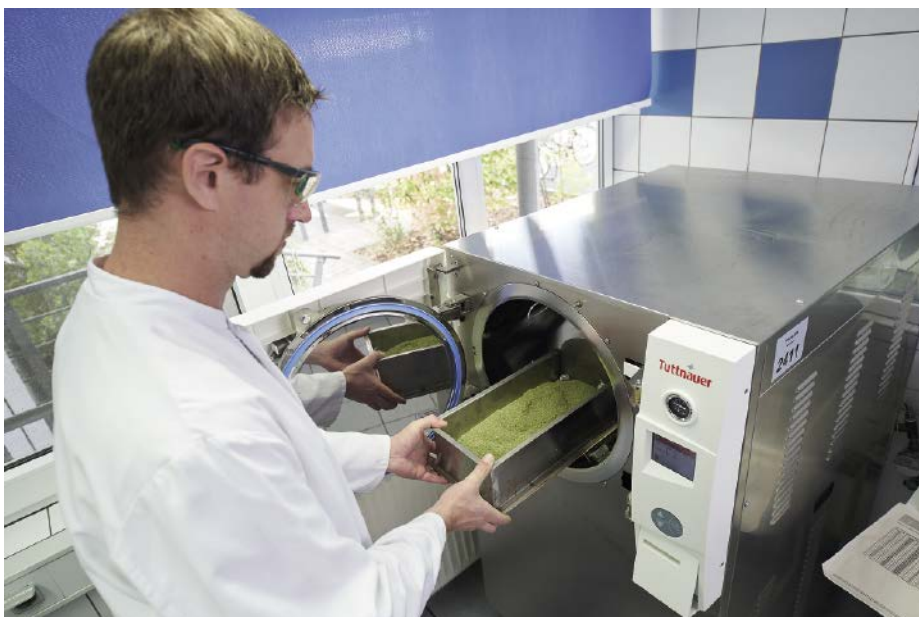
■ Abb. 3: Im Analyselabor lässt sich die Keimreduzierung von Kräutern und Gewürzen zu Versuchszwecken simulieren.
