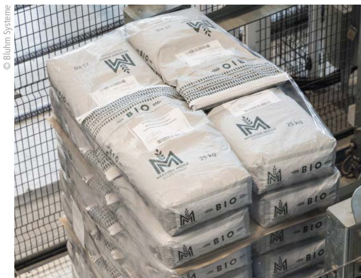
Abb. 1: Seit 1990 ist die Meraner Mühle biozertifiziert. Ihre Absackmaschinen produzieren etwa 900 Säcke pro Stunde, die mit MHD, LOT-Nummern, Artikelbeschreibungen und Verarbeitungshinweisen gekennzeichnet werden.
