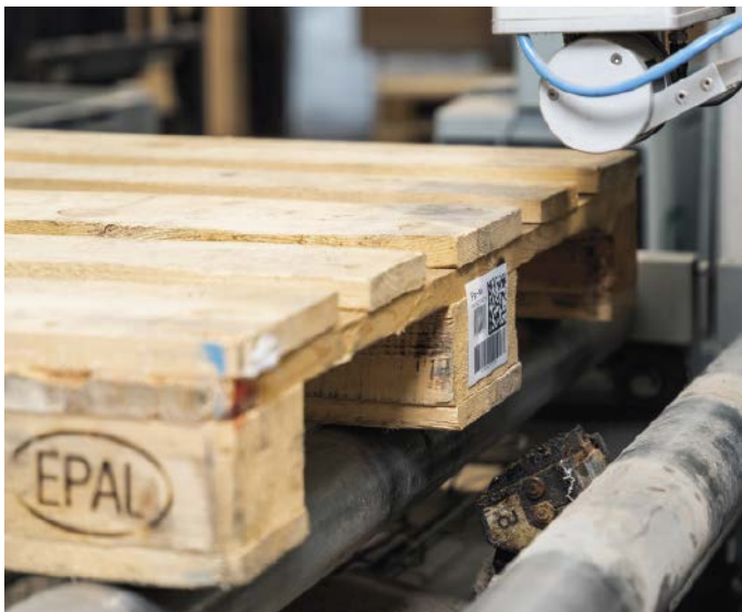
■ Abb. 3: Diese Codes am Palettensockel stammen aus dem Etikettiergerät Typ Legi-Air 4050B-Electrical Swing. Das „All electric-Gerät“ kommt ohne kostenintensive Druckluft aus.
