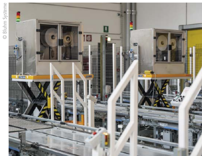
Abb. 2: An der Palettierstation müssen folierte Paletten und Big Bags auf unterschiedlichen Höhen etikettiert werden, daher hat Bluhm Systeme die Palettenetikettierer auf höhenverstellbare Stative montiert.
