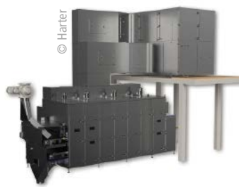
■ Abb. 3: Proteinfreies Weizenextrudat wird zu vegetarischen Bratlingen verarbeitet. Voraussetzung hierfür ist eine homogene Trocknung inklusive Entkeimungsschritt, die über einen Bandrockner realisiert wird.
