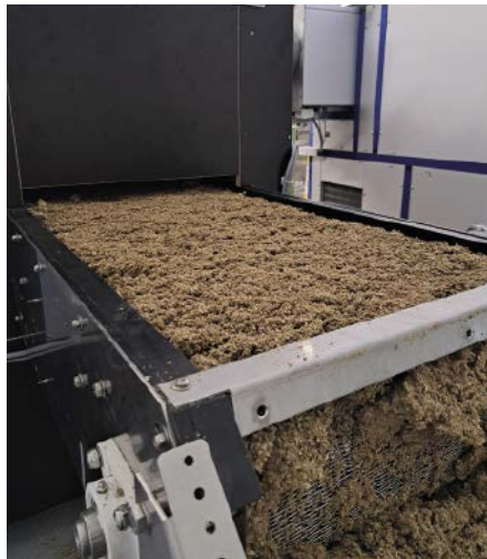
■ Abb. 3: Bei allen Versuchen, hier z. B. mit Biertreber, werden u. a. Parameter wie Schütthöhe, Band- und Luftgeschwindigkeit ermittelt. Sie geben Aufschluss über den optimalen Zeitpunkt für die Fallstufen, deren benötigte Anzahl und damit über das ideale Gesamtkonzept der Trocknerlösung.
