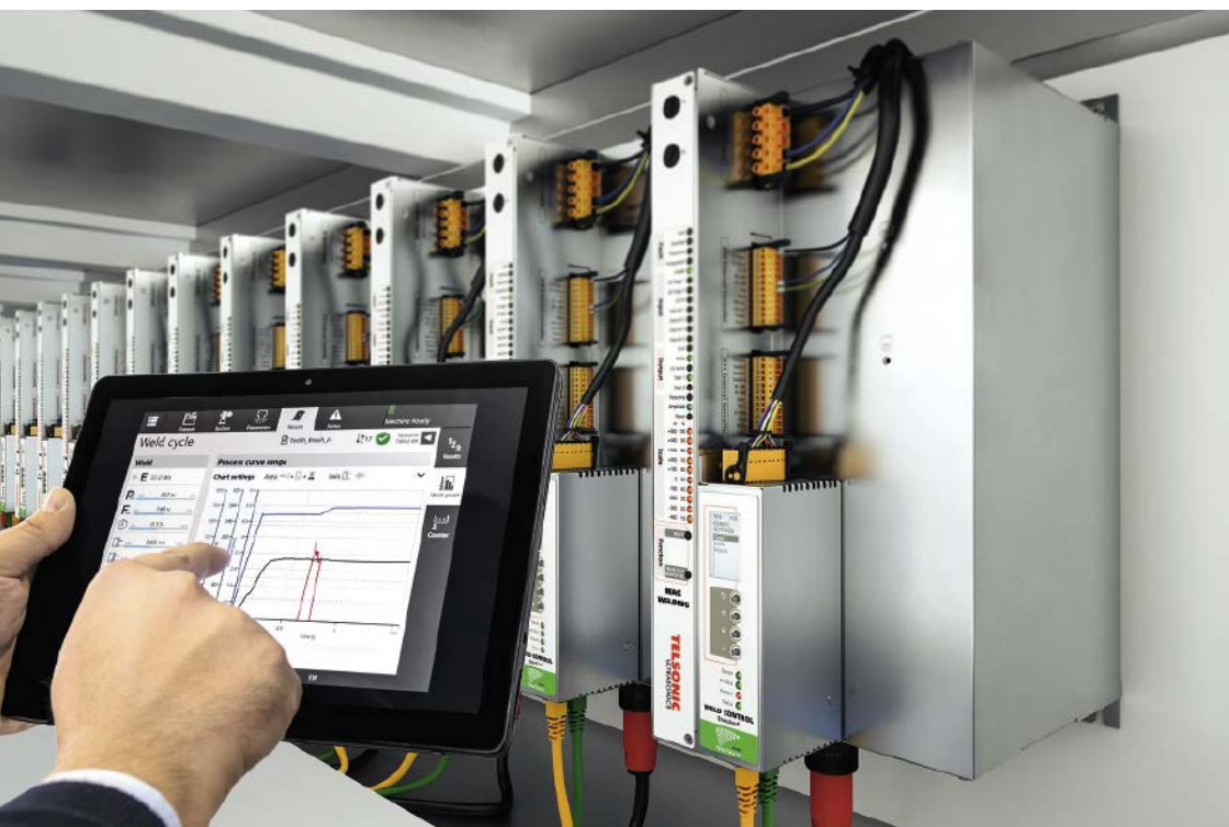
■ Abb. 1: Echtzeitresultate, konstante Leistungsabgabe, Prozesskontrolle über Qualitätsfenster, Industrie-4.0-Kompatibilität und ein hoher Wirkungsgrad kennzeichnen die torsionalen Ultraschallschweißsysteme Soniqtwist.
