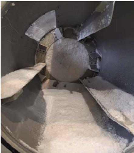
■ Abb. 2: Speisesalz wurde in einer Trommel mit leichter kontinuierlicher Drehung auf < 2 % Restfeuchte homogen getrocknet. Die Trocknungszeit hierfür betrug lediglich 40 Minuten.
