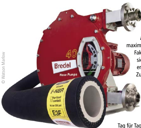
■ Abb. 3: Nur die Innenseite des Schlauchelements berührt das Medium – ideal für abrasive Medien.
