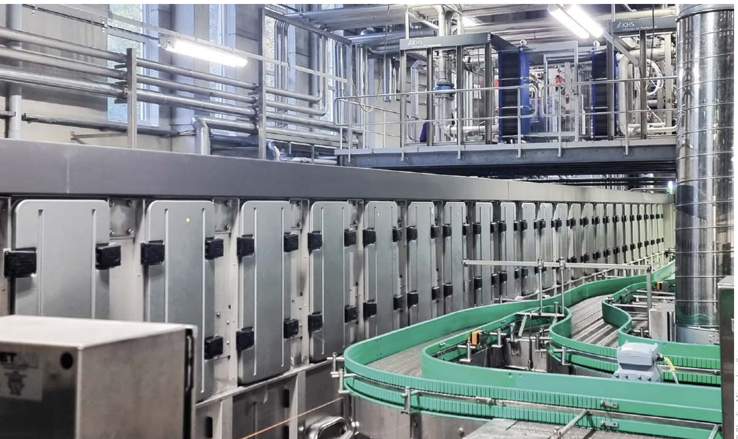
■ Abb. 1: Um Markenprodukte mit höchstem Anspruch zu produzieren, setzt Rhodium auf neueste Technik von KHS – einen hochmodernen Tunnelpasteur.
