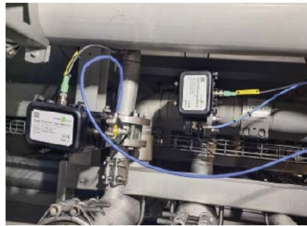
Abb. 2: Im Zusammenspiel mit den anderen Komponenten im Tunnelpasteur sorgen Gleitschieberventile mit IO-Link von Schubert & Salzer für lange Haltbarkeit der Qualitätsprodukte von Rhodius.
