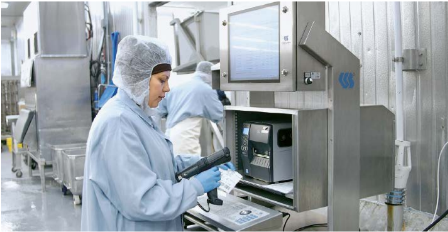
■ Abb. 2: Während des Projekts wurde jeder Rauchwagen an eigens dafür eingerichteten IT-Arbeitsplätzen vor und nach dem Räuchern gewogen und die Gewichte online ins ERP-System übermittelt.
