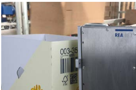
■ Abb. 2: Die neue Kennzeichnungstechnologie REA Jet UP auf Piezo-Basis ist ein Multitalent. UP steht für „Universal Print“ - kontrastreich und zuverlässig auf Papier, Karton oder Holz und auch auf glatten Flächen, wie gestrichenen und veredelten Verpackungen.
