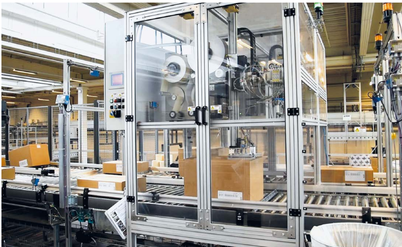
Abb. 1: Der REA Label Servo Etikettierer überzeugt mit hoher Druckqualität und steigert den Automatisierungsgrad auch durch seine Spitzenleistungen in der Spende-Geschwindigkeit von bis zu 2.500 Produkten pro Stunde.
